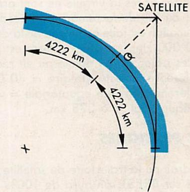
Les satellites RS "arrosent" donc un cercle d'un diamètre d'environ  $(4\,222 \times 2) = 8\,444 \text{ km}$
