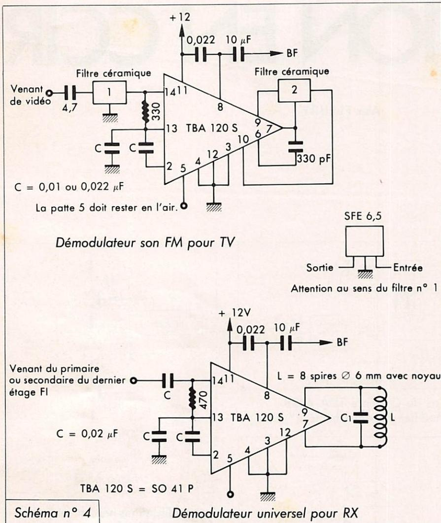
La platine son FM est dessinée de façon à utiliser soit un filtre céramique, soit une self pour le détecteur de coïncidence. Ceci afin d'utiliser aussi ce montage pour d'autres applications, telle la démodulation FM sur un transceiver (bande 29,5 MHz à 29,7 MHz), voir schéma.
