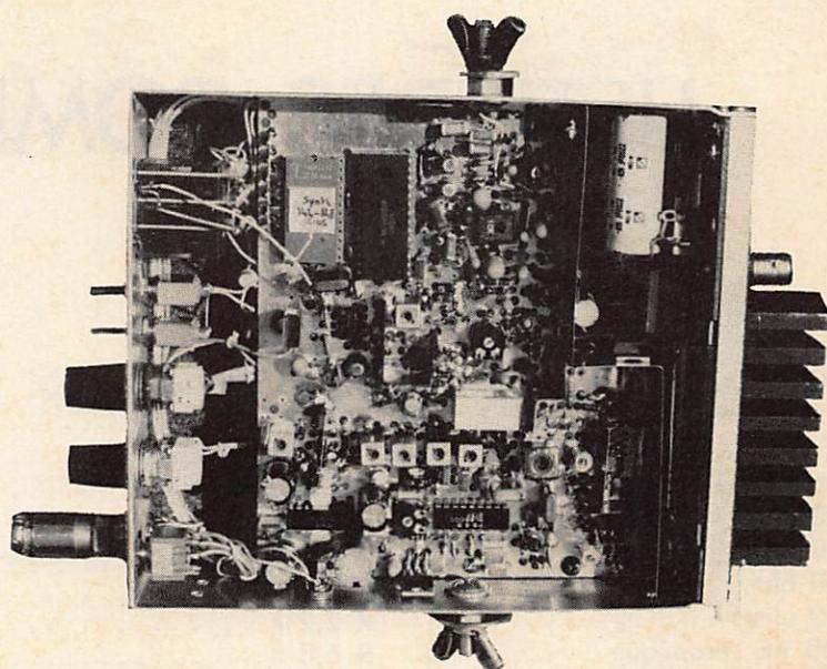
un réglage plus souple du potentiomètre qui est placé sur la face avant, un second potentiomètre est installé en série avec celui-ci et est placé près SL6600 sur le CI. La commutation est réalisée au plus simple avec un transistor de commutation placé sur la BF. Une capacité de  $3,3 \mu\text{F}$  sur la patte 7 du SL6600 fixe la constante de temps. Au besoin, celle-ci pourra être ajustée.
