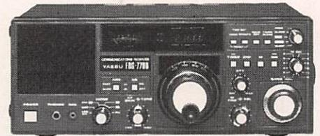
**FRG 7700** - Récepteur à couverture générale de 150 kHz à 30 MHz, AM / FM / SSB / CW, affichage digital, alimentation 220 V, 12 mémoires. En option: 12 V.
