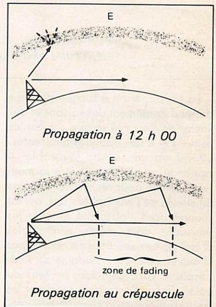
A grande distance, les Ondes Moyennes empruntent le chemin le plus court et pour traverser l'Atlantique elle suivent une Orthodromie. Pour observer ces routes il est nécessaire de se munir d'un globe terrestre et d'un petit fil pour relier les deux points visés. L'usage de la planisphère est déconseillé pour les confusions et les erreurs qu'elle occasionne.
