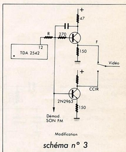
Ces modifications nécessitent l'emploi de petits relais alimentés en 12 volts par un interrupteur que l'on pourra ajouter sur la face arrière du téléviseur. Ce, ou ces relais seront placés le plus près possible du circuit intégré vidéo et serviront aussi à la commutation de la BF.
