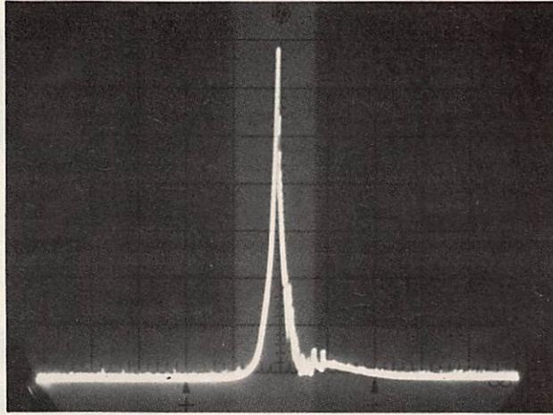
Représentation spectrale de la porteuse  $H = 1 \text{ MHz / cm}$
