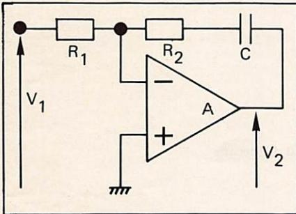
A peut-être un amplificateur opérationnel (BF) ou simplement un transistor (HF) monté en émetteur commun.
