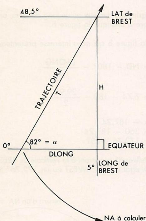
L'angle orbital des satellites RS est de  $82^\circ = \alpha$ .
