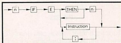
La machine va commencer par évaluer E qui sera une expression booléenne. Si E est fautive, alors la machine exécutera l'instruction suivante en séquence. Si E est vraie, la machine pourra se brancher au numéro de ligne  $n_1$  et exécuter à partir de ce numéro les instructions de la suite du programme, et cela en séquence. Si E est vraie, elle pourra également exécuter la ou les instructions situées après le THEN.
