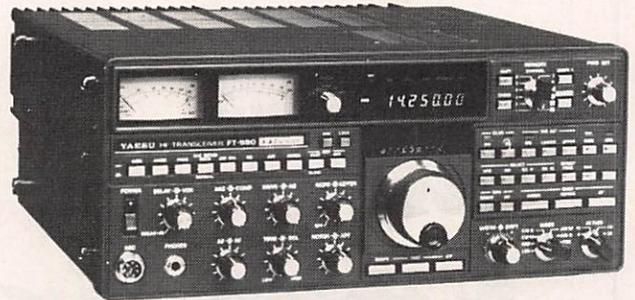
**FT 980** - Récepteur 150 kHz à 30 MHz. Emetteur bandes amateurs, tous modes AM / FM / SSB / CW / FSK, 120 W HF, tout transistor. Option interface de télécommande par ordinateur (Apple II).
