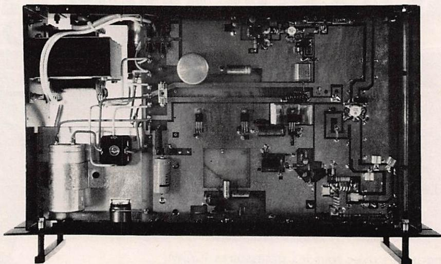
l'intérieur du boîtier. Ce module reçoit la modulation à travers un circuit éleveur d'impédance avec préaccentuation des aigües commutable. Les 100 milliwatts seront amplifiés par les deux drivers qui ont un gain maximum de 20 dB et fournissent donc 10 Watts au P.A. Celui-ci est équipé d'un transistor auto-protégé à haute fiabilité avec préadaptation interne assurant une
