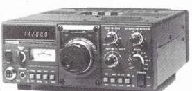
Tout transistor. USB/LSB/CW/FSK 100 W HF CW - 200 W PEP 3.5 · 7 · 10 · 14 · 18 · 21 · 24.5 · 28 MHz, 12 volts.
