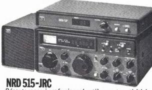
Récepteur semi-professionnel entièrement synthétisé. Couverture de 100 kHz à 30 MHz en 30 gammes. AM/BLU/CW/RTTY.
