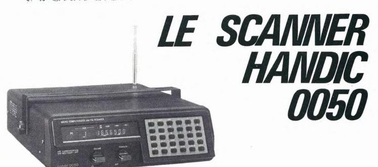
Le scanner HANDIC 0050 appartient à la troisième génération de récepteurs VHF-UFH à balayage de fréquence automatique. Il est le successeur des modèles 0012 et 0016 de la marque. Sa gestion par microprocesseur ainsi que l'étendue des gammes couvertes en font le plus performant de la gamme.
