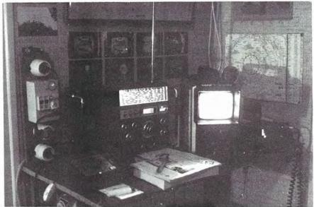
STATION DE RECEPTION – A gauche : boitier de commande du rotor – Au centre: récepteur radio GRUNDIG – TV Multistandards – A droite : récepteur 144 MHz
