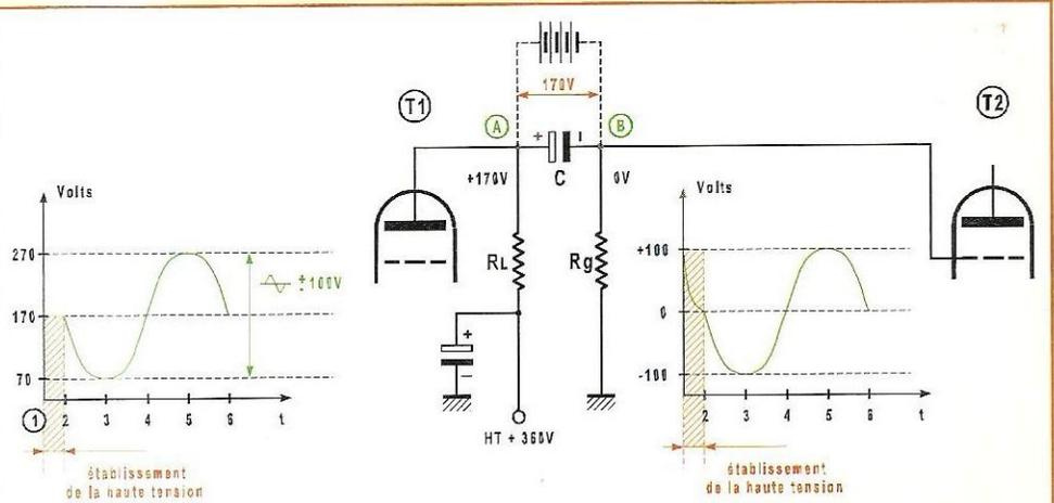
**Figure 1 : Analyse d'un couplage RC imaginaire.** La tension au point (A) varie de  $\pm 100$  V lorsque le tube T1 est excité. Cette variation de tension est transmise par C en (B) sans atténuation, à condition que la constante de temps  $T = R \times C$  soit très supérieure à la période la plus basse de la fréquence à transmettre. C se comporte alors comme une batterie chargée en opposition à la tension présente au point (A), ici 170 V
