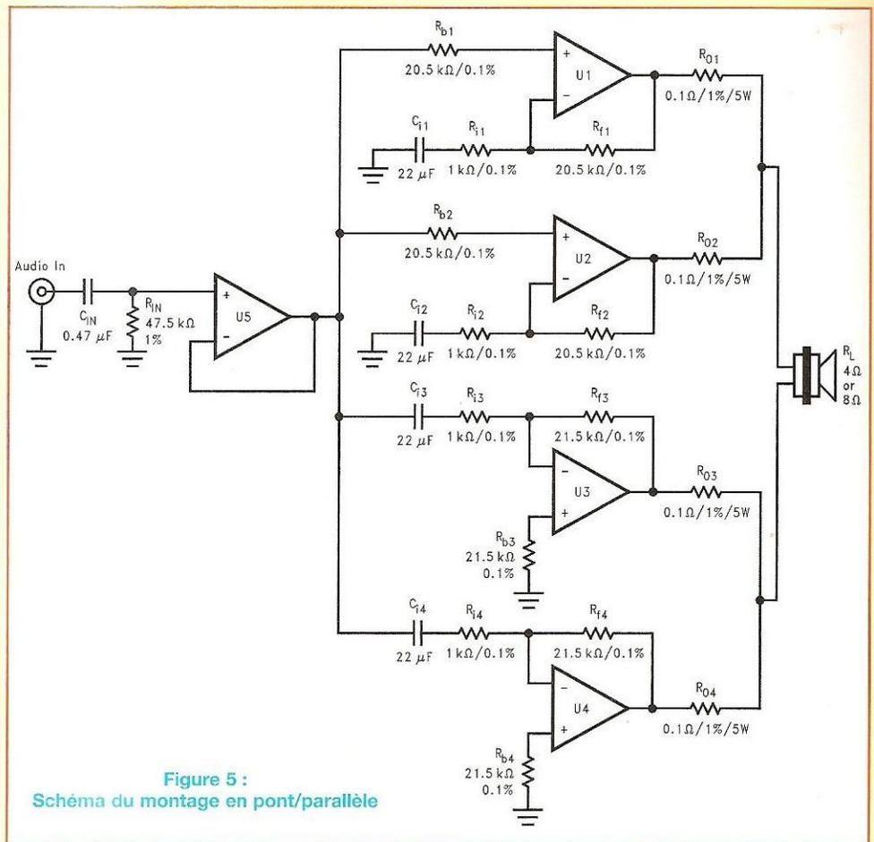
Figure 5 : Schéma du montage en pont/parallèle
