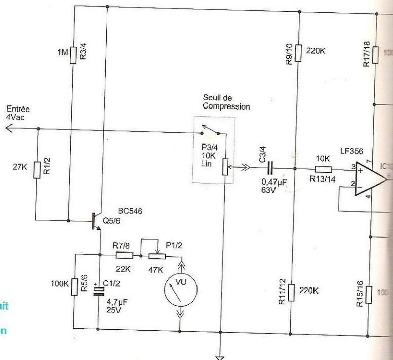
Figure 5 : Circuit amplificateur de compression
