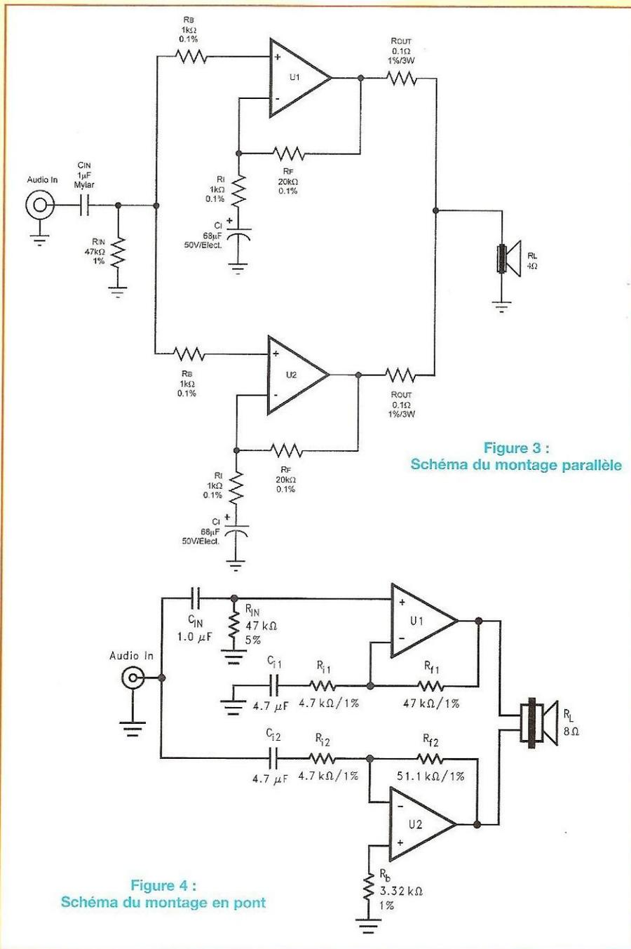
Figure 3 : Schéma du montage parallèle
