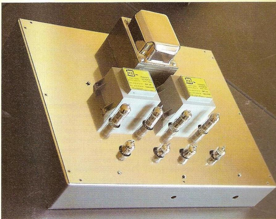
Photo C : Amplificateur 2 x 10 W utilisant un châssis Tub'Ox
