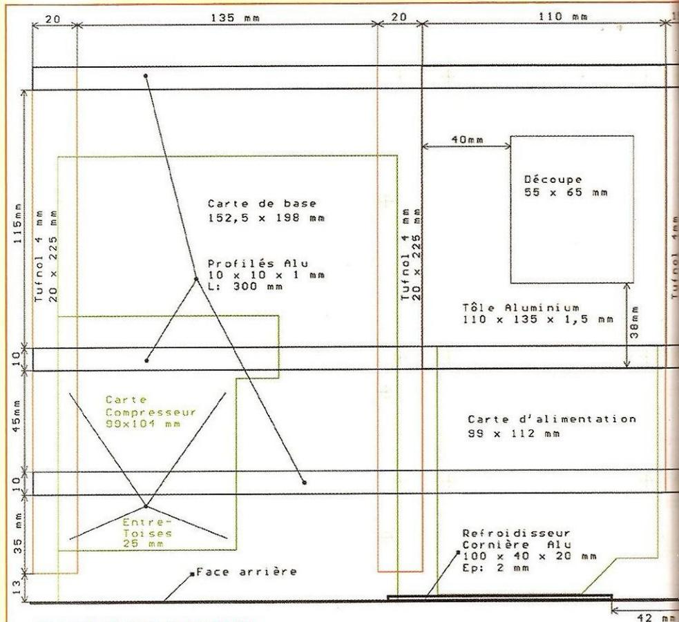
Figure 7 : Châssis intermédiaire
