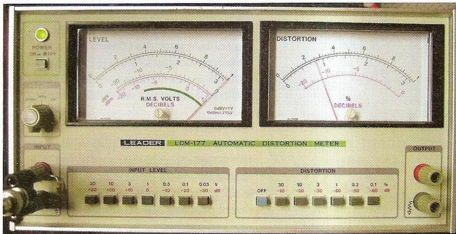
Photo L : Mesures DHT: 0,026 % à 1 Vac 1 kHz
