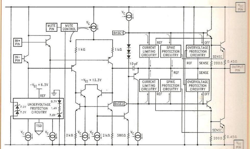
Figure 2 : Schéma de protection interne du LM 3886
