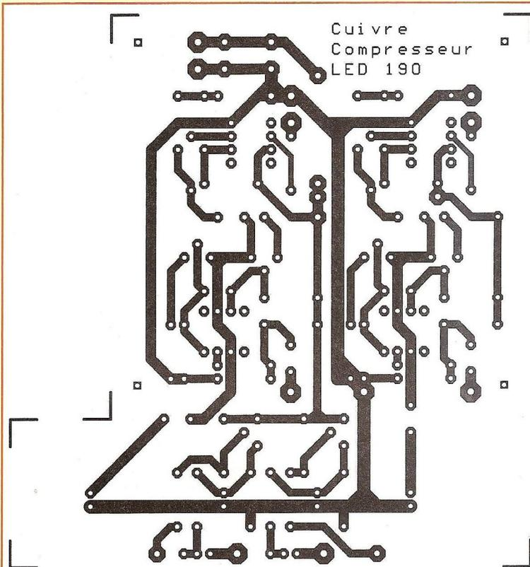
Figure 17 : Carte de compression. Circuit imprimé
