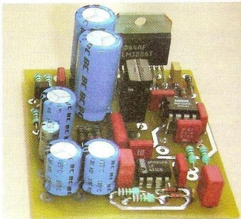
Pour moins de 10 €, le LM3886 est capable de délivrer une puissance de 60 Weff dans une charge de 4 Ω et 50 Weff dans 8 Ω. De surcroît, il présente des qualités audio incontestables, cela pour une bande passante très étendue. Le module que nous vous présentons est à entrée symétrique et le montage se voit doté d'un circuit « servo » qui contrôle et régule la tension continue d'offset en sortie afin de la maintenir au plus près du 0 V.
