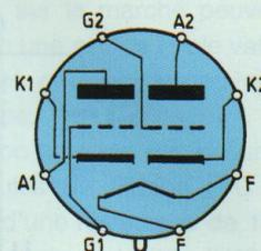
Figure 1 : Brochage des tubes 6SL7 et 6SN7
