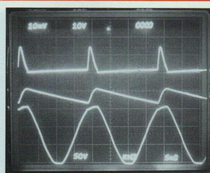
Figure 3 : Oscillogramme correspondant au schéma de la figure 1 (simple alternance).
