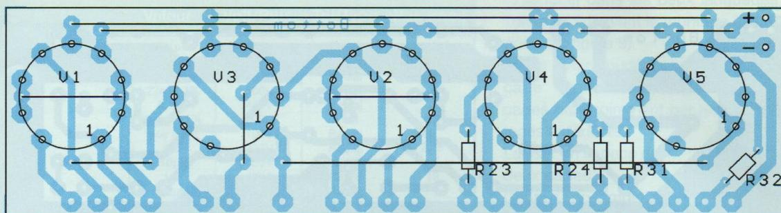
haute tension. Mais une résistance (R86) MF à 1 % de 0,66 W sera plus fiable. Dans le prototype, nous avons utilisé une 56 k $\Omega$ . La self de filtrage est fixée par deux vis M4 sur la carte même. Toutes les connexions se font par cosses et picots de 1,3 mm, la carte est ainsi libre de fils. Tous les fils de liaisons sont torsadés « serrés » afin de réduire au minimum leur rayonnement.
