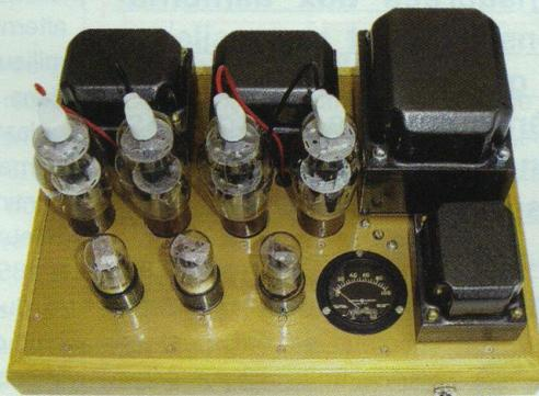
Dans la série d'amplificateurs à tubes parue dans *Led* ces dernières années, quelques lampes restent encore un peu dans l'ombre. C'est le cas, par exemple, de la tétrode 807 qui nous intéresse aujourd'hui. Cette tétrode était utilisée sur des amplificateurs connus, en particulier sur l'amplificateur de Williamson dans sa première version. Citons également la société Bouyer dont on disait volontiers à l'époque que ses amplificateurs étaient « increvables ».
