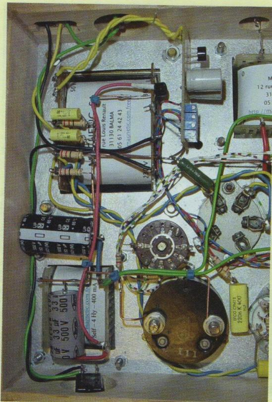
Photo E : La masse (fil de cuivre émaillé de 10/10<sup>e</sup>) part du (-) du pont redresseur, passe près de la self de filtrage et vient se souder sur une cosse non utilisée de celle-ci
