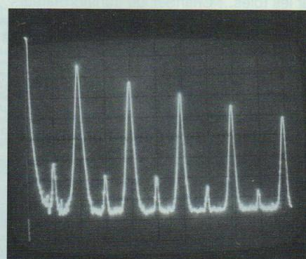
Figure 6 : Spectre de la tension redressée à 100 Hz
