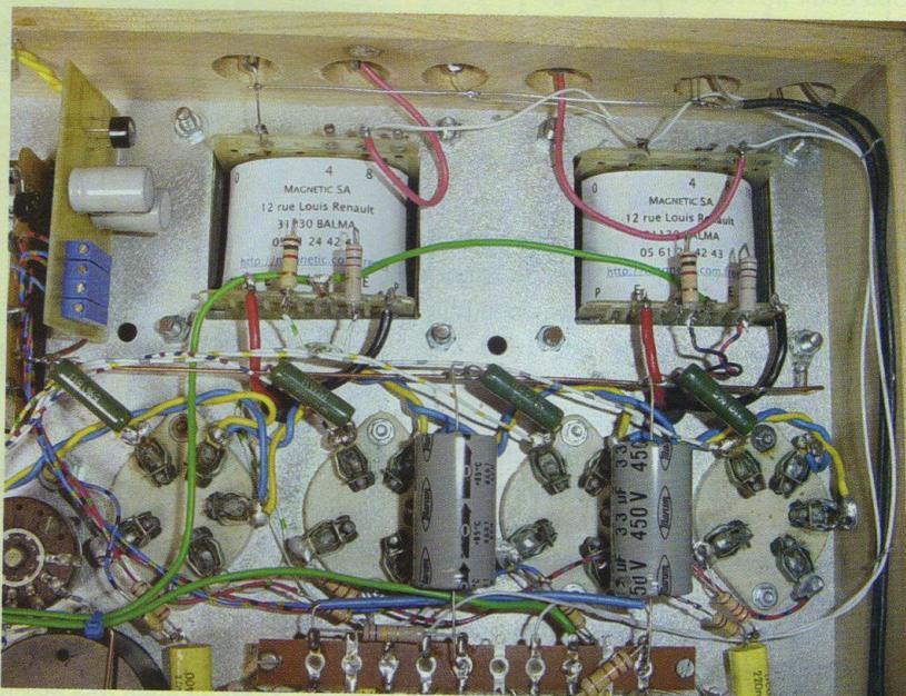
et vient se souder sur une cosse non utilisée de celle-ci (**photo E**). Elle reçoit les bornes négatives des deux condensateurs de filtrage HT. Elle part ensuite à l'opposé du châssis pour câbler les deux condensateurs de filtrage du tube d'entrée et des déphaseurs, ainsi que les résistances de cathodes des 807 (**photo F**).
