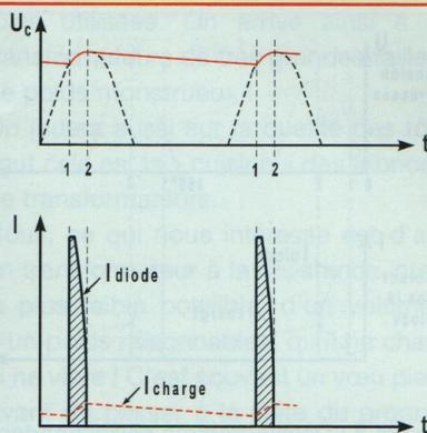
Figure 4 : Installation d'un condensateur de 330  $\mu\text{F}$  à la place du condensateur de 20  $\mu\text{F}$  de la figure 3. Attention : l'échelle de la tension redressée a changé (1 V/carreau au lieu de 10 V/carreau). Condensateur C : 330  $\mu\text{F}$ . R charge : 6,8 k $\Omega$ .  $U_c = 70$  V. Ondulation  $\approx 0,8$  V (1 %). Courant dans la charge :  $70/6800 = 10,2$  mA. Courant impulsionnel : 220 mA.
