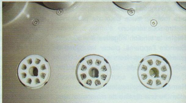
se tromper sur la position des encoches des supports des tubes d'entrée. Vu du côté circuit imprimé, les encoches sont à 135° (photo J).
