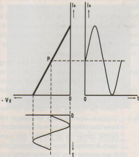
Figure 1 : Courbe de transfert « idéalisée », telle qu'elle serait tracée d'après un réseau lui aussi « idéalisé ». La sinusoïde inférieure appliquée sur la grille (axe  $V_g$ ) serait amplifiée avec un taux de distorsion nul : le rêve ! (sinusoïde supérieure). L'axe  $Ot$  représente le temps car il s'agit d'un signal périodique
