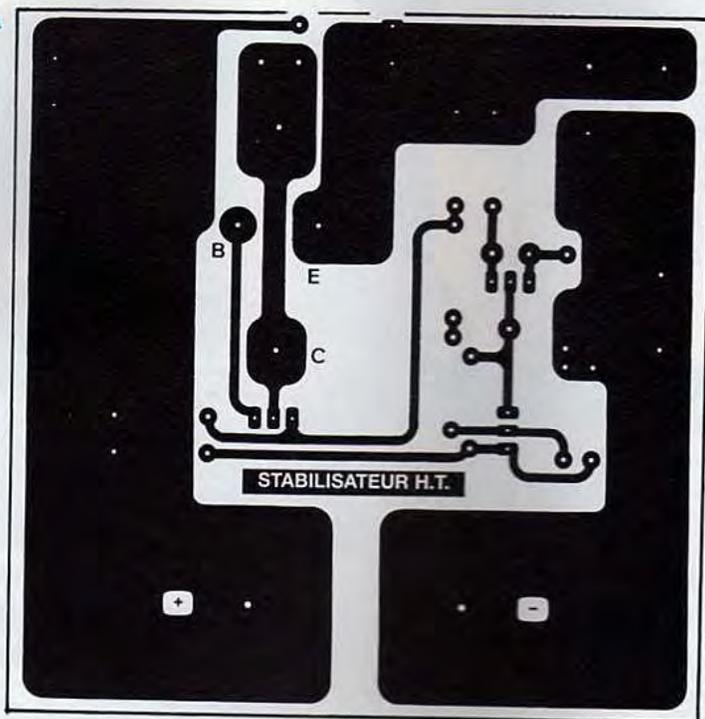
La haute tension redressée-filtrée appliquée au point milieu du primaire du transformateur de sortie est ensuite régulée de façon à obtenir une excellente tension stabilisée destinée aux étages d'entrée qui sont très sensibles au bruit, surtout l'EF86.
