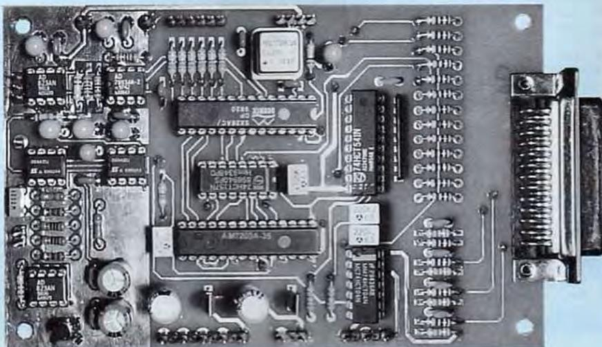
Les caméras Kitty-255 et Kitty-237 seront enfin dotées d'une résolution confortable avec l'interface 12 bits. Le pilotage du capteur CCD est effectué intégralement par le microcontrôleur SX28 implanté sur la carte, ce qui permet notamment d'éviter les perturbations inhérentes aux interruptions intempestives du PC.
