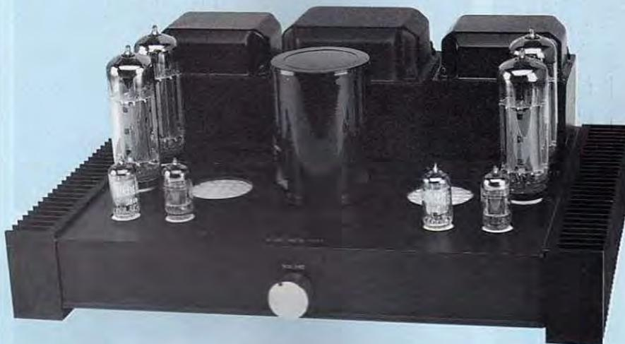
Pour rester dans des puissances confortables nous allons nous intéresser à la réalisation d'un amplificateur stéréophonique utilisant cette fois-ci des tétrodes KT88 ou des pentodes KT90. Ces tubes sont réputés pour leur robustesse et équipent des produits de marques aussi prestigieuses que Mc Intosh ou Jadis.
