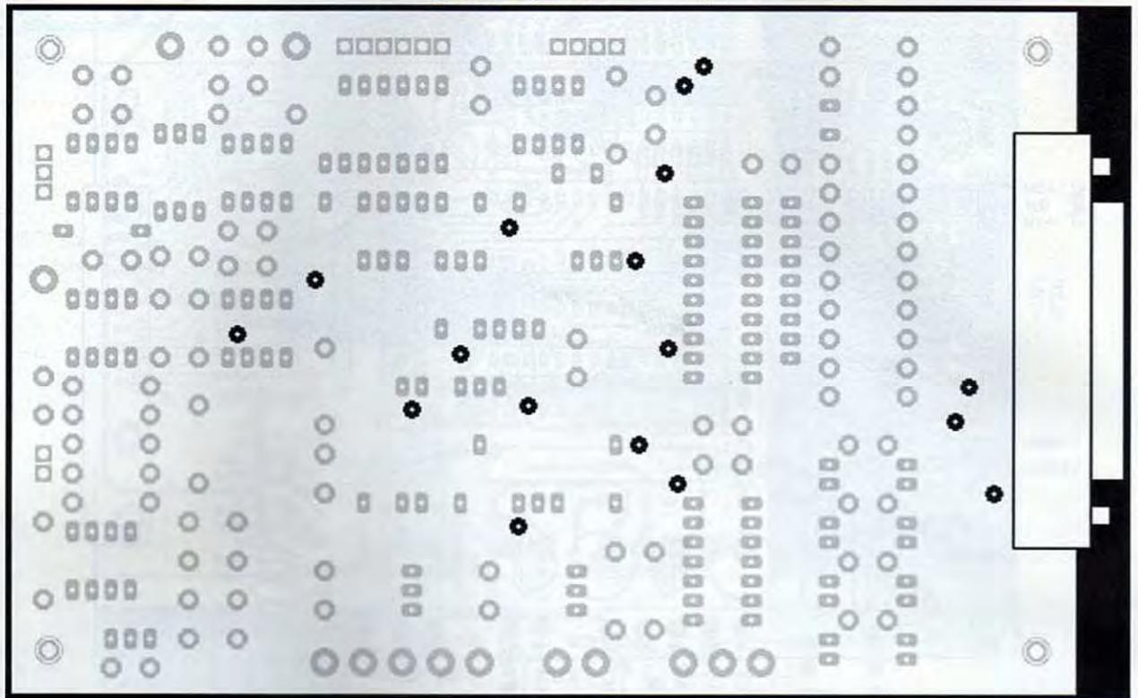
straps de liaison entre les deux faces, il y en a 17 au total. Le plan d'implantation de la figure 12 indique la position de tous les straps. D'ailleurs, il est conseillé de placer en premier les straps situés sous IC5, IC6 et IC7, car ils seraient difficiles à atteindre après la mise en place des supports (on peut utiliser des pattes de résistances pour réaliser les straps).
