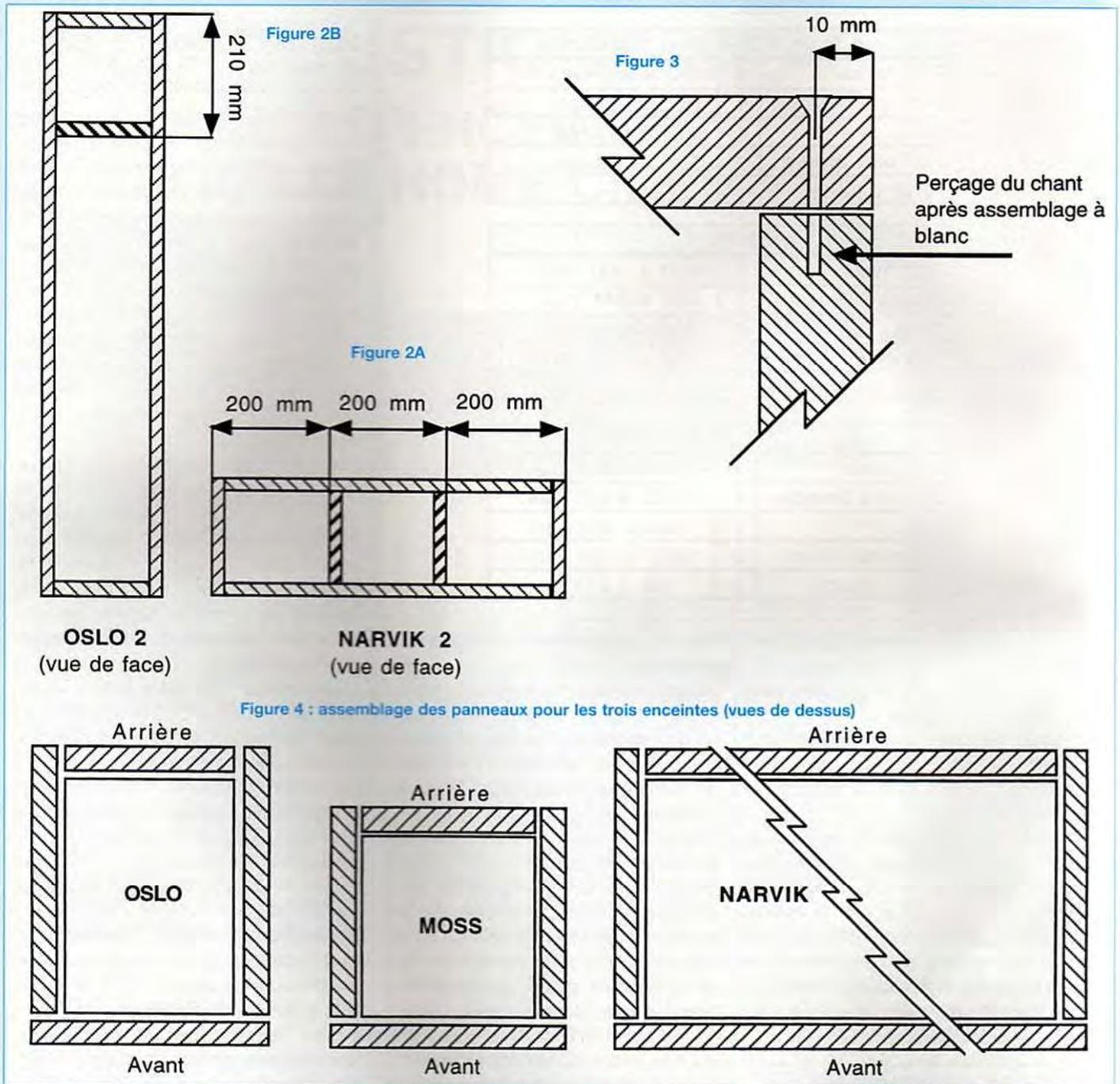
neau (Figure 3). Pour les enceintes Oslo et Narvik, percer un trou de 10 mm au centre des panneaux internes (ces trous permettront le passage des câbles de liaisons).
