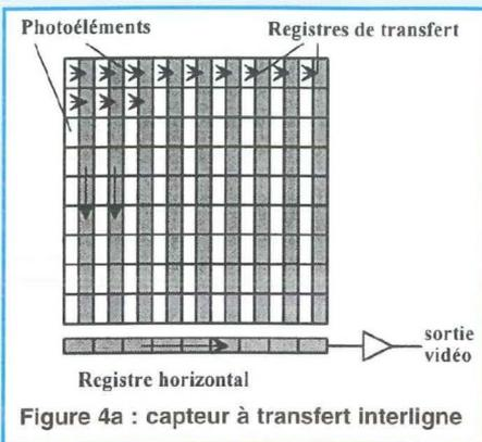
Figure 4a : capteur à transfert interligne
