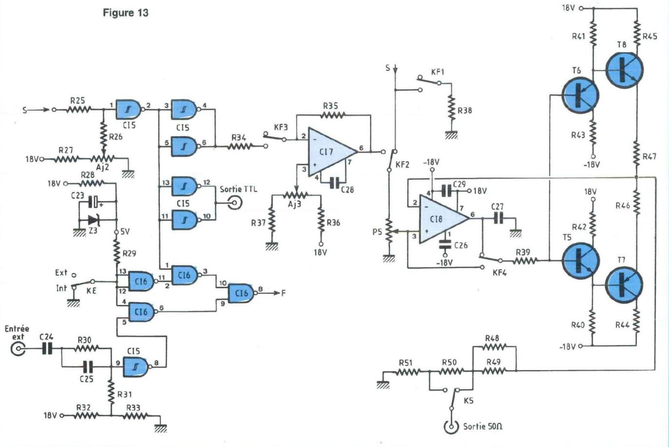
suffisante dans la plupart des cas. L'inverseur simple KE sélectionne la mesure interne ou externe (en position interne sur la figure), F étant la sortie envoyée au fréquencemètre.
