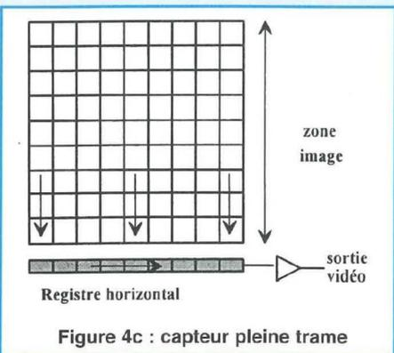
Figure 4c : capteur pleine trame
