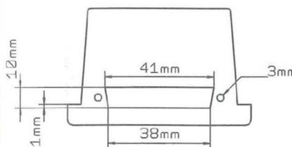
Remarque importante: le perçage destiné au connecteur doit être réalisé sur le côté qui comporte des trous de fixation distants de 57mm. En effet, les deux autres logements ne sont pas positionnés de façon identique !
