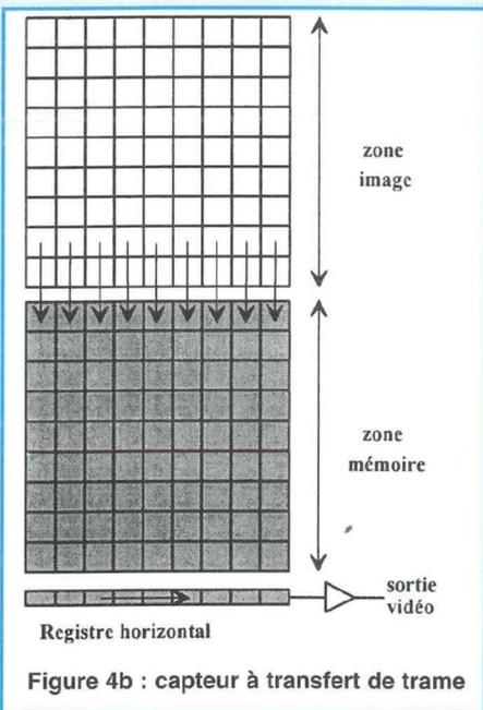
Figure 4b : capteur à transfert de trame
