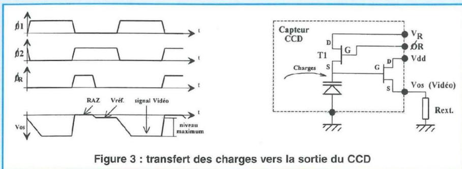
Figure 3 : transfert des charges vers la sortie du CCD
