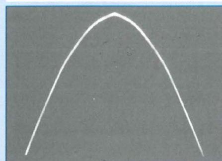
Photo 3 : sommet de la sinusoïde du générateur commercial d'amplitude 10 V à 1 kHz 1 V/div ; 50 µs/div
