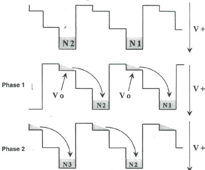
Figure 2 : mécanisme de transfert des charges
