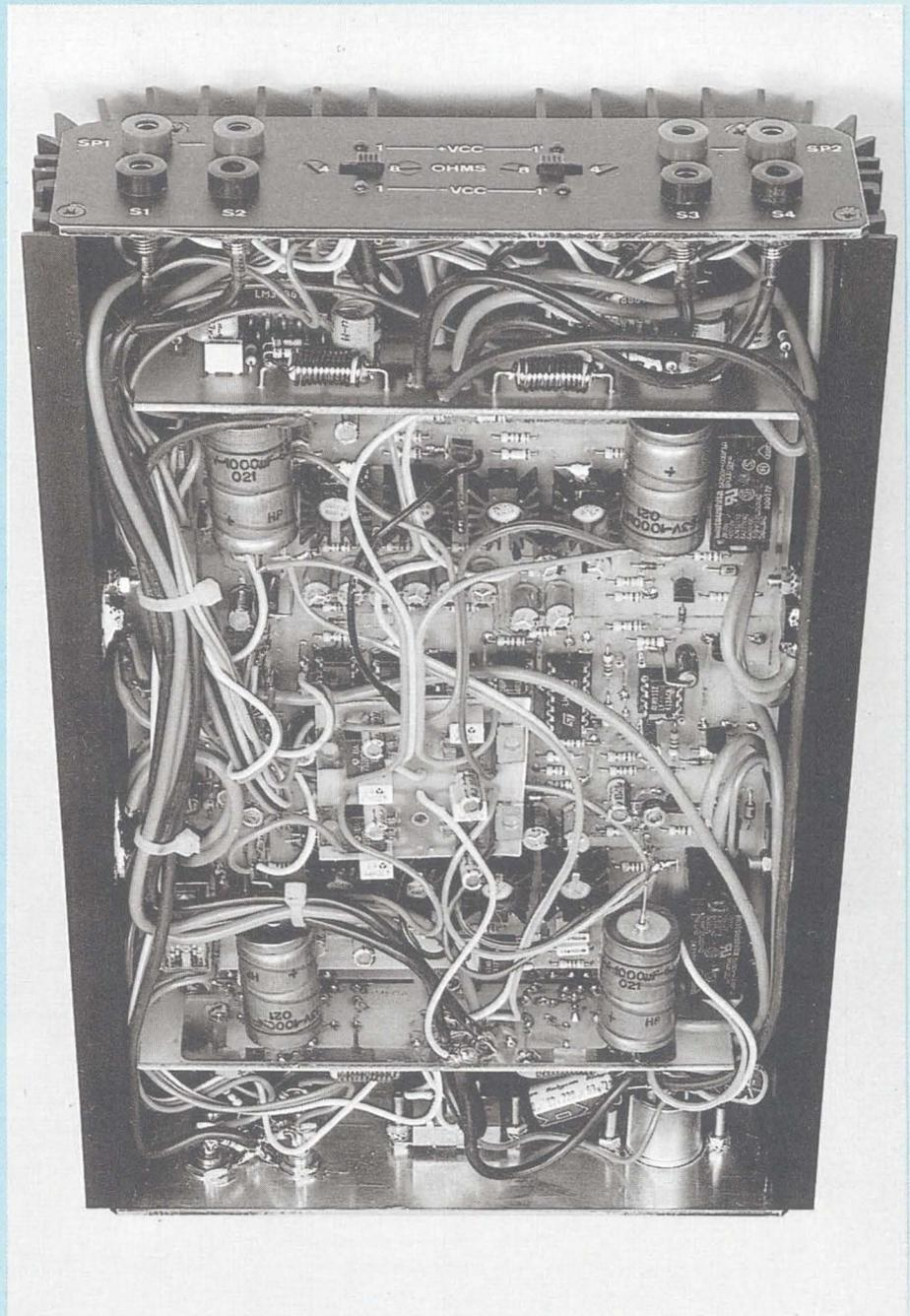
l'ohmmètre la bonne séparation électrique entre le refroidisseur et les différents boîtiers. Pour les modules de puissance, il n'y a pas de problème. En revanche, la semelle des TO 220 étant inaccessible, on prendra la broche du milieu (le drain) comme point de contrôle car celle-ci
