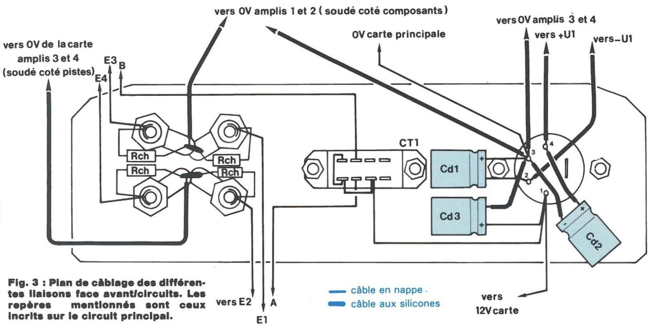
Fig. 3 : Plan de câblage des différentes liaisons face avant/circuits. Les repères mentionnés sont ceux inscrits sur le circuit principal.
