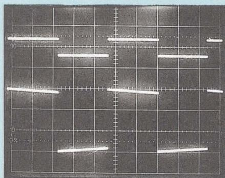
(c) Non ponté  $8 \Omega$  à 40 Hz.
