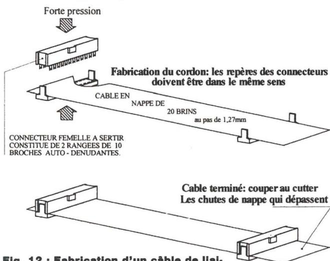
Fig. 12 : Fabrication d'un câble de liaison HE10 - 20 broches.
