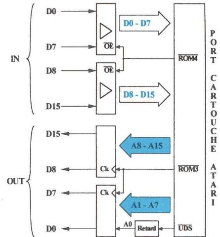
Fig. 6 : Exemple de réalisation d'une interface 16 bits bidirectionnelle.
