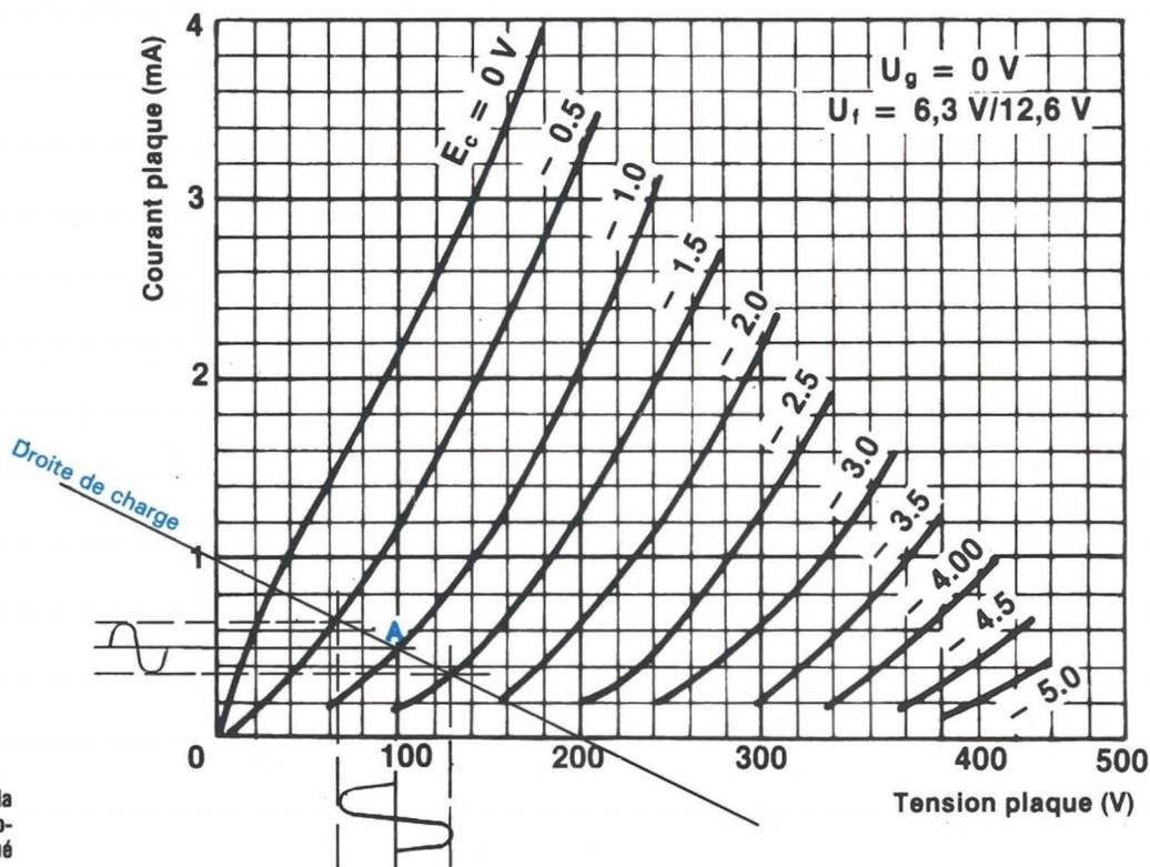
Le signal prélevé aux bornes de la résistance de plaque Rp est en opposition de phase avec celui appliqué sur la grille.
