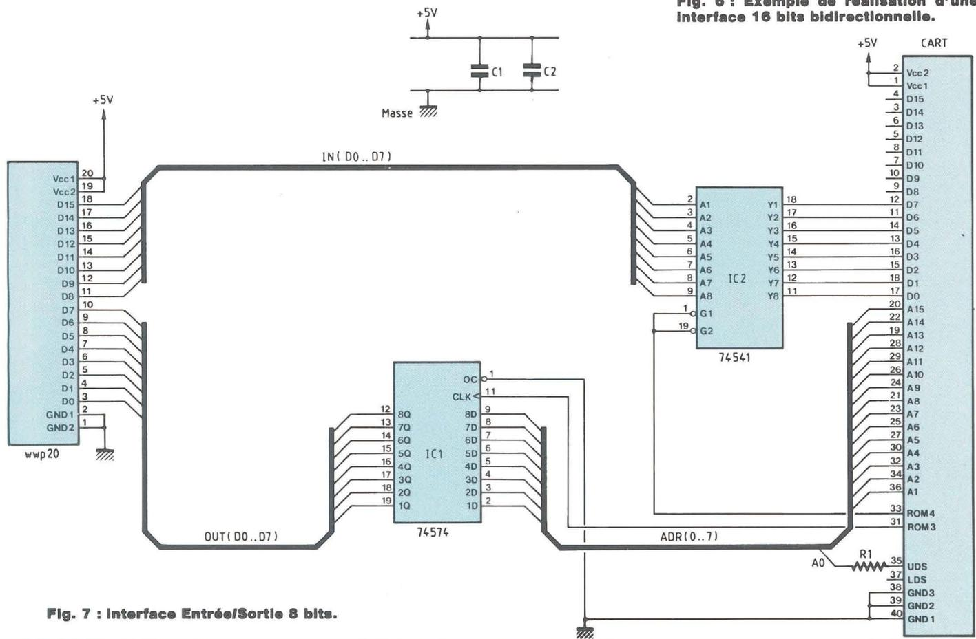
Fig. 7 : Interface Entrée/Sortie 8 bits.
