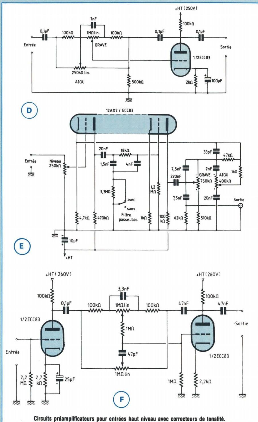
Circuits préamplificateurs pour entrées haut niveau avec correcteurs de tonalité.
