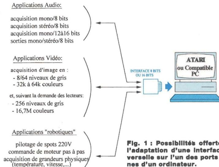
**Fig. 1 :** Possibilités offertes par l'adaptation d'une interface universelle sur l'un des ports externes d'un ordinateur.
