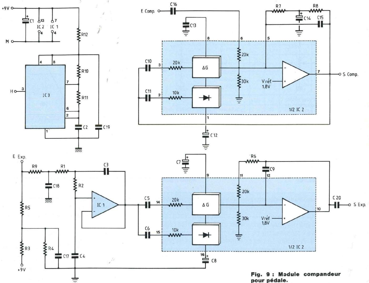
Fig. 9 : Module compandeur pour pédale.
