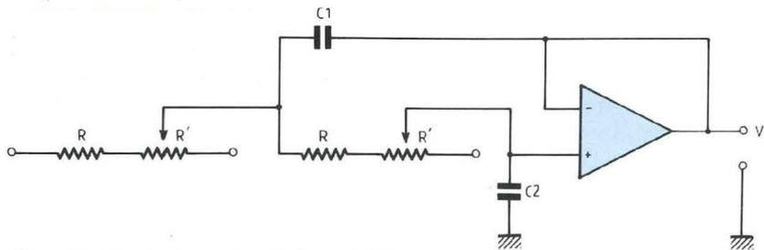
**Fig. 2C : Filtre passe-bas à f<sub>c</sub> variable.**
