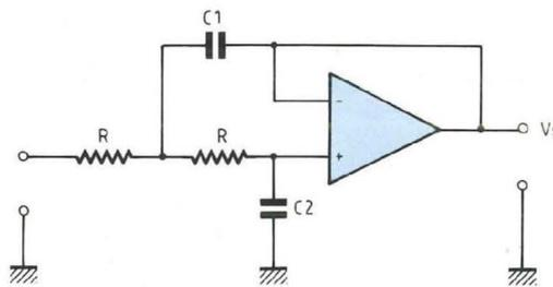
**Fig. 2B : Filtre passe-bas à f<sub>c</sub> fixe.**
