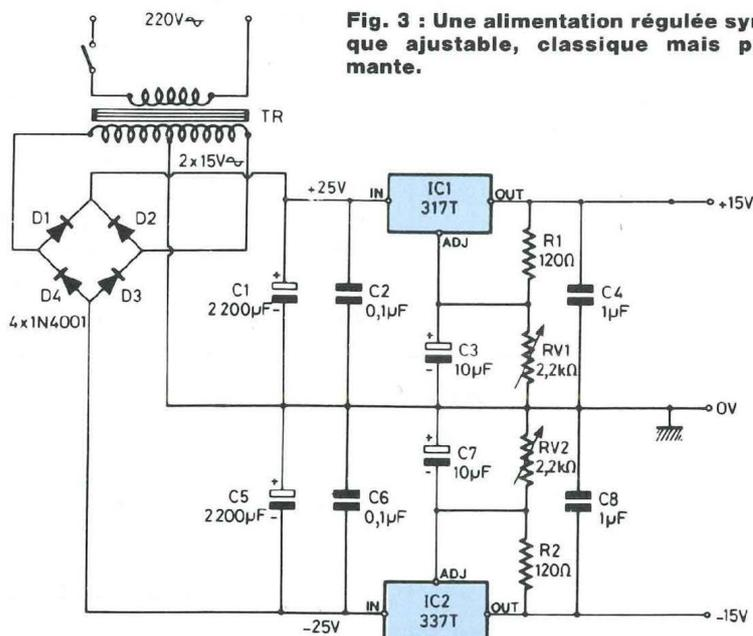
Fig. 3 : Une alimentation régulée symétrique ajustable, classique mais performante.
