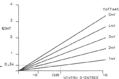
**Fig. 5 : Distorsion d'offset du ΔG.**
