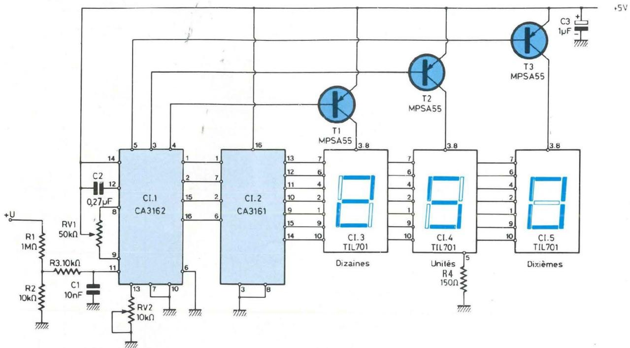
**Fig. 3 : Circuit d'affichage 3 digits permettant une lecture au 1/10° de volt près. Le cœur du montage est le convertisseur I<sup>2</sup>L CA3162.**
