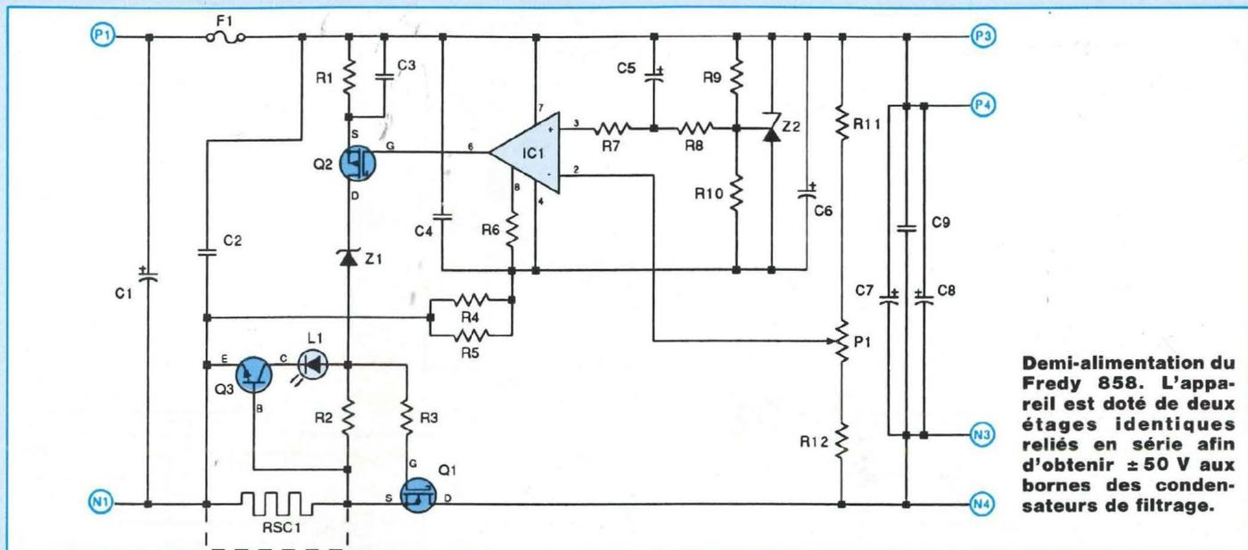
**Demi-alimentation du Fredy 858.** L'appareil est doté de deux étages identiques reliés en série afin d'obtenir  $\pm 50$  V aux bornes des condensateurs de filtrage.
