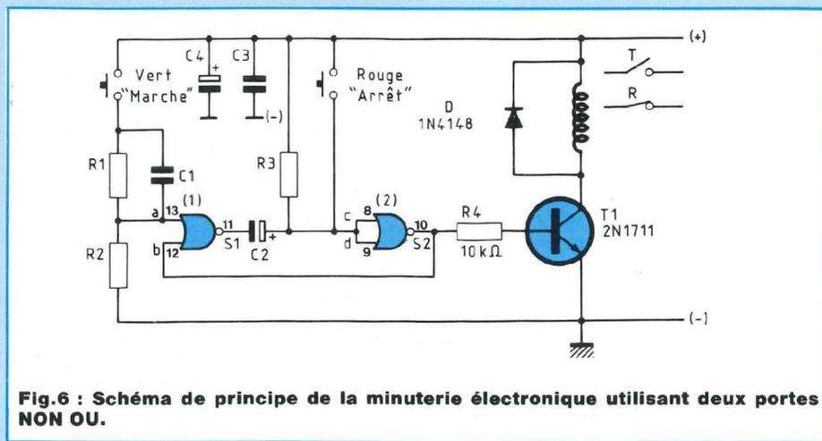
**Fig.6 : Schéma de principe de la minuterie électronique utilisant deux portes NON OU.**
