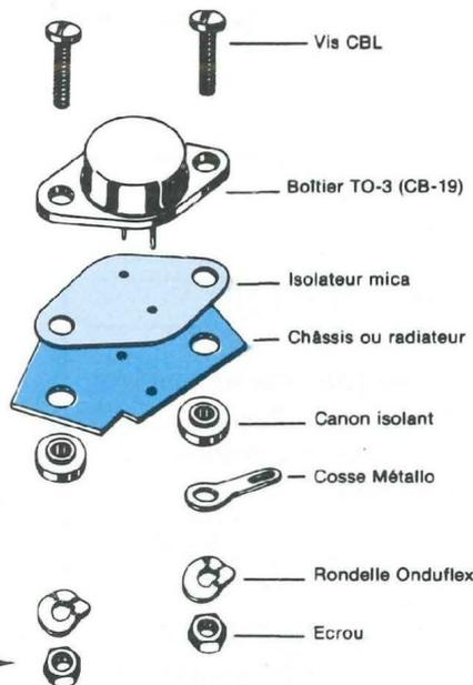
MJ 15001 en l'isolant du boîtier avec, et la feuille de mica, et deux canons, pour le passage de la visserie. Se reporter à la figure 8 pour cette opération.
