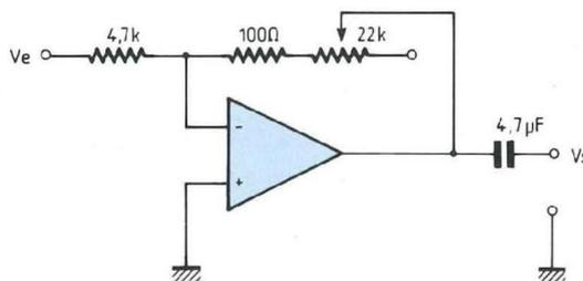
**Fig. 2E : Etage amplificateur à gain variable.**
