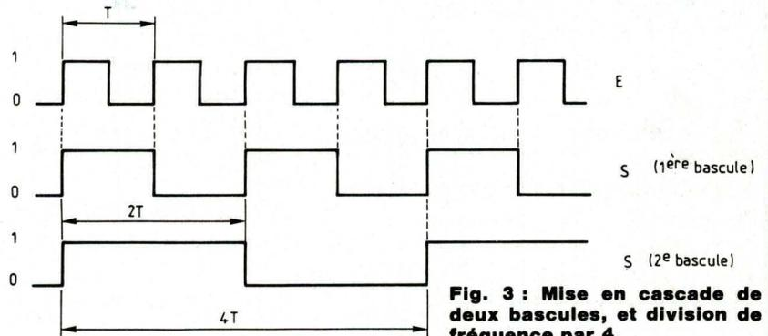
Fig. 3 : Mise en cascade de deux bascules, et division de fréquence par 4.
