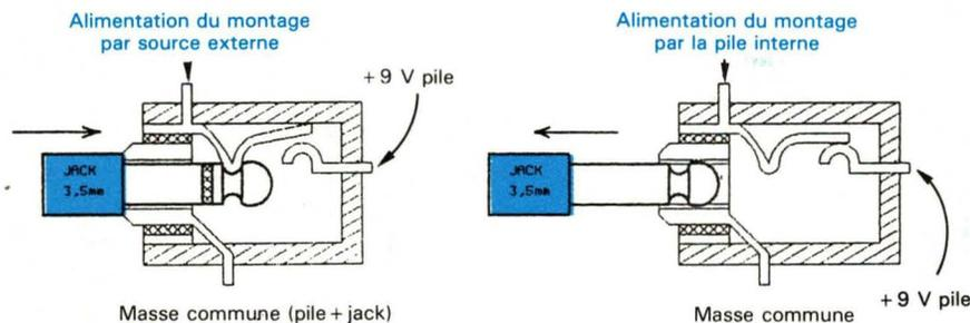
Fig. 9 : Aiguillage des alimentations Int/Ext.
