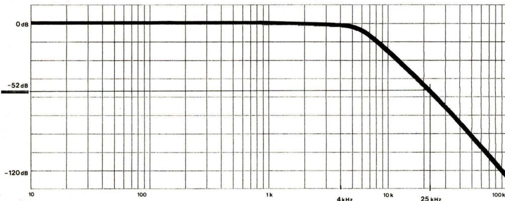
**Fig. 13 : Filtre elliptique de sortie (ordre 7).**
