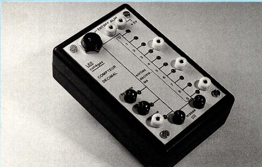
L'étude des bascules (module dans Led N° 103 et fiche dans ce numéro) constituait une introduction à la logique séquentielle. Avec le circuit CD 4017, on systématise la notion de comptage et de division.
