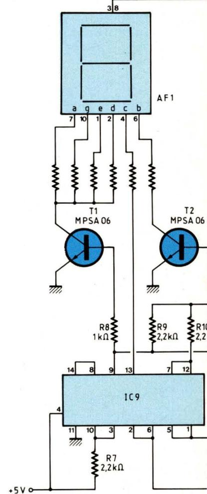
Fig. 2 : Schéma de principe de l'horloge
