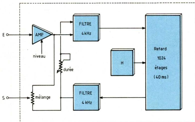
Fig. 10 : Schéma fonctionnel de la réverbération.
