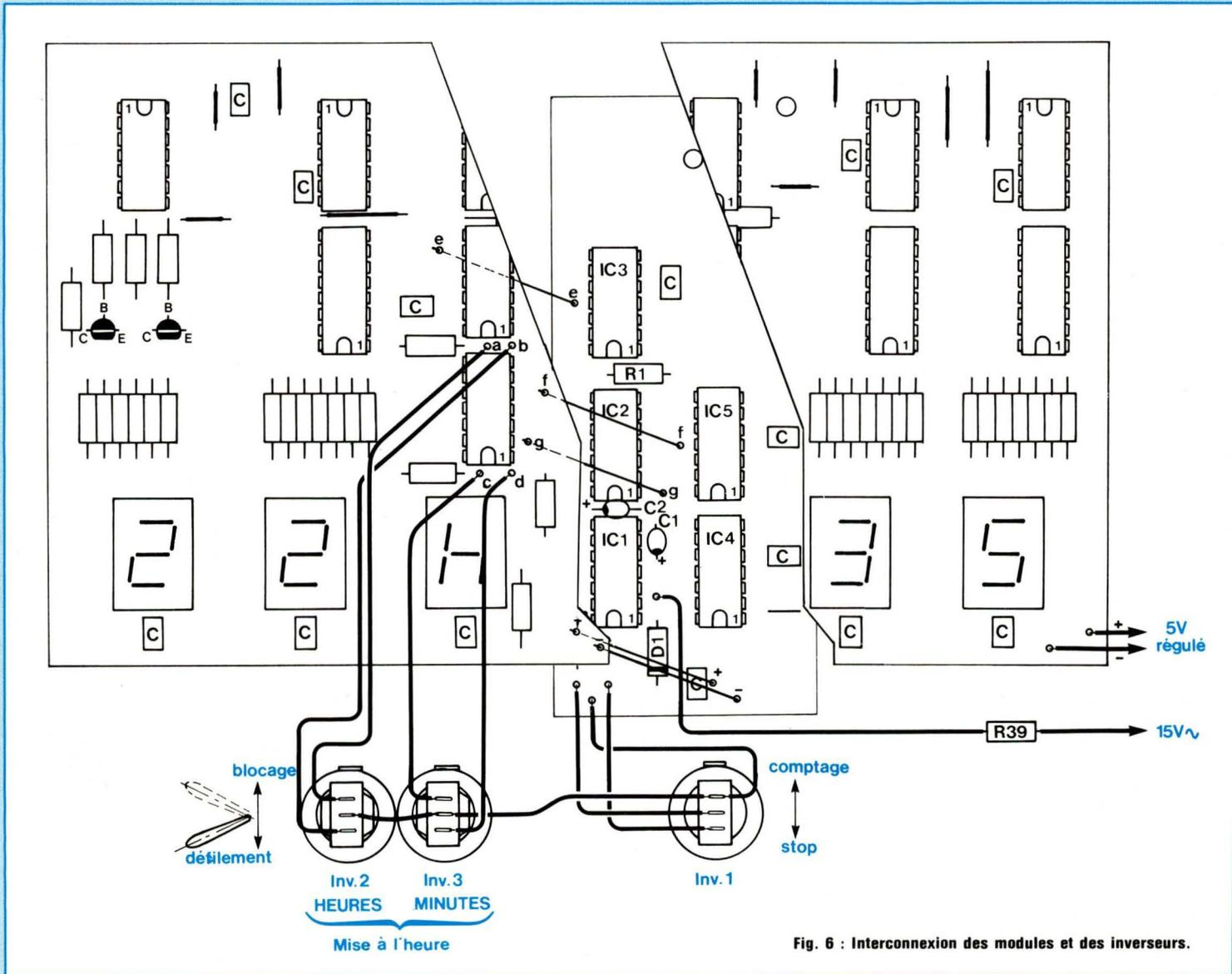
Fig. 6 : Interconnexion des modules et des inverseurs.
