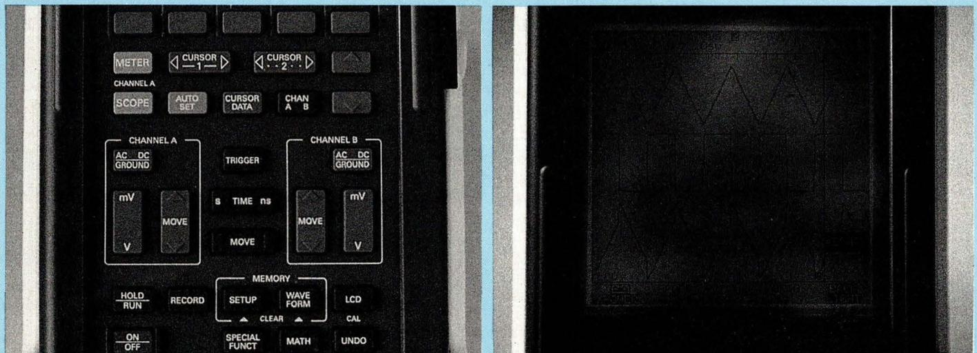
Photo I : Toutes les commandes, centralisées en façade, s'effectuent à l'aide de poussoirs, soit directement (sensibilité, vitesse de balayage, mode de couplage des entrées, etc.), soit à travers des menus qui s'affichent à l'écran.
