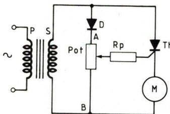
séduisante, consiste à relever automatiquement la tension d'alimentation du moteur, pour lui fournir sa force contre-électromotrice à vide (vitesse de rotation constante) augmentée de la grandeur tension disposée en série avec elle, correspondant à la composante "charge de travail", c'est ce que nous allons faire ...
