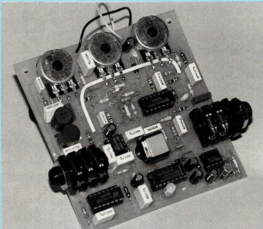
Le module de réverbération présenté dans ces lignes met en oeuvre un registre à transfert de charges de 1024 étages, assurant un retard moyen de 40 ms. Il permet de simuler la résonance particulière des cathédrales et salles de concert à partir de moyens purement électroniques ...
