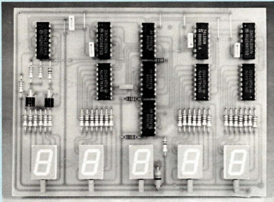
Quelques composants à assembler avec soin sur deux circuits imprimés et vous voici en possession d'une horloge à affichage numérique d'une excellente précision. Equipée d'afficheurs 7 segments de 12,7 mm de hauteur (rouges ou verts selon vos goûts), cette horloge vous renseignera à distance, avec exactitude, vingt-quatre heures sur vingt-quatre, contrairement à celles équipées d'afficheurs LCD inutilisables la nuit ou à plus de deux mètres de distance.
