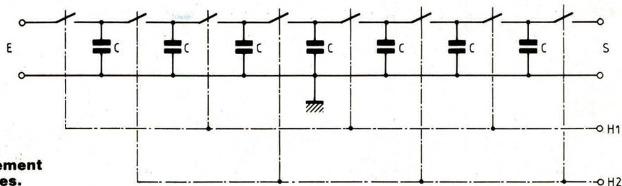
Fig. 2 : Principe de fonctionnement d'un registre à transfert de charges.
