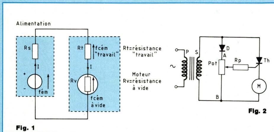
mentation ne débite pas sur un récepteur, la tension présente à ses bornes occupe sa valeur maximale, sa tension sortie à vide, appelée force électromotrice, que nous désignerons par  $f'cém$  ...
