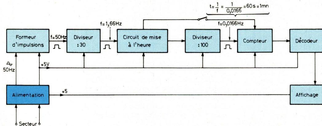
Fig. 1 : Principe de fonctionnement de l'horloge.
