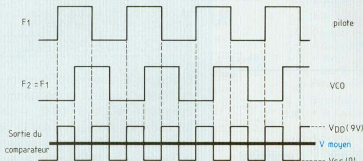
**Fig. 3a :** Lorsque la PLL est verrouillée ( $F_{\text{pilote}} = F_{\text{VCO}}$ ), la sortie du comparateur délivre des créneaux symétriques à la fréquence  $2F$ , dont la tension moyenne égale la moitié de la tension d'alimentation  $V_{DD}$ .
