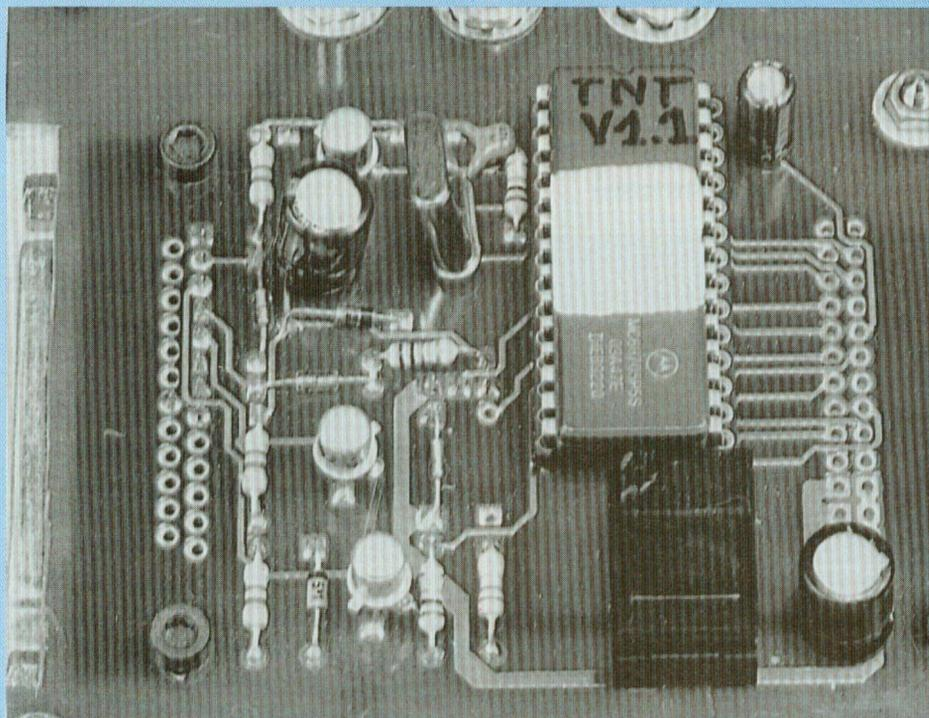
La carte TNT permet la programmation des microcontrôleurs MOTOROLA de la famille 68x05xx dont le plus connu est le 68705. Un circuit imprimé de 90 x 250 mm reçoit l'ensemble des circuits, à l'exception de l'alimentation. Le montage se charge de transférer un fichier objet de la famille 68x05xx, contenu dans un ordinateur et, transmis en série, au format MOTOROLA "S" en ASCII / ANSI.
