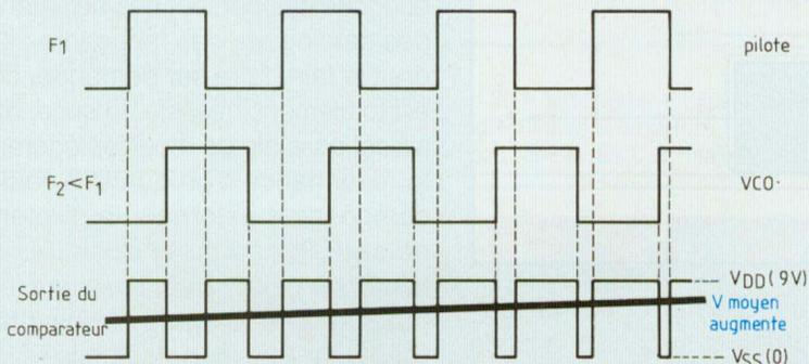
**Fig. 3b :** Un décalage entre la fréquence du VCO et celle du pilote à quartz se traduit par une modulation de la symétrie des créneaux de sortie. Leur tension moyenne varie dans un sens qui tend à corriger le glissement de fréquence.
