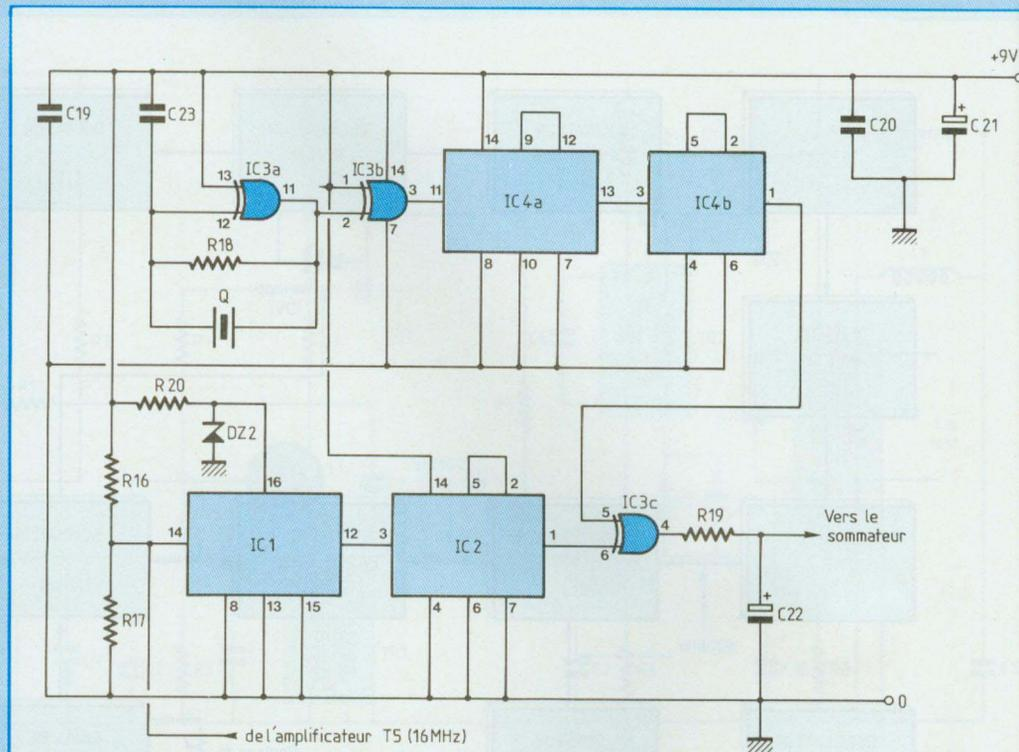
Fig. 11 : Oscillateur pilote et boucle à verrouillage de phase.
