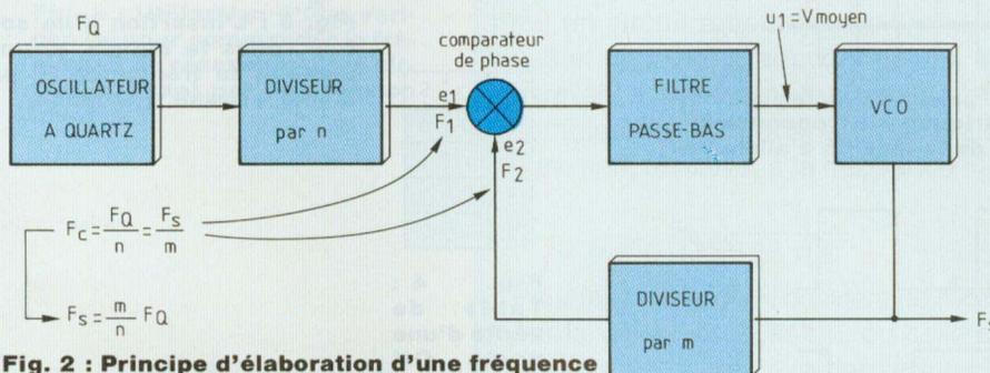
**Fig. 2 :** Principe d'élaboration d'une fréquence  $F_s$  quelconque à partir d'une fréquence de référence  $F_Q$ , à l'aide d'une boucle à verrouillage de phase.
