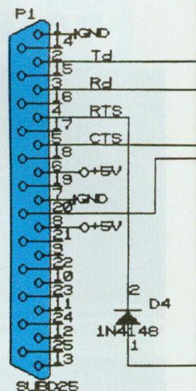
La liaison avec l'ordinateur s'effectue par un connecteur DB25. Les circuits d'interface au standard RS232 sont réalisés en composants discrets.
