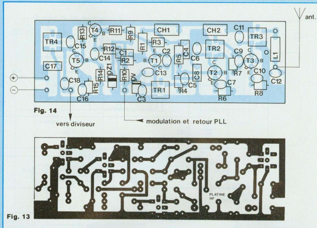
du collecteur de T1. Dans le cas contraire, on observe une amplitude plus faible sur la base de T3 et des ruptures de phase qui engendrent un signal plus ou moins distordu, dont l'oscillogramme B donne un exemple. En effet, les excitations par la sinusoïde élaborée en T1 ne coïncident plus avec les descentes (inversion de phase dues au montage en émetteur commun) des sinusoïdes sur T2.
