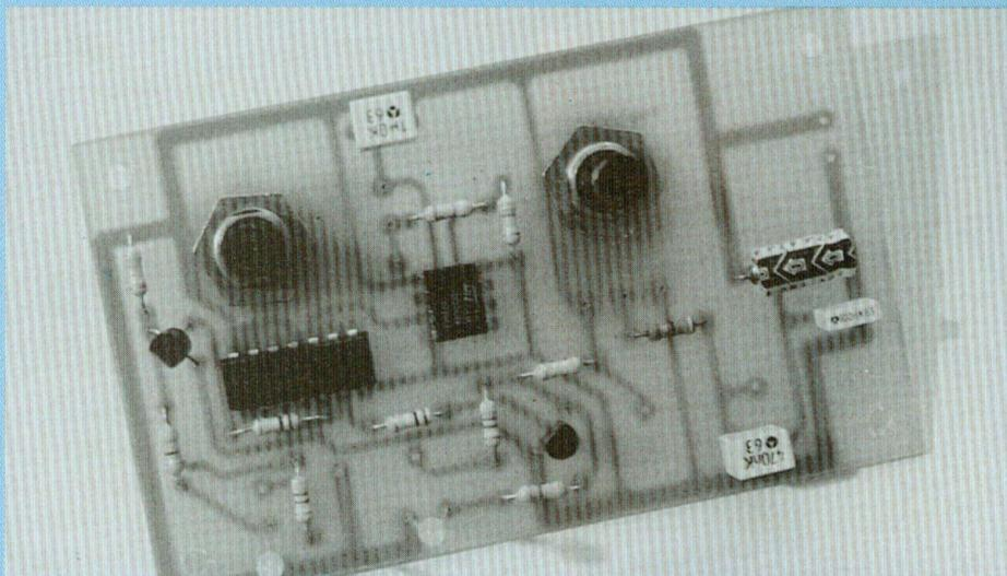
Cinq modules, conçus dans la même optique que celui décrit dans ce numéro (étude des portes logiques) et de présentation semblable, permettent un total de dix à quinze manipulations distinctes. L'introduction manuelle de niveaux logiques sur les entrées conduit à une autonomie totale de ces éléments, sous la seule condition de leur fournir, à l'aide de l'alimentation décrite par ailleurs, la tension stabilisée de 5 volts nécessaire à leur fonctionnement.
