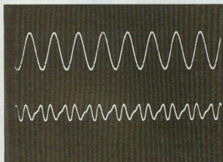
B. Un mauvais réglage de  $TR_2$  donne, en sortie de  $T_2$ , une onde distordue.
