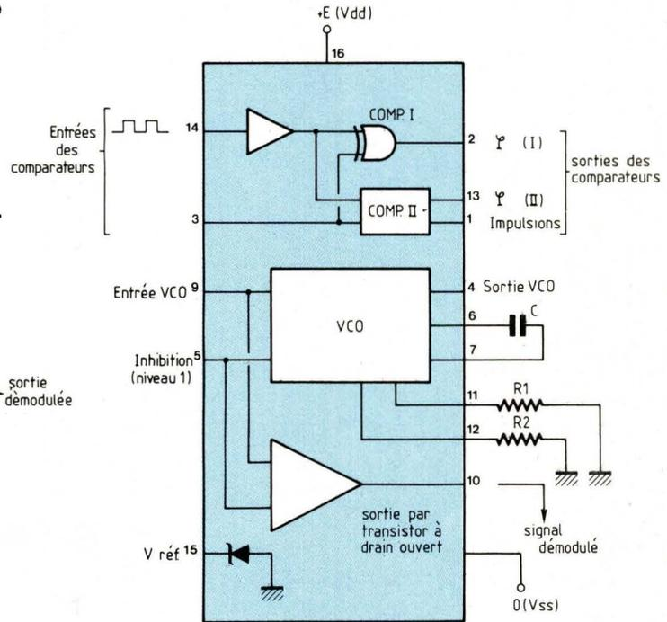
**Fig. 15 : Utilisation du CD 4046 pour la démodulation de fréquence.**
