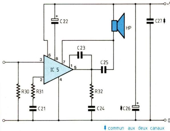
Fig. 17 : Schéma d'un amplificateur de sortie.
