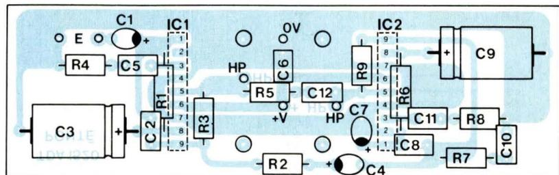
Fig. 8B : Le condensateur C13 est soudé directement aux broches 2 et 6 de IC1 (+ en 6). La résistance R10 est soudée aux pastilles d'entrée (E), côté pistes cuivrées.
