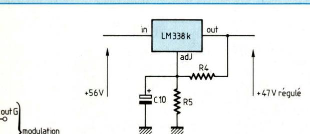
Fig. 5 : Une régulation à base de LM 338K.
