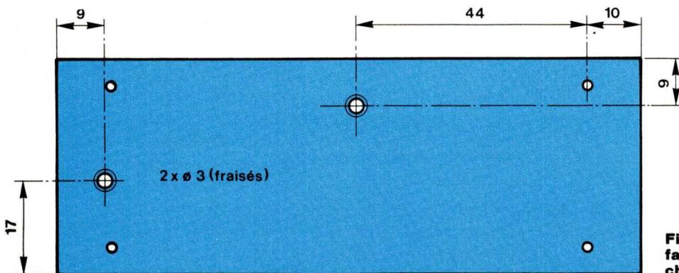
Fig. 13 : Plans de perçages du coffret : face avant ; face arrière ; flasque gauche.
