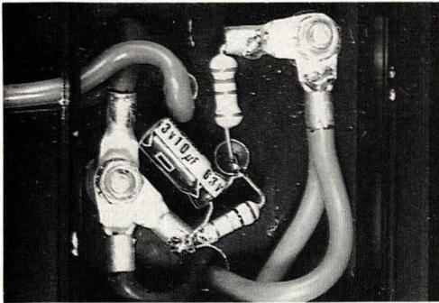
Fig. 10 : Câblage "en l'air" des composants.
