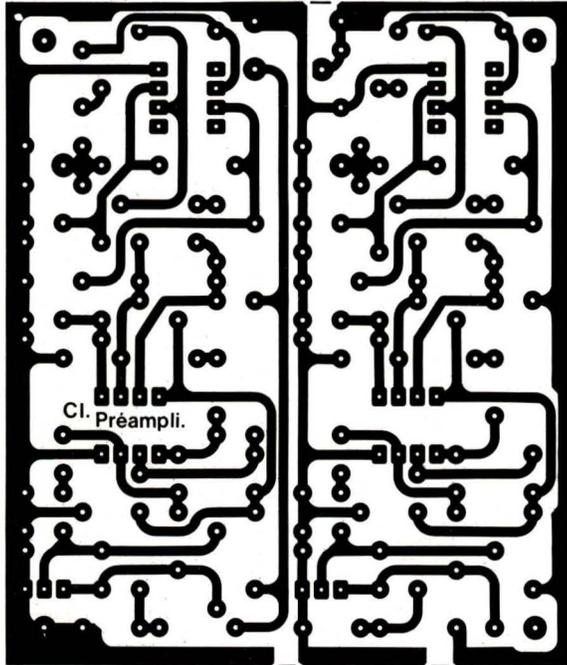
Fig. 20 : Circuit imprimé des préamplificateurs.
