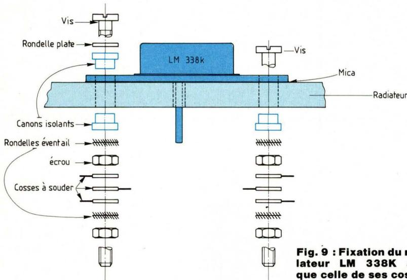
Fig. 9 : Fixation du régulateur LM 338K ainsi que celle de ses cosses.
