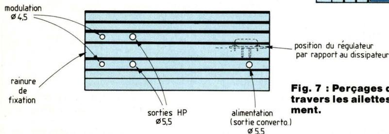
Fig. 7 : Perçages du dissipateur à travers les ailettes de refroidissement.
