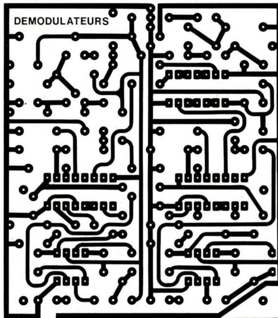
Fig. 22 : Circuit imprimé des démodulateurs et des amplificateurs BF.
