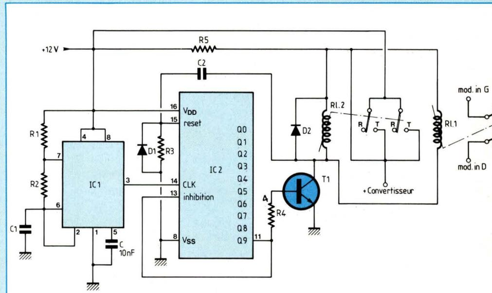
Fig. 4 : Temporisation de mise sous tension fixée à 5 secondes.
