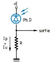
**Fig. 10 : Charge active de la photodiode.**
