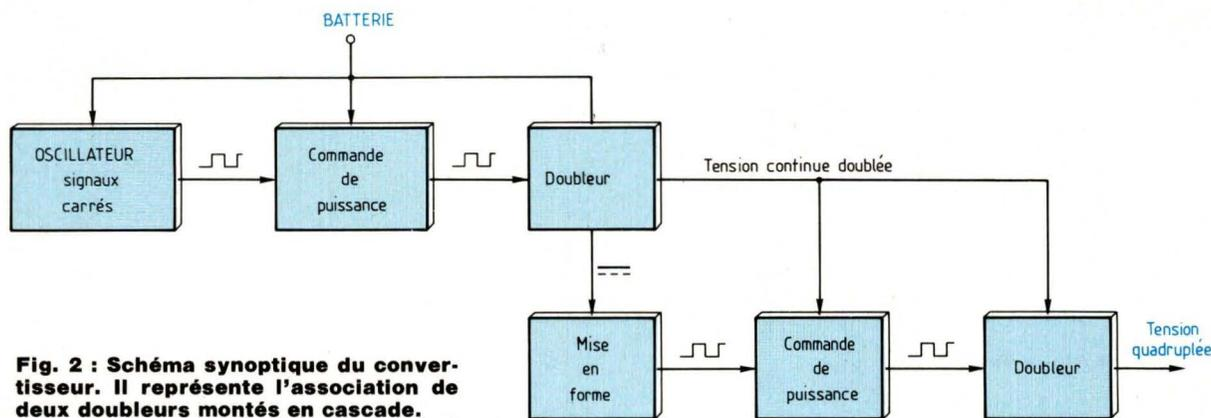
**Fig. 2 : Schéma synoptique du convertisseur. Il représente l'association de deux doubleurs montés en cascade.**
