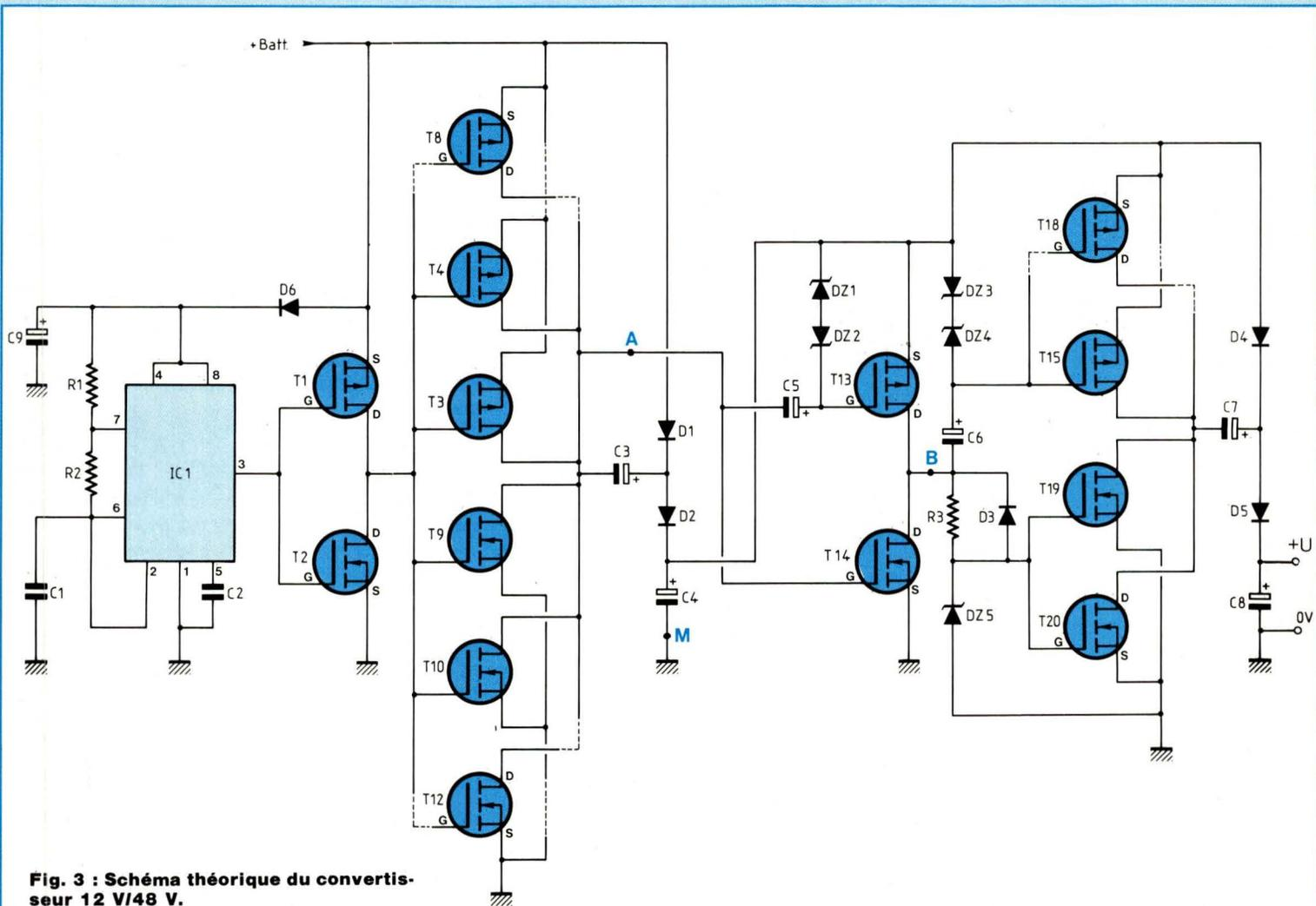
**Fig. 3 : Schéma théorique du convertisseur 12 V/48 V.**
