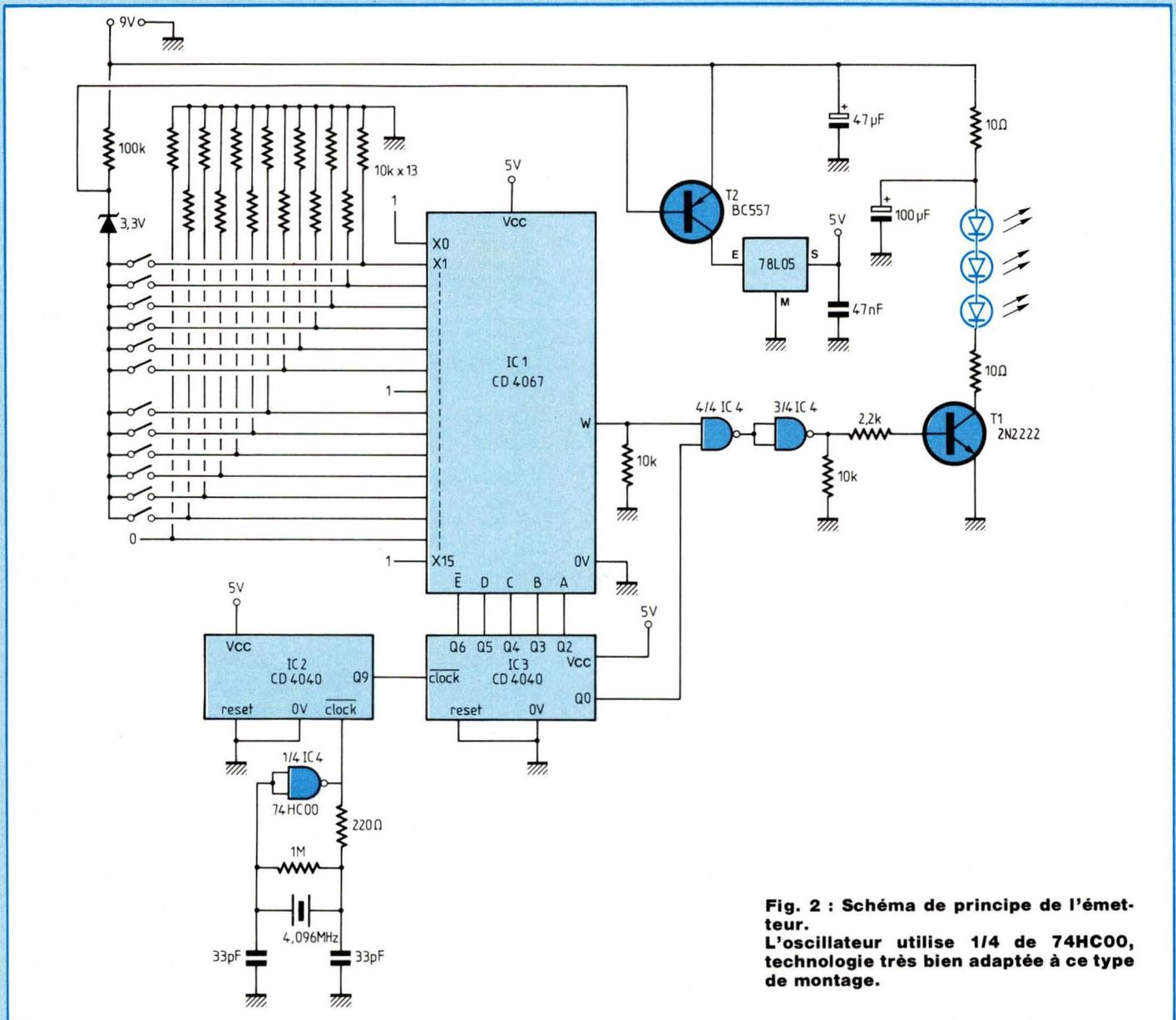
**Fig. 2 : Schéma de principe de l'émetteur.**
