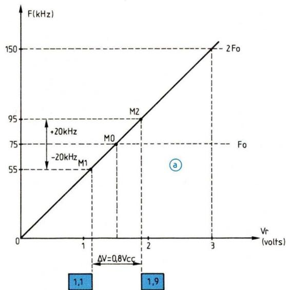
**Fig. 5 : La même excursion maximale de fréquence,  $\Delta F$ , autour de la fréquence centrale  $F_0$ , exige 0,8 V crête à crête pour le canal gauche (a), mais seulement 0,4 V pour le canal droit (b).**
