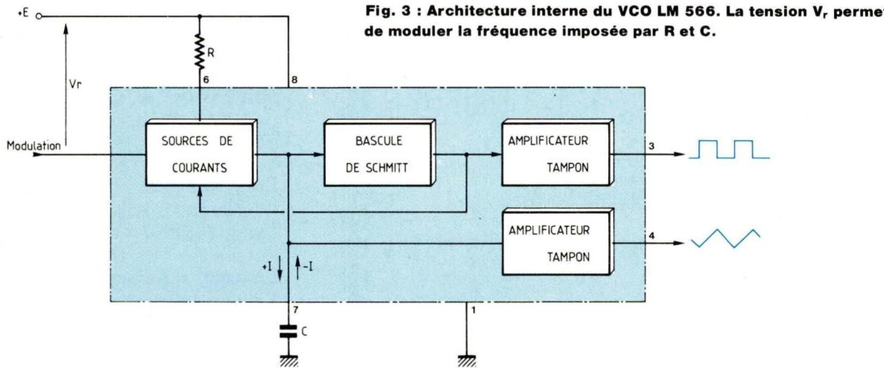
**Fig. 3 : Architecture interne du VCO LM 566. La tension  $V_r$  permet de moduler la fréquence imposée par R et C.**
