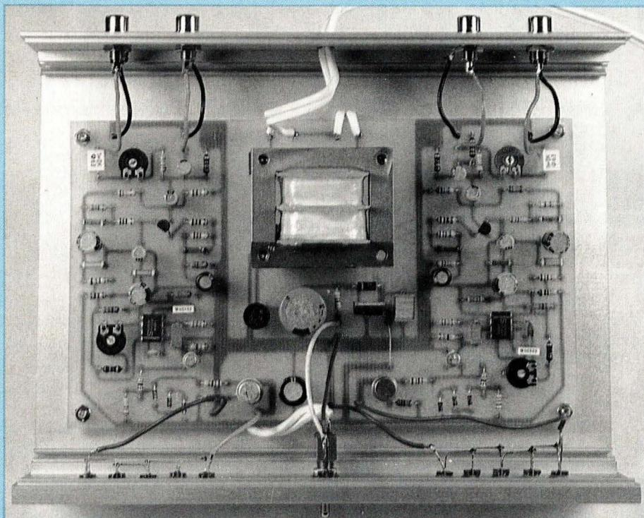
Même de prix modeste, un casque restitue une bande passante et une dynamique auxquelles n'accèdent que des enceintes de haut de gamme, par ailleurs tributaires des caractéristiques acoustiques du local et dont la puissance sonore peut incommoder l'entourage. La transmission, par infrarouges, d'une sous-porteuse dont le signal audio module la fréquence, autorise une écoute à la fois discrète et libérée du "fil à la patte" habituel aux casques ...
