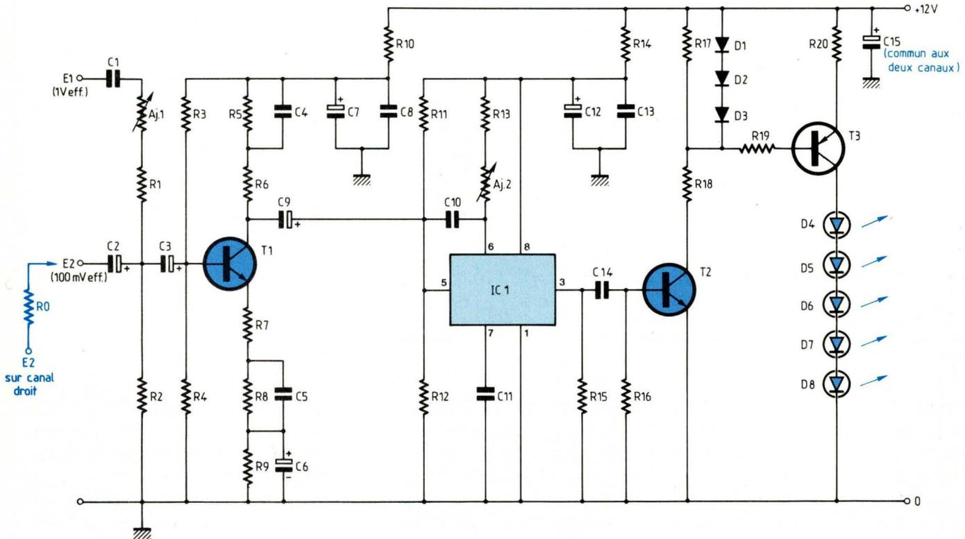
Fig. 6 : Schéma d'un canal de l'émetteur.
