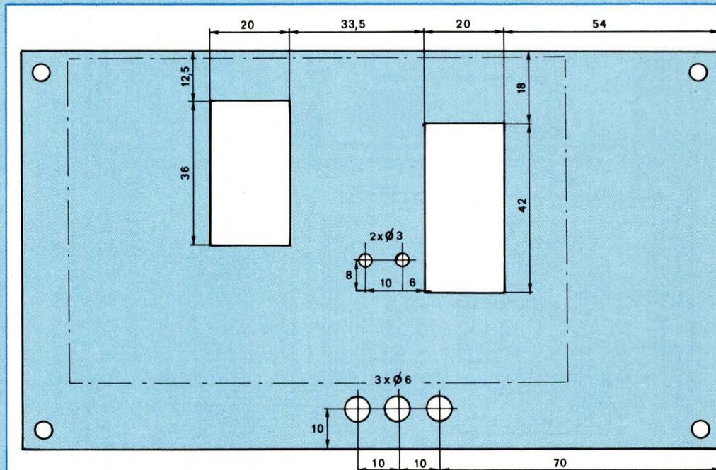
Fig. 27 : Plan de perçage de la face avant.
