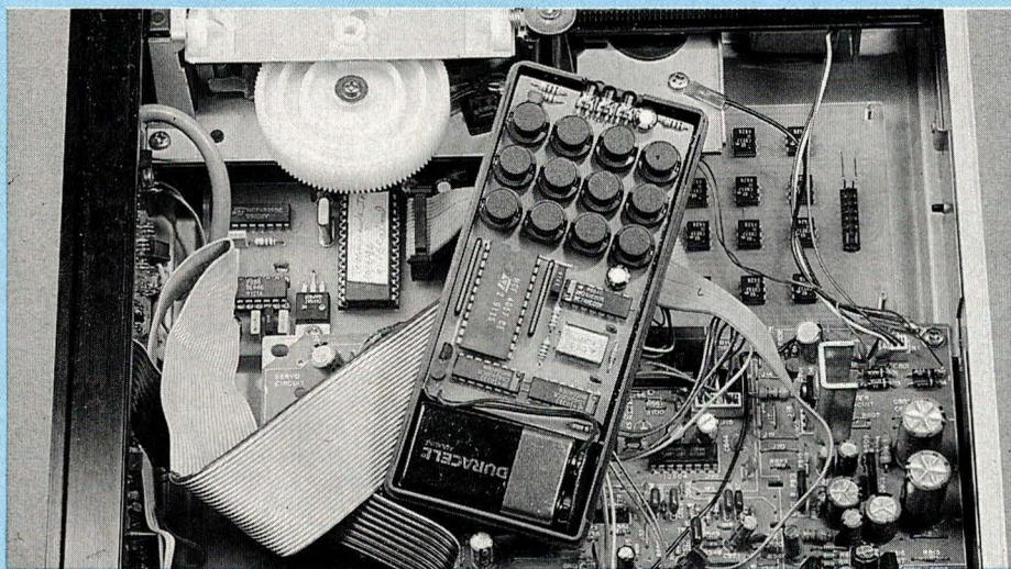
Cette télécommande infra-rouge permet de transmettre jusqu'à 12 ordres simultanés et ce, avec une très grande fiabilité. D'autre part, la rapidité de réponse du récepteur rend le système tout à fait adapté à la réalisation de télécommandes de lecteurs de compact disque, téléviseurs ...
