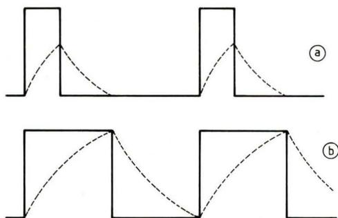
**Fig. 7 :** Aux fréquences élevées, l'émission d'impulsions courtes (a) diminue le rendement, et l'amplitude des signaux recueillis après traitement, matérialisés en pointillés, est plus grande avec les créneaux symétriques (b).
