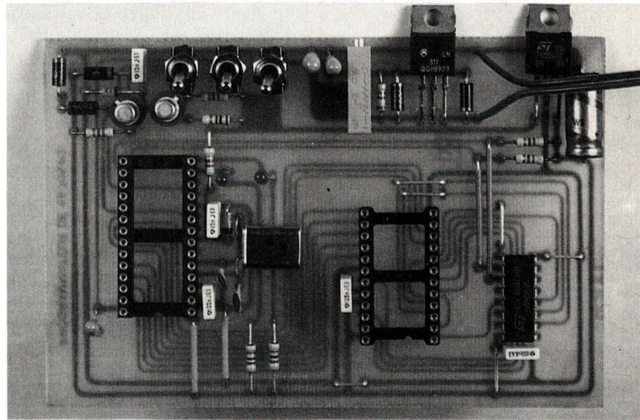
Le régulateur IC5 qui figure sur le dessus du module doit être fixé contre un dissipateur, celui-ci dégageant une chaleur importante lors de longues programmations. Il est donc plus commode de le souder, côté pistes cuivrées du C.I. et de plaquer sa semelle métallique contre un radiateur. Il est également possible de remplacer le boîtier TO220 par un boîtier TO3.
