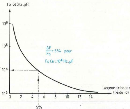
**Fig. 4 :** Diagramme fournissant le produit  $F_0 C_6$  en fonction de la largeur de bande voulue.
