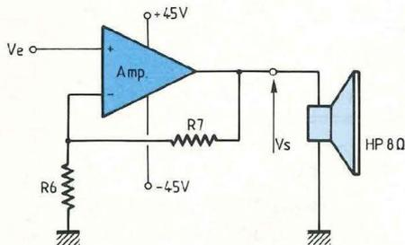
Fig. 3 : Montage de base équivalent de l'amplificateur 100 W.
