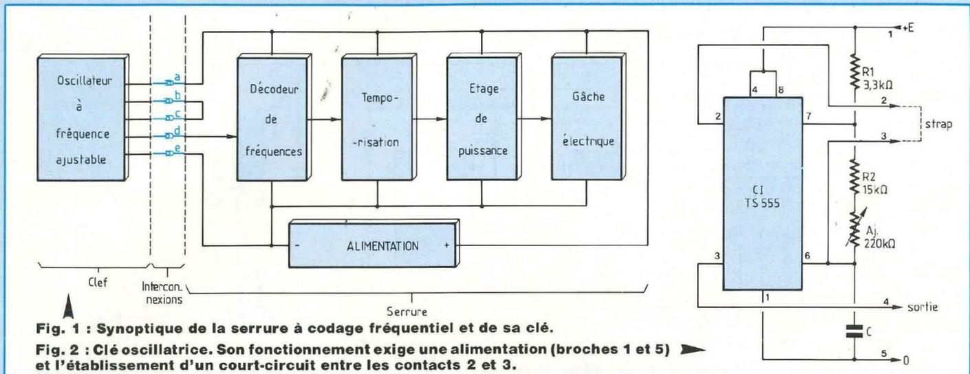
Fig. 1 : Synoptique de la serrure à codage fréquentiel et de sa clé.
