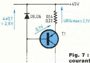
**Fig. 7 : Protection en courant de T1 et T2.**
