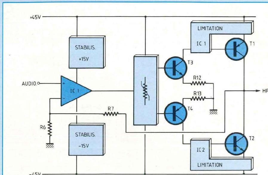
Fig. 2 : Principe de fonctionnement de l'amplificateur 100 W.
