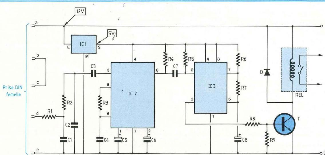
**Fig. 3 :** Les composants R3 et C4 déterminent la fréquence d'accord de la serrure. Selon les plages choisies, il conviendra de modifier également C1 et C2 (filtre d'entrée), ainsi que C6, qui fixe la bande passante, et C5.
