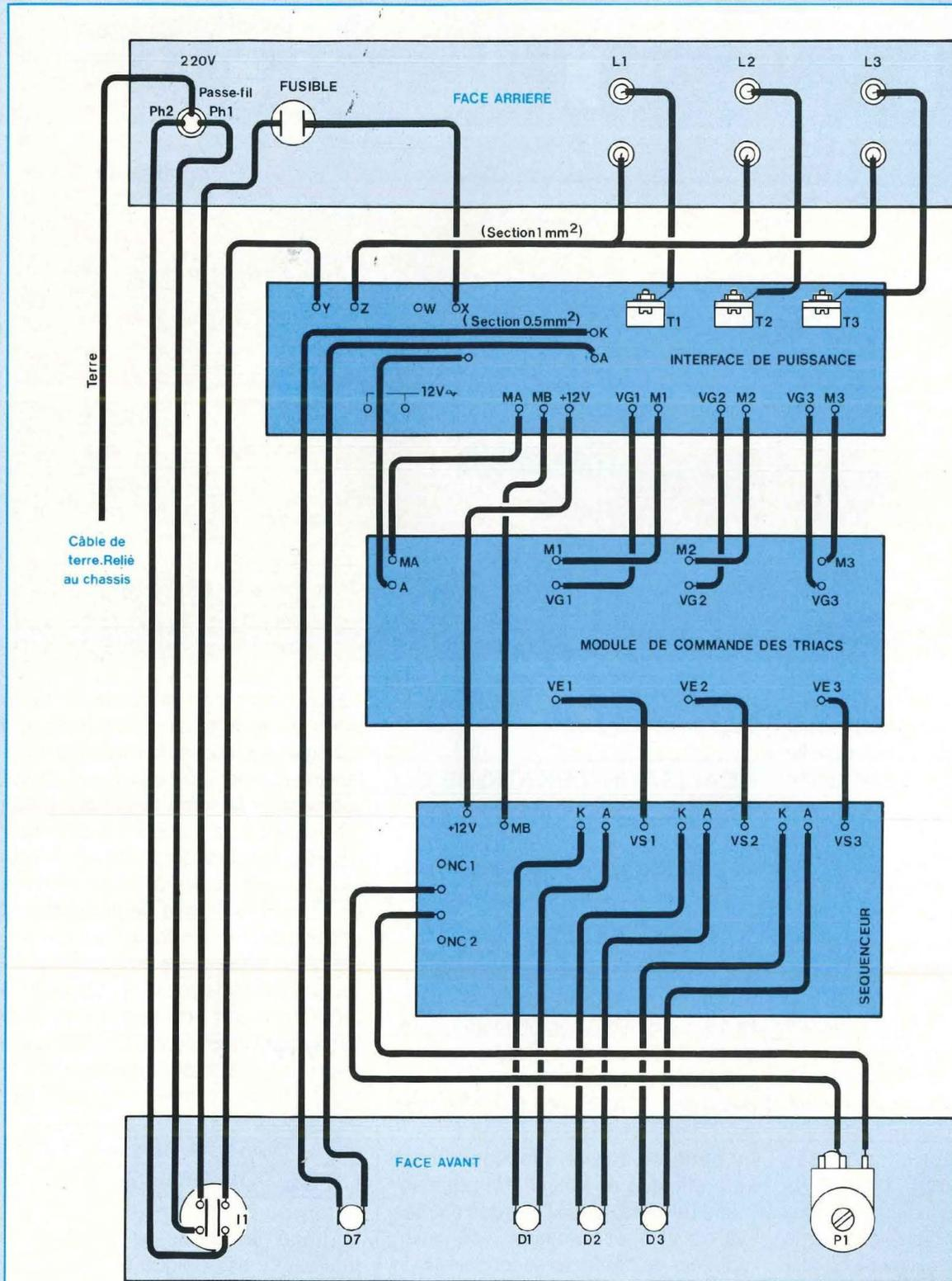
Fig. 20 : Plan de câblage du mélangeur trichrome.
