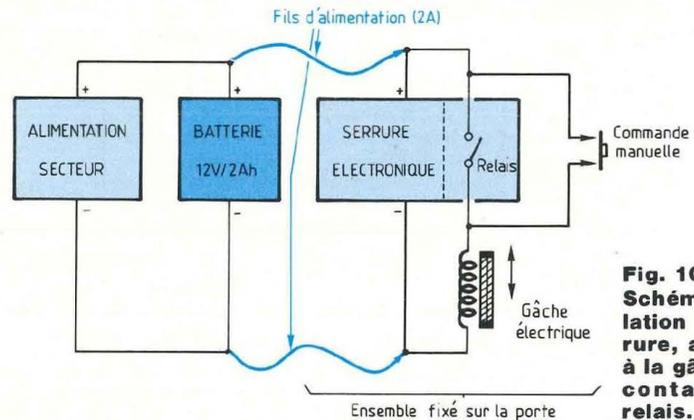
**Fig. 10 : Schéma d'installation de la serrure, avec liaison à la gâche par les contacts du relais.**
