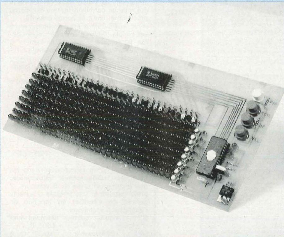
Voici une réalisation originale qui pourra intéresser tous ceux qui voudraient recycler leur 68705 P3S devenu inutile. Il s'agit d'un afficheur géant à LEDs, identique aux panneaux publicitaires qui apparaissent par dizaines dans les rues ...
