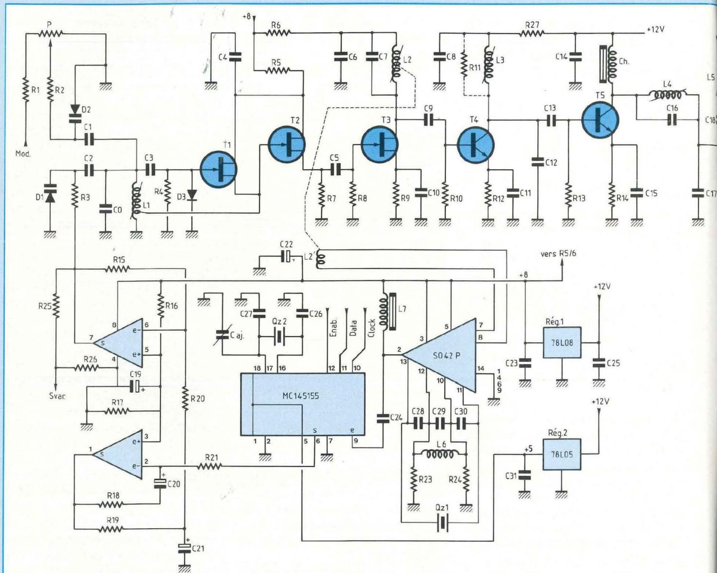
Fig. 2 : Schéma de la platine HF8-SF.
