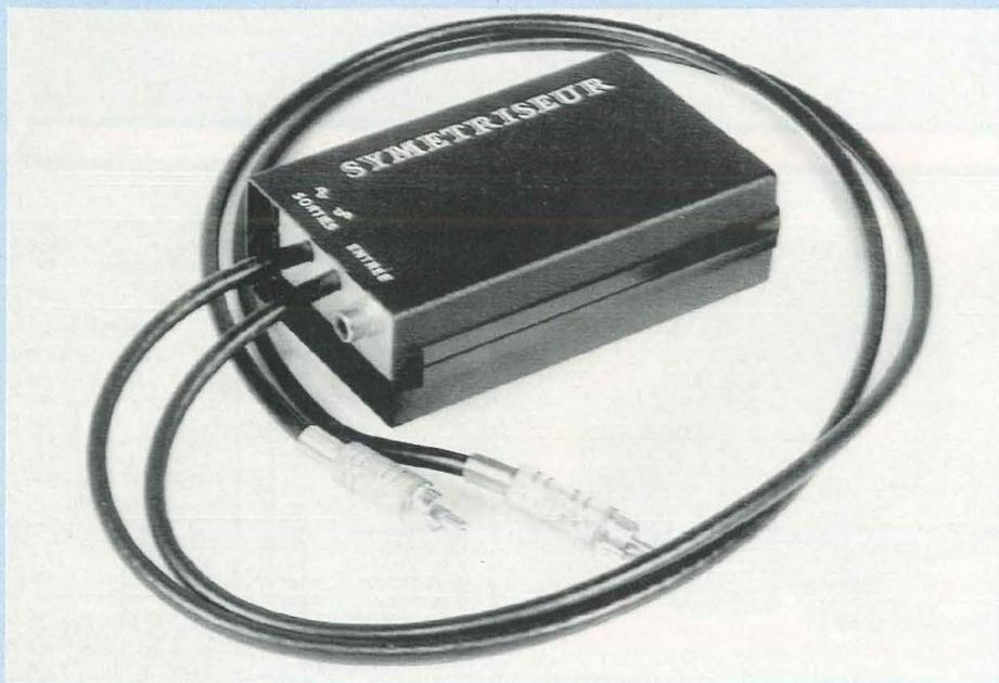
Cette petite réalisation ne manque pas d'intérêt, car associée à tout amplificateur stéréophonique fonctionnant en classe A-B et non ponté, elle permet de le transformer instantanément en un bloc monophonique de très forte puissance. Ainsi, notre classe A-B de 2 x 60 W eff. publié dans le Led n° 81 de novembre 1990 est-il capable de fournir plus de 180 W eff. dans une charge de 8 Ω !
