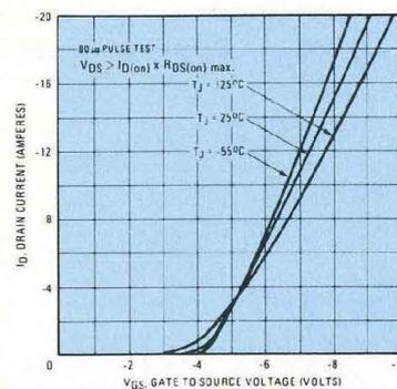
**Fig. 5 : Courant de Drain selon la tension  $V_{GS}$  de commande d'un D<sup>2</sup>-MOS à enrichissement.**
