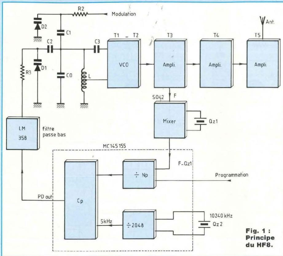
**Fig. 1 : Principe du HF8.**
