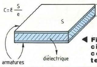
Fig. 3 : Capacité d'un condensateur plan.
