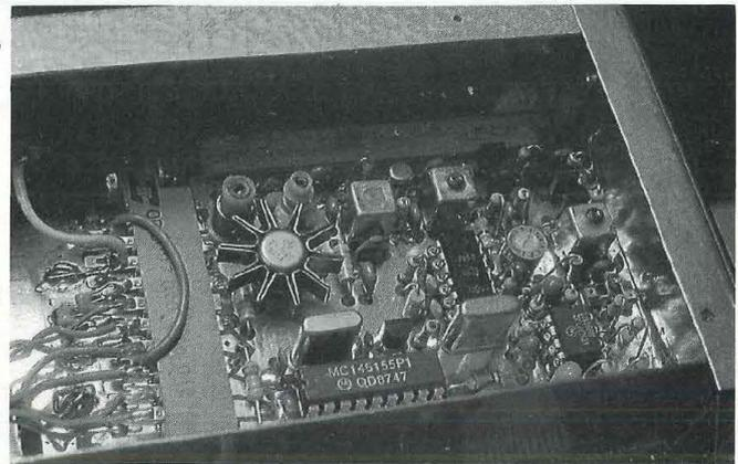
Souder plan de masse recto, sauf circuit imprimé à trous métallisés
