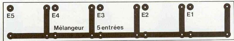
Fig. 5 : Circuit imprimé permettant le raccordement des fiches Jack.
