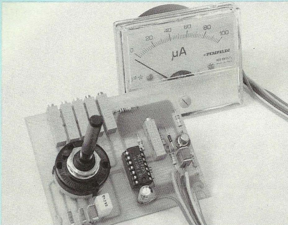
Dans la même optique que pour le petit générateur BF à pont de WIEN décrit dans ce numéro, cette réalisation va vous permettre de connaître instantanément la fréquence d'un signal observé sur l'écran d'un oscilloscope. Fiable, précis une fois bien étalonné, peu onéreux (l'élément le plus coûteux étant le galvanomètre de 100 µA), il deviendra rapidement un appareil de mesure indispensable lors de vos manipulations.
