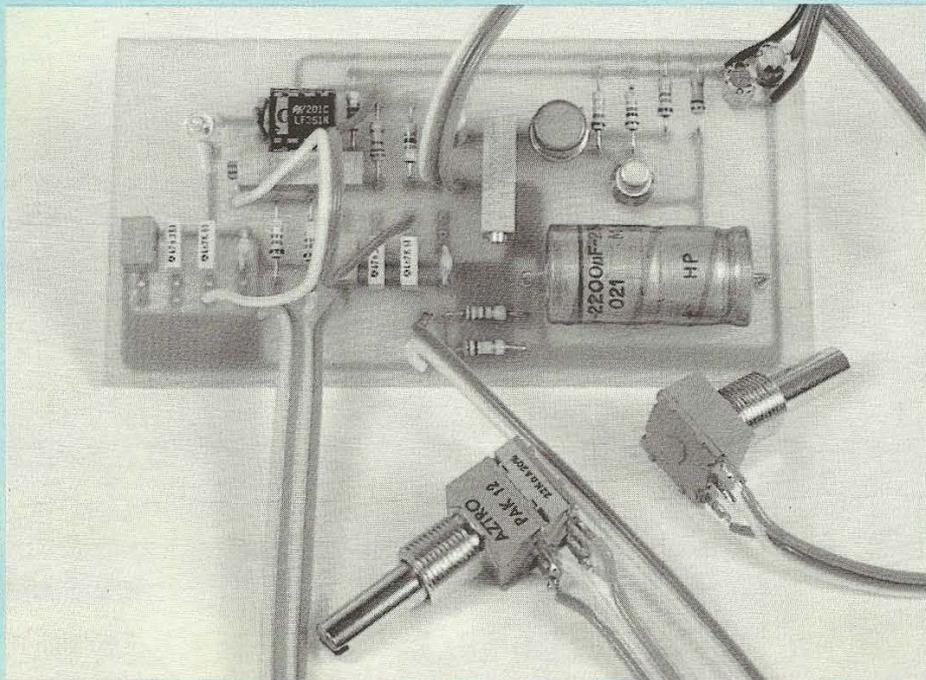
Un générateur BF pour les essais et la mise au point de circuits électroniques est généralement bien utile. Il n'est pas indispensable pour un amateur ou un dépanneur de disposer d'un appareil de laboratoire très précis donc très onéreux, mais plutôt d'avoir sous la main un oscillateur BF d'un emploi très simple.
