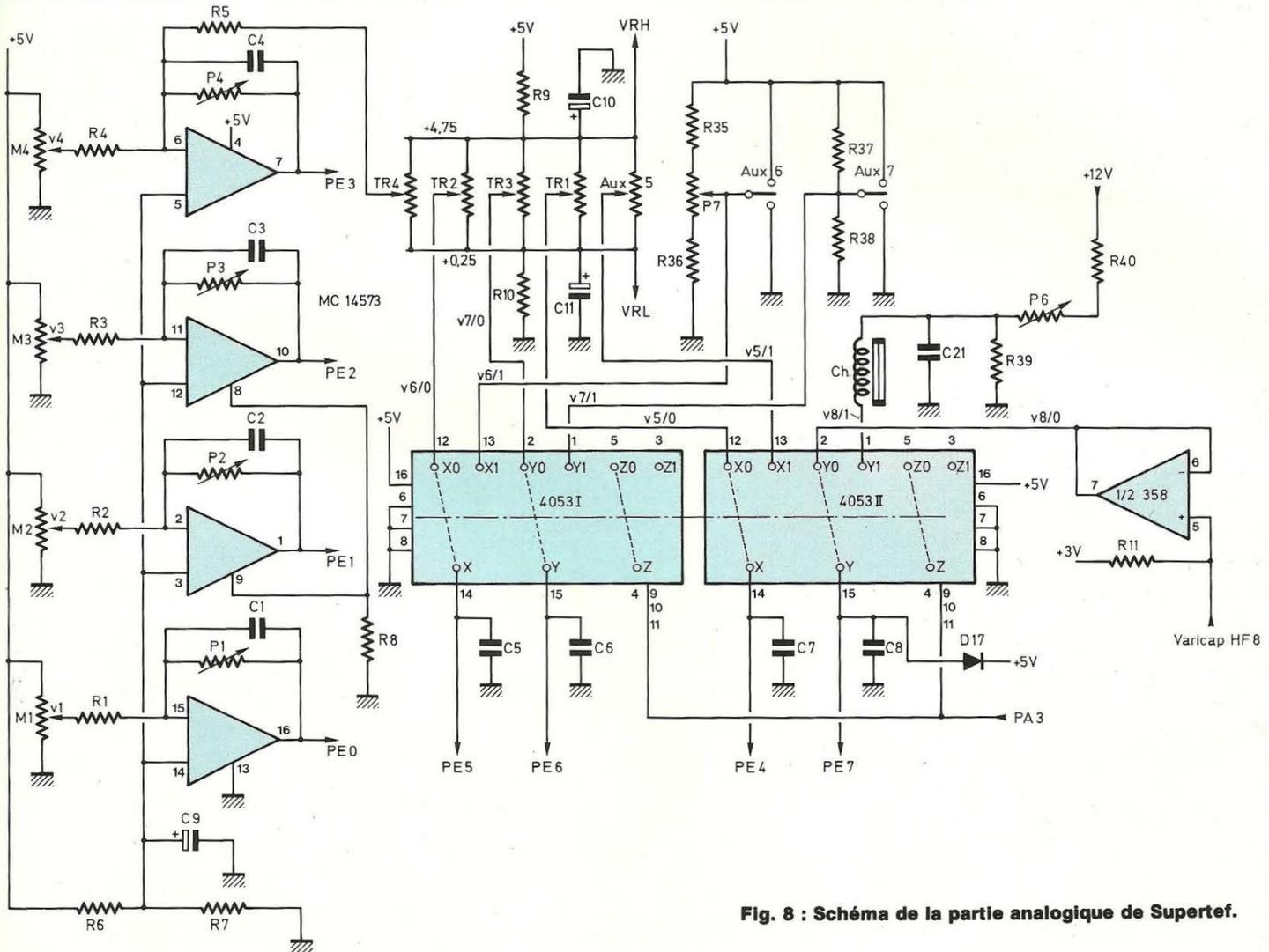
Fig. 8 : Schéma de la partie analogique de Supertef.
