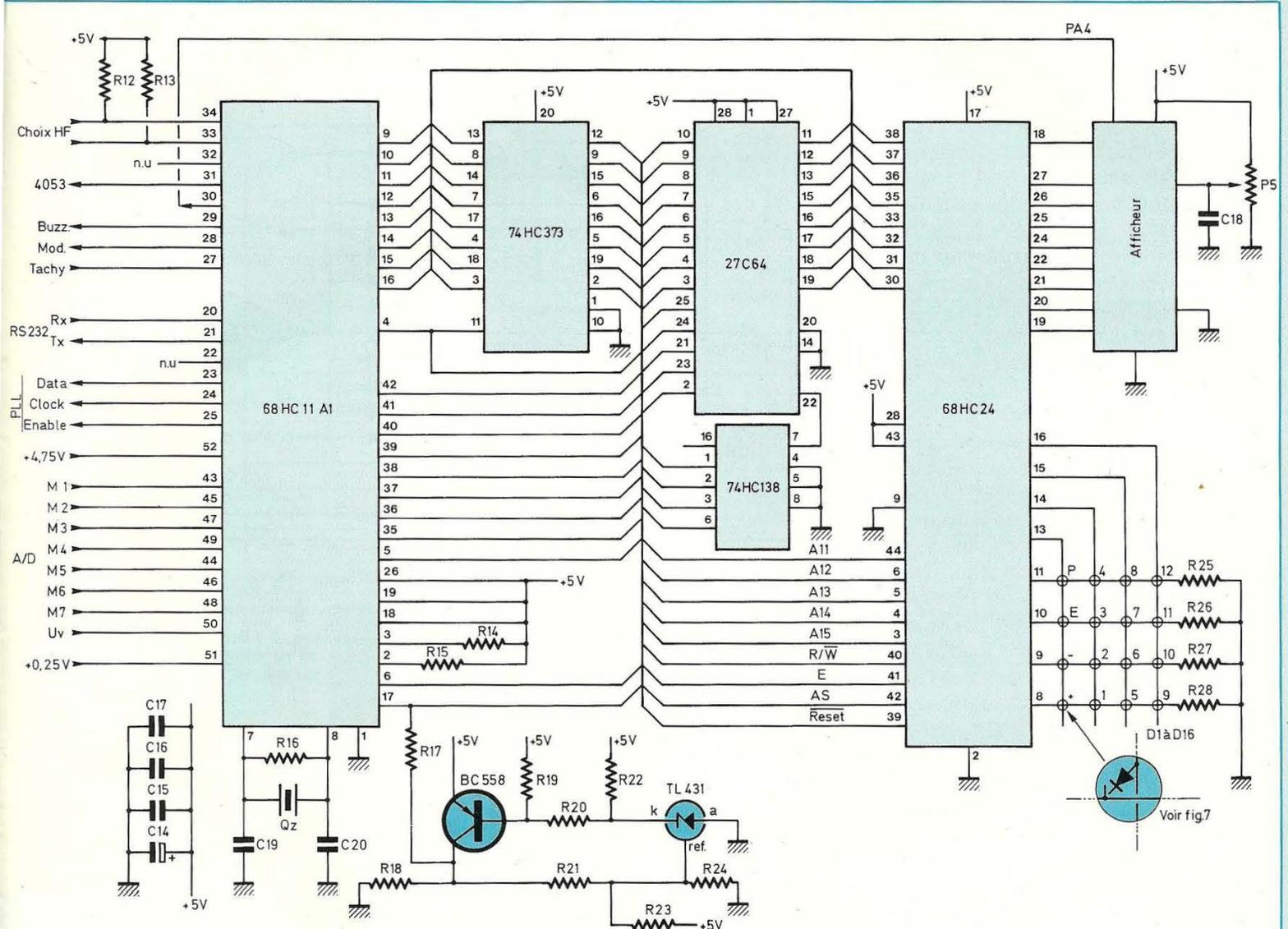
**Fig. 6 : Schéma de la partie logique de Supertef.**
