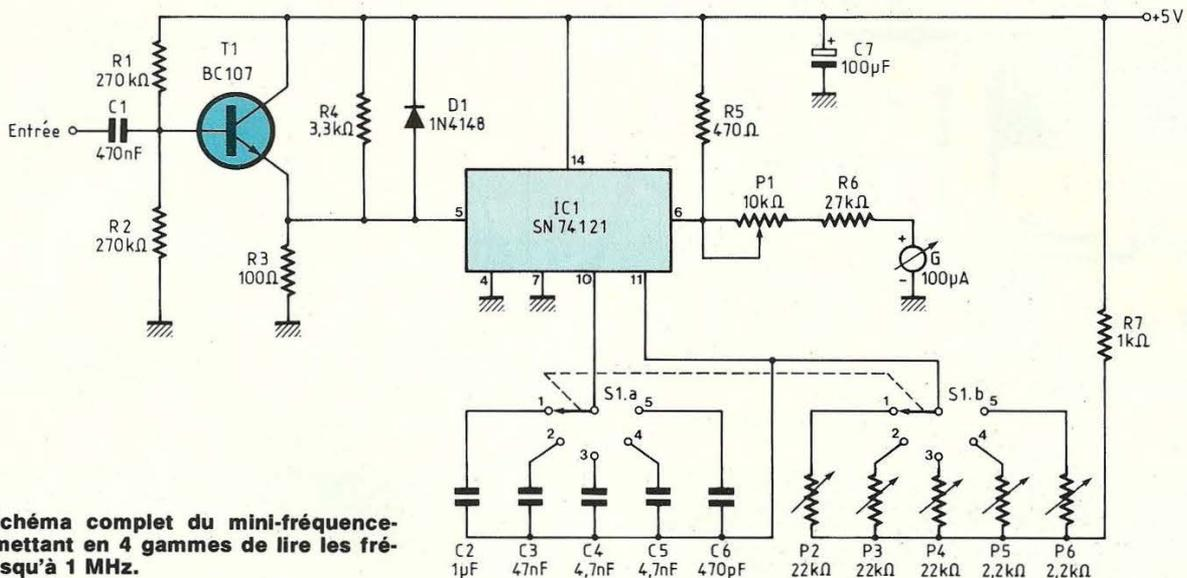
**Fig. 2 : Schéma complet du mini-fréquence-mètre permettant en 4 gammes de lire les fréquences jusqu'à 1 MHz.**
