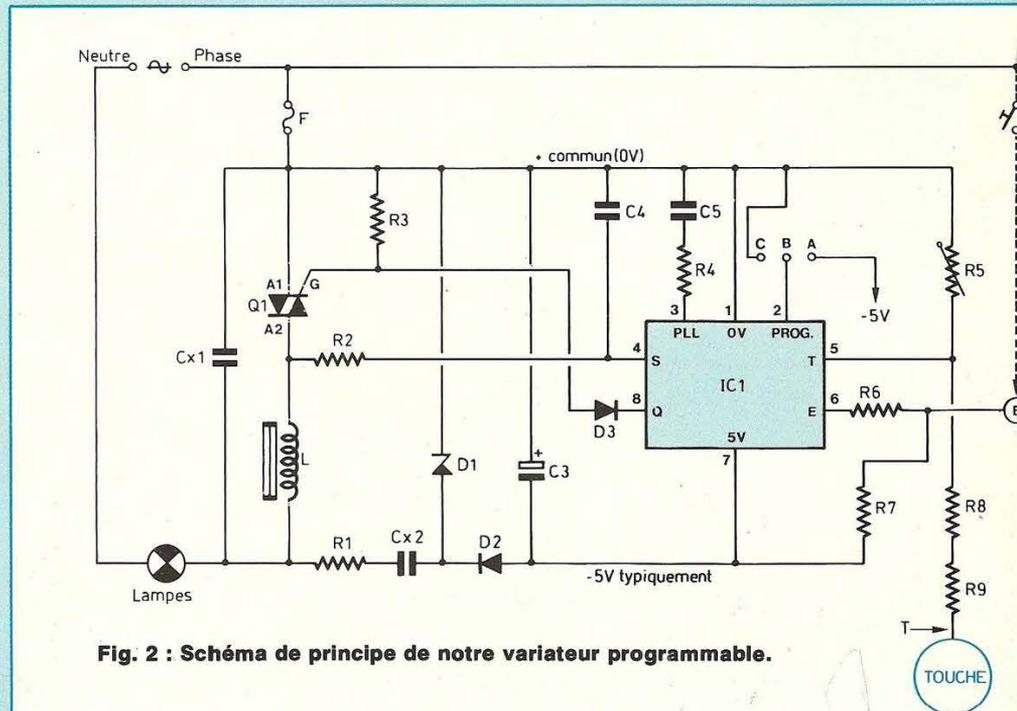
Fig. 2 : Schéma de principe de notre variateur programmable.
