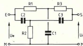
Si la condition  $R1C1 = R2C2$  est satisfaite, autrement dit pour  $f_{c1} = f_{c2}$ , le retard de phase introduit par le filtre passe-bas (R1-C1) est compensé par l'avance de phase apportée par le filtre passe-haut (R2-C2), la tension sortie est en concordance de phase avec la tension entrée.
