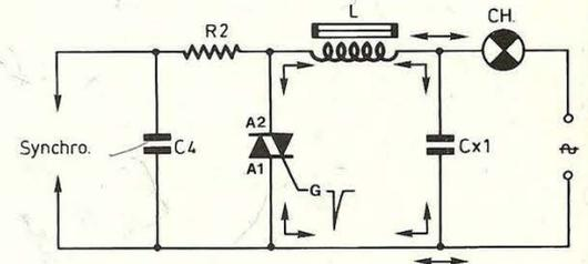
Fig. 3 : Schéma simplifié de la section critique "filtrage/synchronisation".
