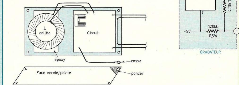
Fig. 8 : Suggestion pour coffret plastique à capot métallique.
