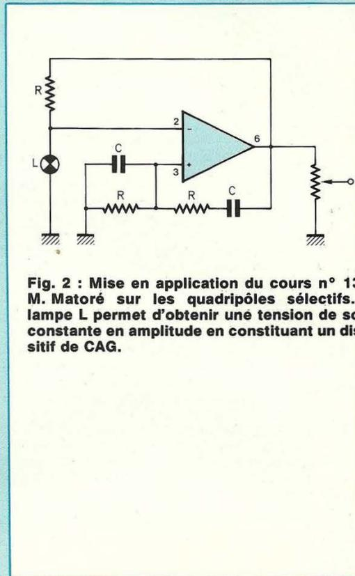
Fig. 2 : Mise en application du cours n° 13 M. Matoré sur les quadripôles sélectifs. la lampe L permet d'obtenir une tension de sortie constante en amplitude en constituant un dispositif de C.A.G.
