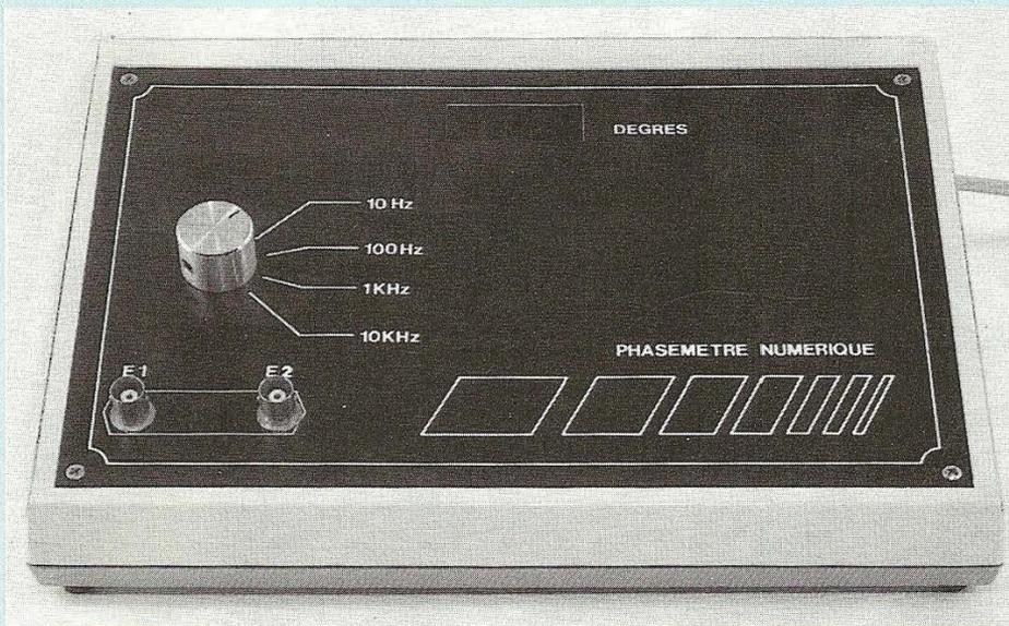
Ce montage s'adresse à tout électronicien désireux de connaître le déphasage entre deux tensions d'un simple coup d'oeil. Finies les manipulations des bases de temps et amplitudes de votre oscilloscope....
