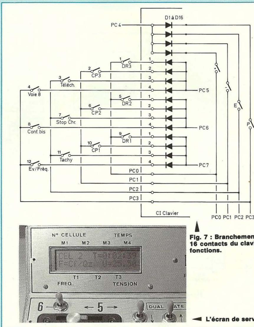
**Fig. 7 : Branchement des 16 contacts du clavier et fonctions.**
