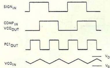
Fig. 3b : Formes typiques de signaux de la boucle à verrouillage de phase utilisant le comparateur de phase 1 verrouillé sur  $f_0$ .
