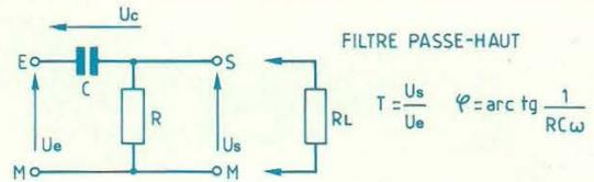
riel (construction de Fresnel - n° 67) des tensions présentes dans le dispositif, en concordance avec les tensions fléchées portées sur le schéma constitutif.
