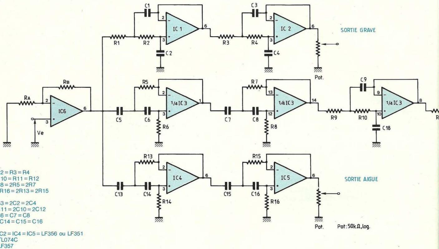
Fig. 3 : Schéma du filtre actif 3 voies 24 dB/octave.
