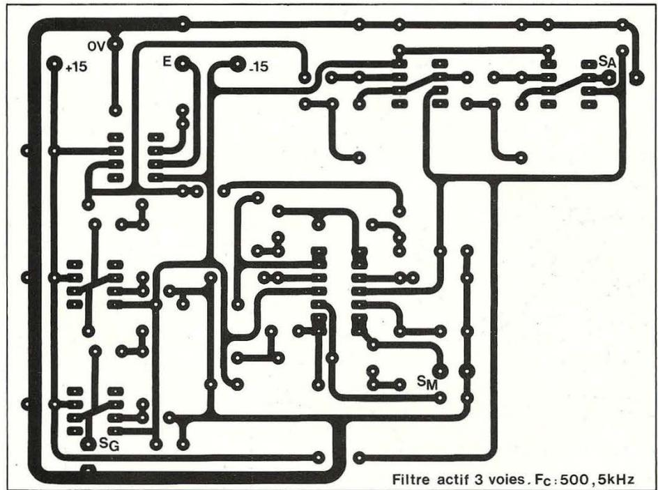
Filtere actif 3 voies.  $F_c : 500,5 \text{ kHz}$
