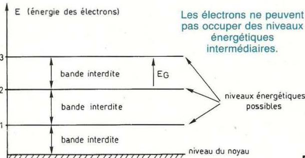
**Fig. 3 : Niveaux énergétiques possibles et bandes interdites.**
