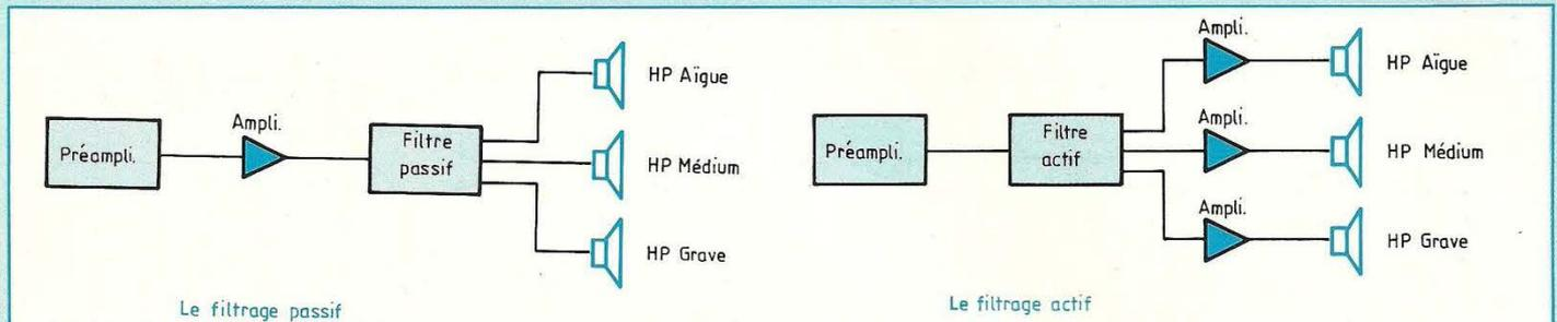
**Fig. 1 : Configurations actives et passives (3 voies).**
