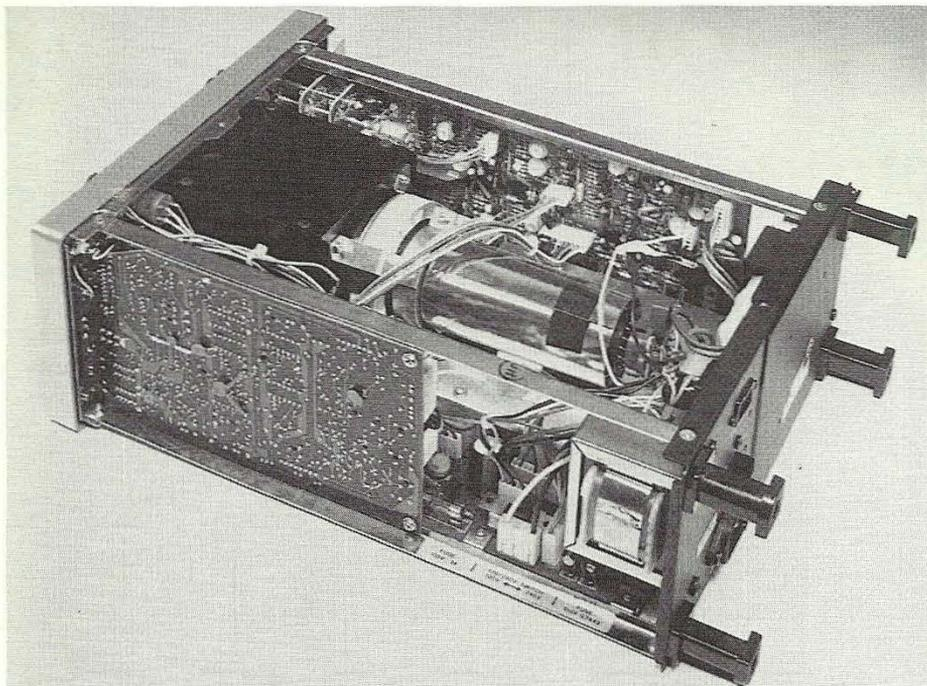
Vue intérieure : De part et d'autre du tube cathodique soigneusement blindé, prennent place les circuits d'amplification et de balayage. Au-dessous, un autre blindage enferme les circuits du convertisseur d'alimentation.
