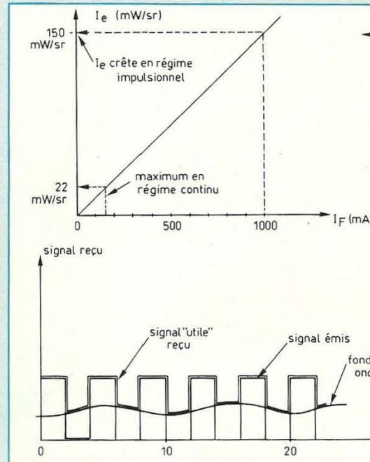
Fig. 5 : Intensité énergétique en fonction du courant direct.
