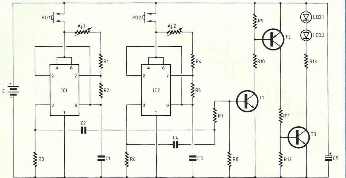
Fig. 8 : Schéma de l'émetteur.
