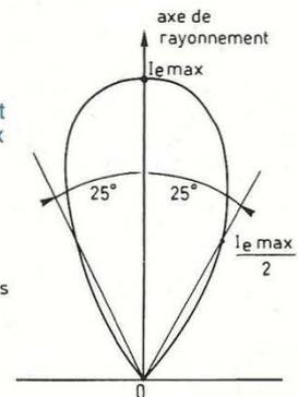
**Fig. 4 : Diagramme de rayonnement de la diode LD 271.**
