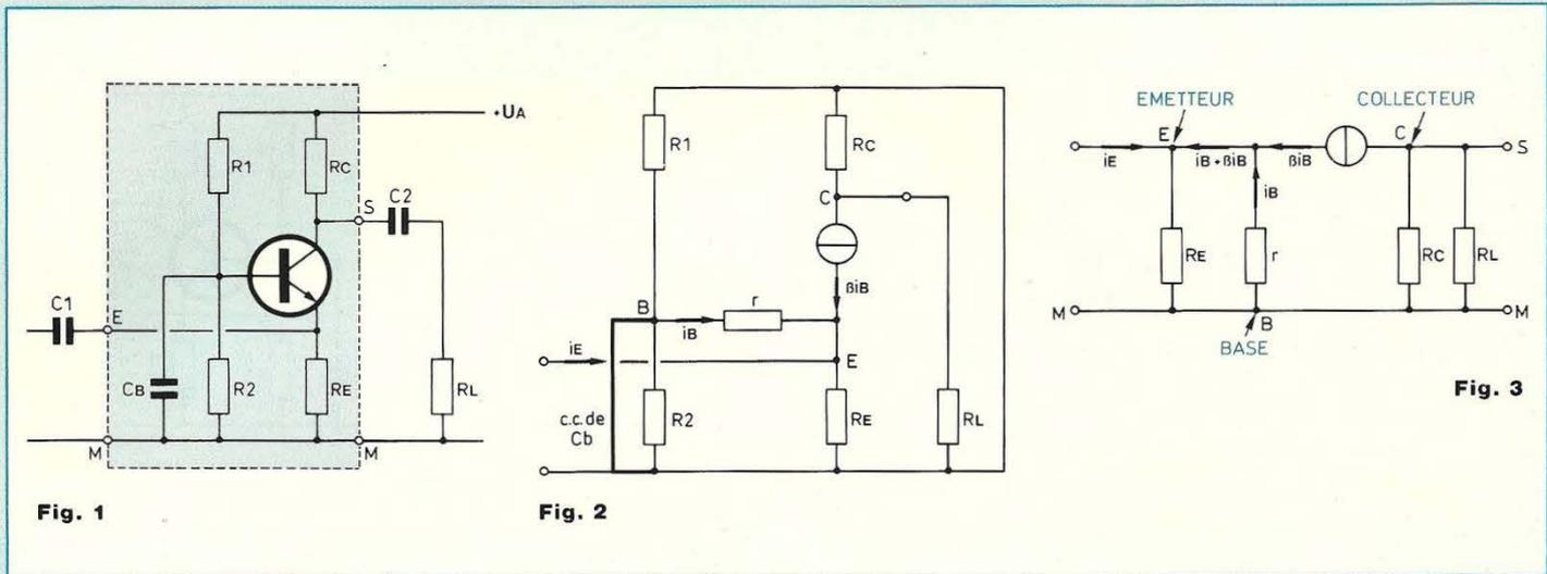
parcourt la résistance  $r$  de la base, y créant la chute de tension  $r i_B$  égale à la tension d'entrée  $u_E$ . Dans la résistance d'émetteur  $R_E$  passe la réunion du courant  $i_B$ , de son homologue  $\beta i_B$  et du courant  $i_E$  engendré par le signal dans la résistance  $R_E$ . La chute de tension dans  $R_E$ , qui est égale à la tension d'entrée  $u_E$ , est de signe algébrique opposé à celui de  $r i_B$ . Ecrivons :
