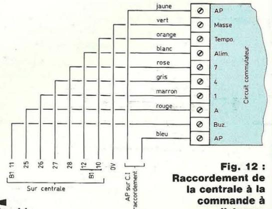
Fig. 12 : Raccordement de la centrale à la commande à distance.
