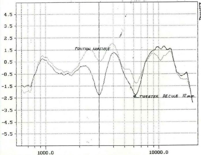
Fig. 6 : Comparaison tweeter reculé, non reculé.
