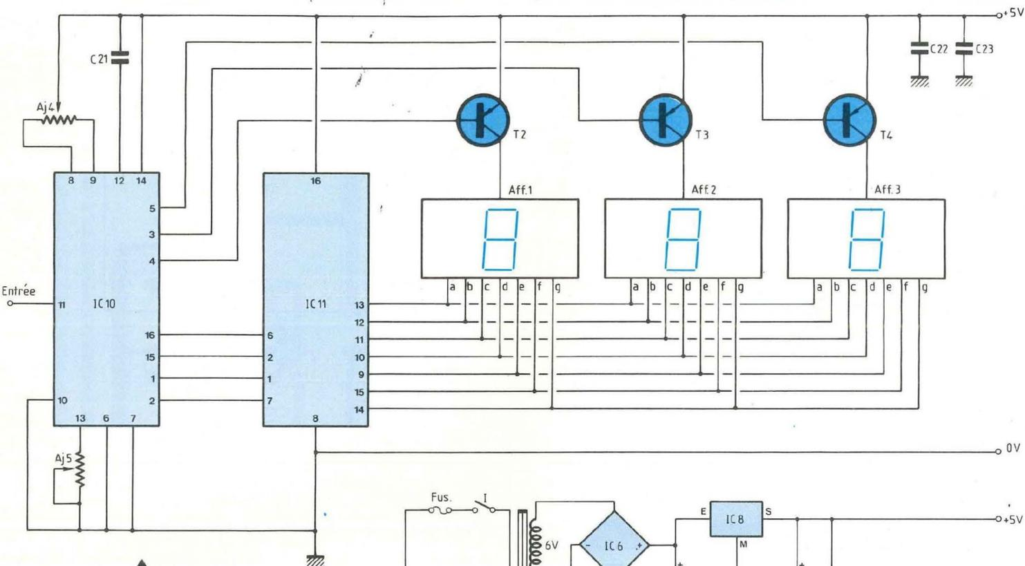
**Fig. 10 : Schéma de la section volt-mètre.**
