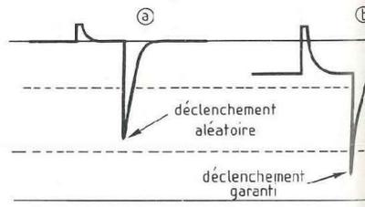
Fig. 12 : Déclenchement de la bascule.
