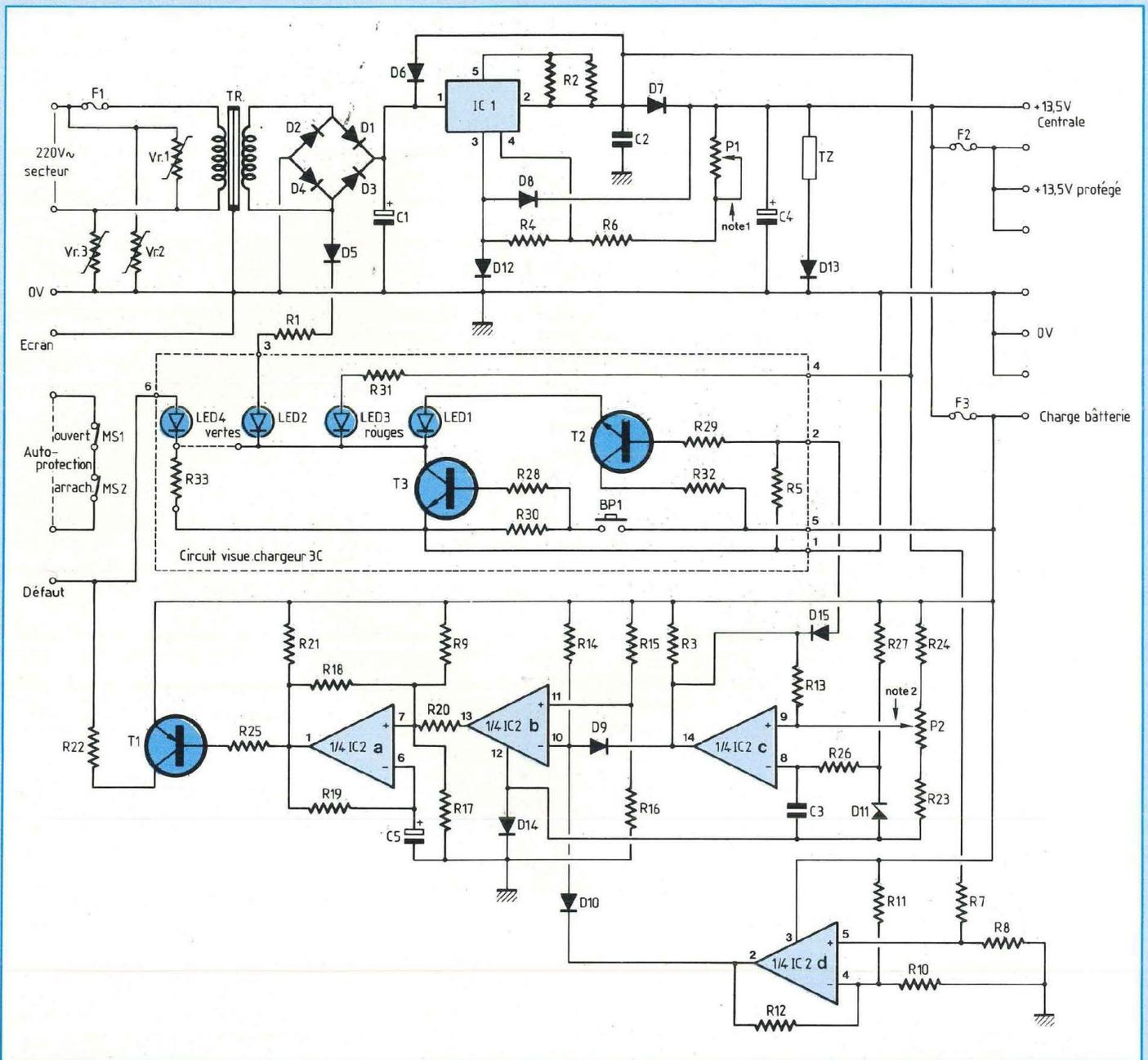
on obtiendra la valeur de R2 afin de limiter le courant fourni par l'alimentation. R2 sera raccordée entre les bornes 2 et 5 (comparateur interne du L 200). Pour un courant maximum de 1 A, le calcul donnera :
