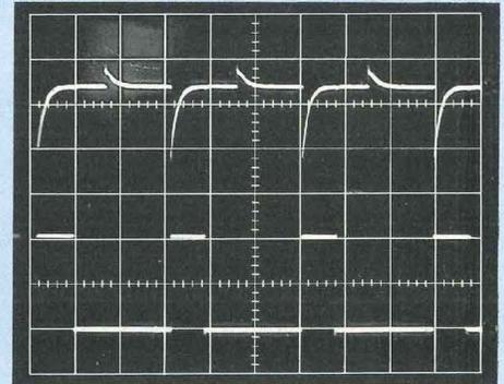
G. En haut, impulsions du canal E1. En bas, impulsions en sortie de la bascule RS, après réalignement au niveau zéro par le transistor T1 (5 V/division).
