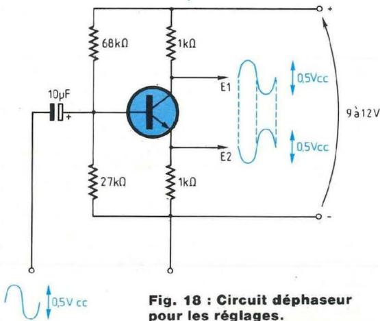
Fig. 18 : Circuit déphaseur pour les réglages.
