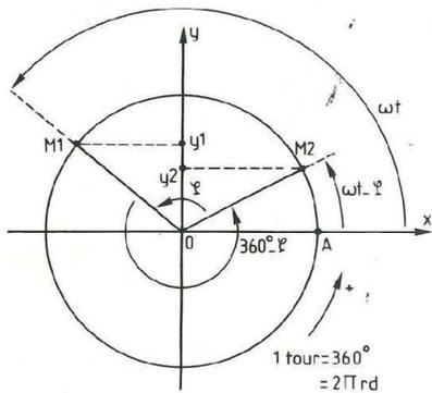
Fig. 3 : Déphasage sur le cercle trigonométrique.
