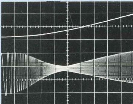
G. Etude d'un correcteur Baxandall par modulation en bande large, de 20 Hz à 20 kHz.
