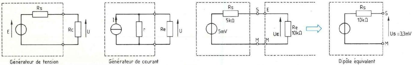
(générateur + quadripôle) est souvent différent de celui du quadripôle. Les écarts sont dus aux caractéristiques particulières à chacun des éléments assemblés. Les résistances d'entrée, tout comme les résistances de sortie, varient en fonction des fluctuations du signal traité, le coefficient d'amplification diminue avec la montée en fréquence du signal traité. Qu'à cela ne tienne, nous allons montrer un exemple typique, nous allons mener les calculs d'une chaîne amplificatrice.
