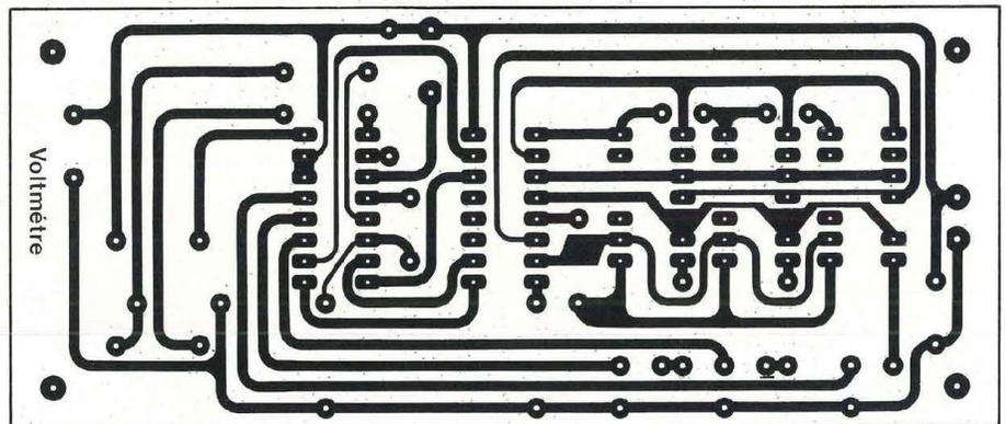
Fig. 15 : Circuit imprimé de la section voltmètre.
