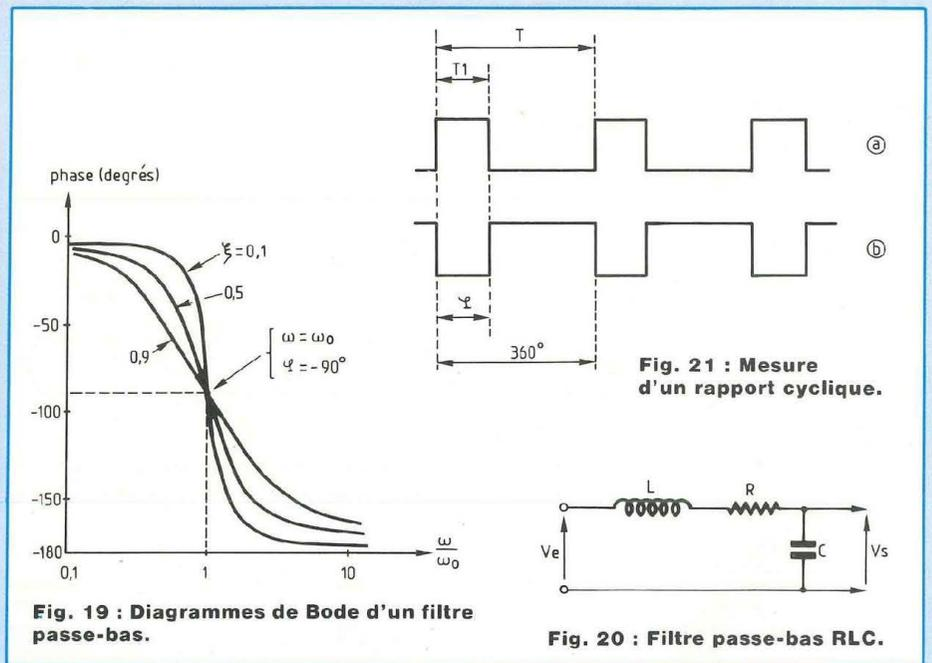
Fig. 19 : Diagrammes de Bode d'un filtre passe-bas.
