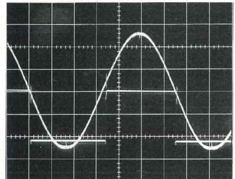
A. Réglage d'offset des entrées. Sinusoïde : 10 mV/division. Crêteaux : 2 V/division. La descente coïncide exactement avec le passage par zéro de la sinusoïde.
