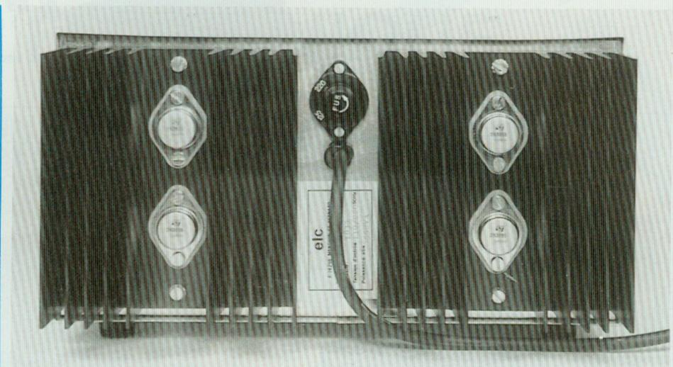
Au total, ondulation et bruit offrent une amplitude crête à crête de 4 mV, avec un peu moins de 3 mV pour l'ondulation et environ 1 mV pour le bruit. Là encore, ces résultats sont très bons.
