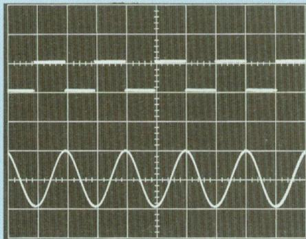
E. A 1 kHz, sortie TTL et sinusoïdes.
