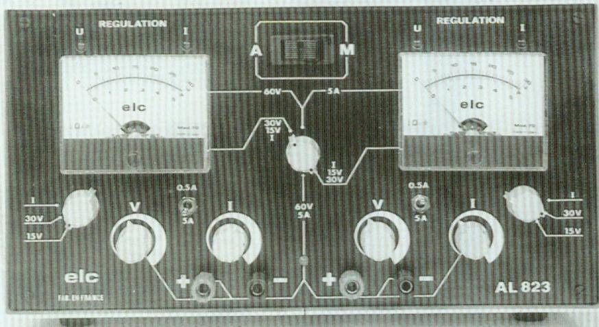
Pour l'amateur électronique occasionnel, l'équipement du laboratoire se satisfait d'une petite alimentation stabilisée réglable, à la plage de tensions et à l'intensité maximale relativement limitées. Le professionnel, et l'amateur averti, se montrent plus exigeants. Trois catégories de caractéristiques déterminent alors leur choix : la puissance (tensions et intensités élevées), la qualité de la régulation (statique et dynamique), et enfin l'universalité d'emploi.
