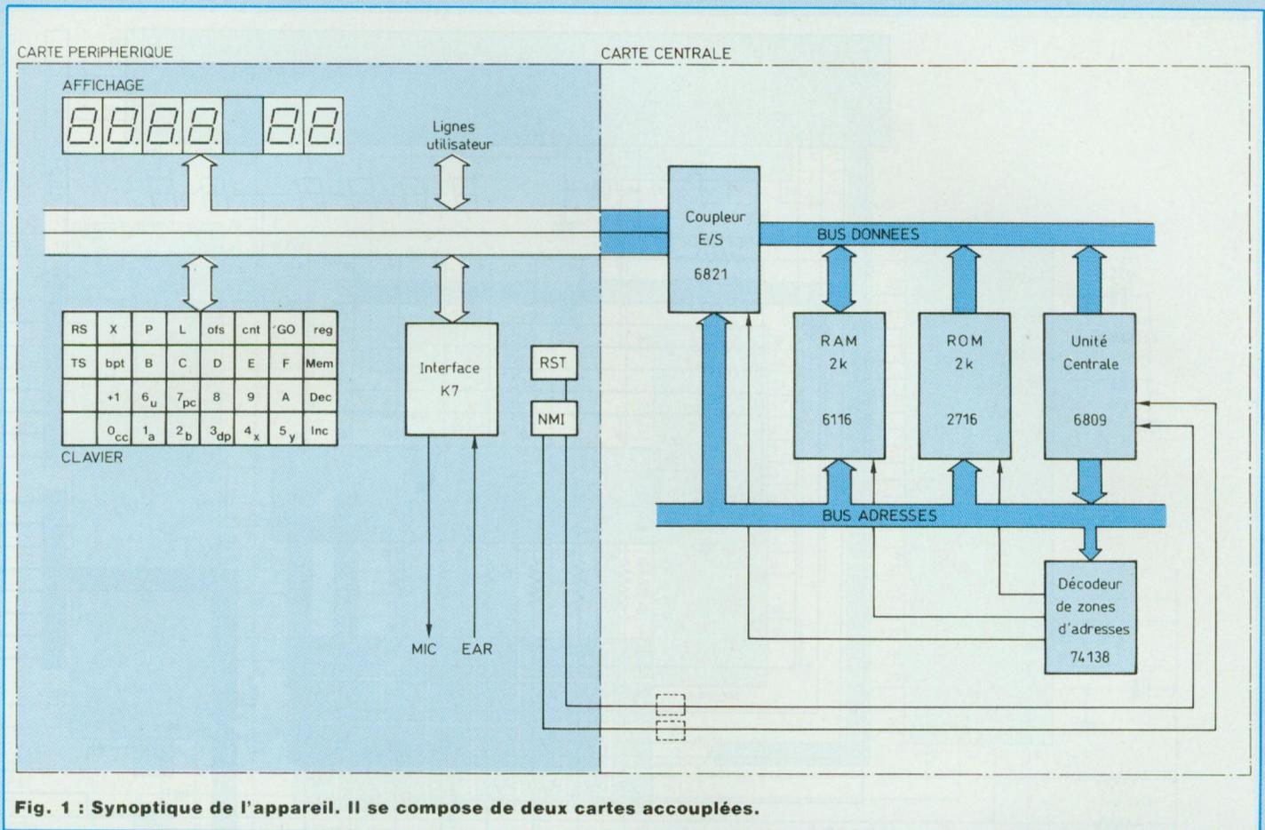
Fig. 1 : Synoptique de l'appareil. Il se compose de deux cartes accouplées.
