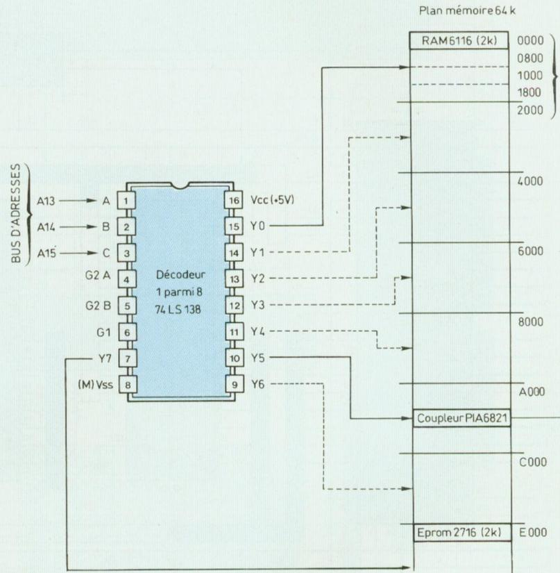
**Fig. 4 : Plan d'adresse réalisé par le Microkit 09.**
