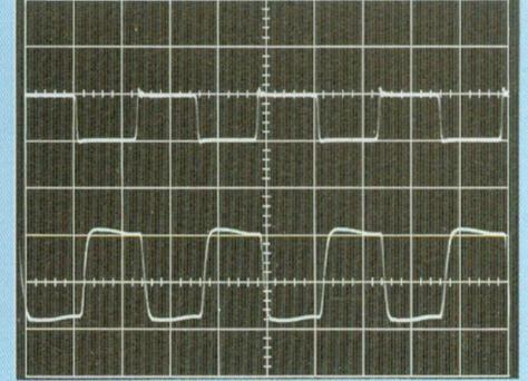
I. Comparaison, à 2 MHz, de la sortie TTL (en haut) et des créneaux de la sortie principale (en bas). Balayage : 200 ns/division.
