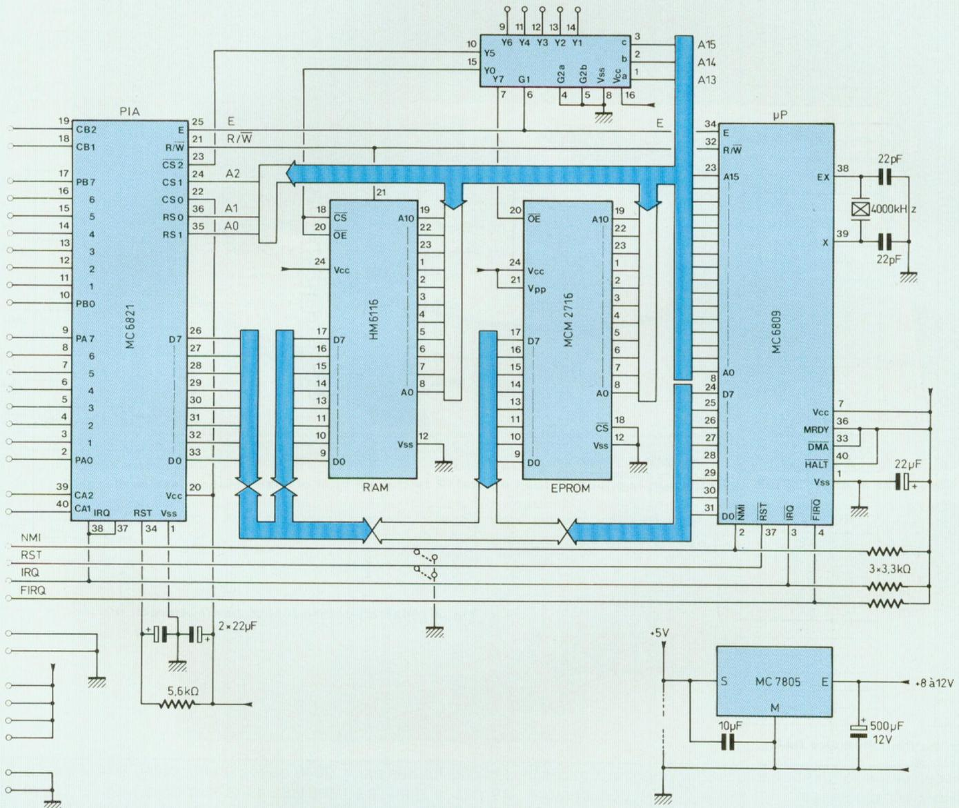
servent à enregistrer et à lire une zone mémoire sur une cassette magnétique (un vulgaire magnétophone cassette). Le bit 6, qui sert à enregistrer est presque directement relié vers la sortie ; il y a simplement un atténuateur de niveau. Le bit 7, qui est utilisé en lecture, provient d'un amplificateur (CA 3140) dont le coefficient d'amplification est de 100. Attention, ne changez
