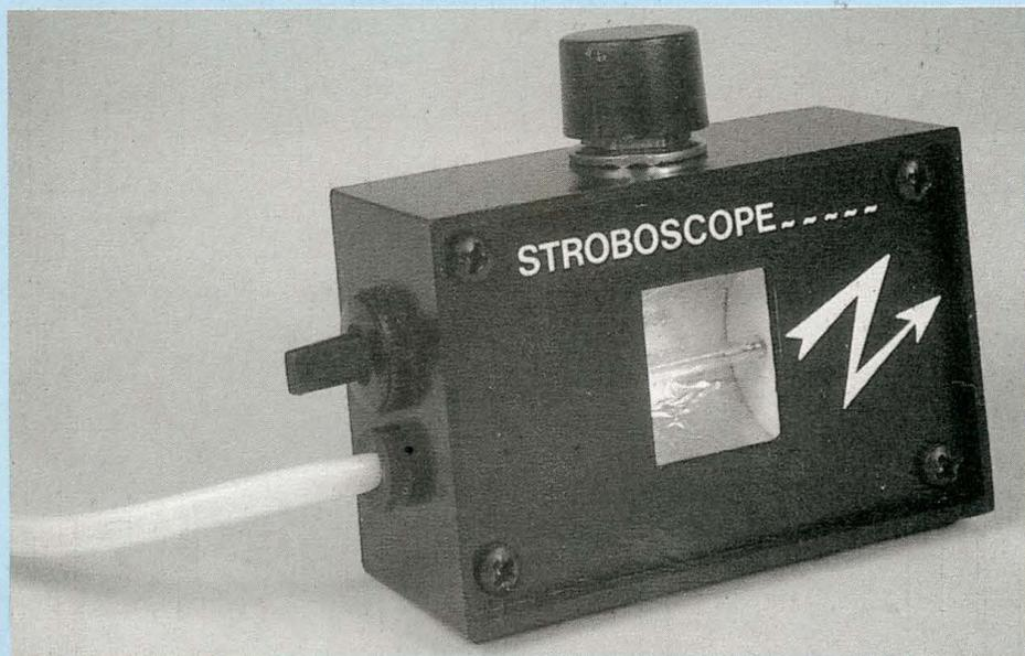
Une lampe, couramment nommée "tube à éclats", produit des flashes lumineux à une fréquence qui peut être réglée de 1 à 10 éclairs par seconde, par l'intermédiaire du potentiomètre P1. Chaque allumage est commandé par une impulsion de très haute tension, délivrée par un transformateur appelé "bobine d'impulsion". Le primaire de ce transformateur est lui-même commandé par la charge et la décharge d'un condensateur au travers d'une petite lampe au néon.
