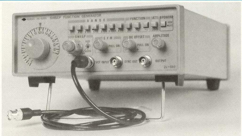
Maximum 10 V en circuit ouvert,  $\pm 5$  V sur 50 ohms.
