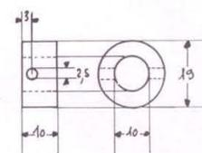
Fig. 14 : Pièce X. PVC gris  $\varnothing$  26 (x1) échelle 1/2.
