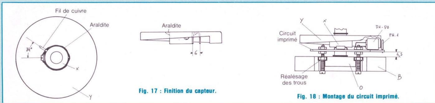
Fig. 17 : Finition du capteur.
