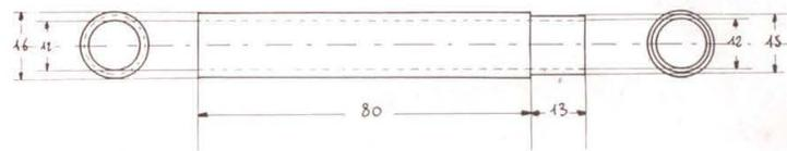
Fig. 4 : Pièce D, PVC gris  $\varnothing$  26 ( $\times$  1) échelle 1/2.
