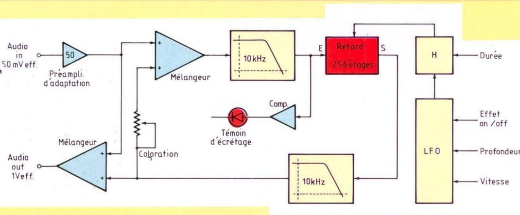
◀ Fig. 1 : Schéma fonctionnel de la pédale flanger.
