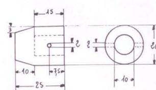
Fig. 12 : Pièce T. Rond laiton  $\varnothing$  20 (x1) échelle 1/2.
