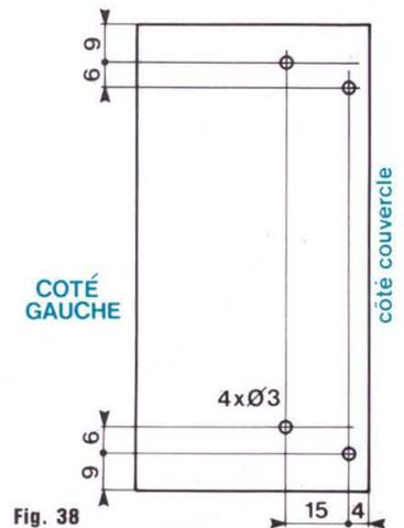
la figure (35) pour ce qui concerne le fond. Les deux trous de  $\varnothing 10$  mm permettent de laisser passer les extrémités du support plastique du circuit imprimé de l'automate programmable. Les trous de  $\varnothing 3$  à chaque coin per-
