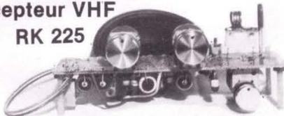
Couvre de 70 à 200 MHz par selfs interchangeables très faciles à réaliser, sensibilité élevée (1.μV). Stabilité parfaite, montage à 2 transistors et 1 circuit intégré, recherche des stations par varicap, circuit imprimé fourni, livret très détaillé.
