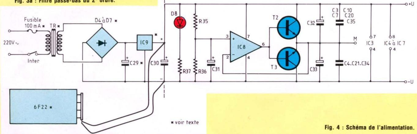
Fig. 4 : Schéma de l'alimentation.
