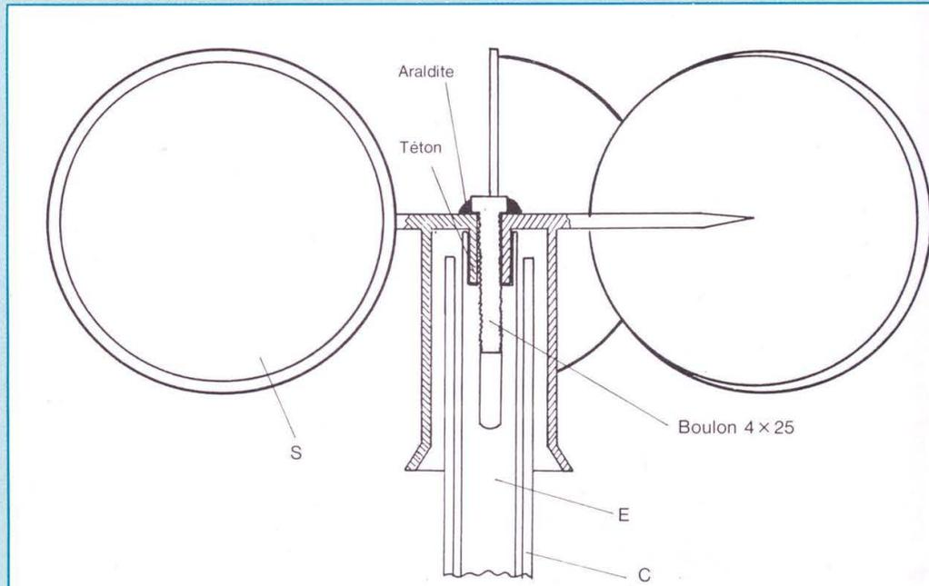
Fig. 11 : Montage du moulinet. Fixation vue en coupe.
