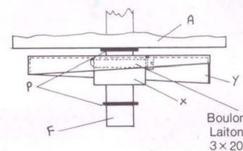
Fig. 16 : Assemblage d'une partie du capteur de la girouette.
