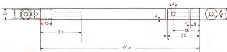
Fig. 6 : Pièce F (girouette) rond laiton  $\varnothing$  10 mm ( $\times$  1) échelle 1/2.
