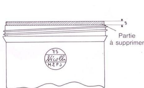
Fig. 7 : Préparation des pièces G et G'.
