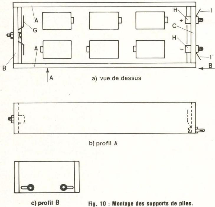
Fig. 10 : Montage des supports de piles.
