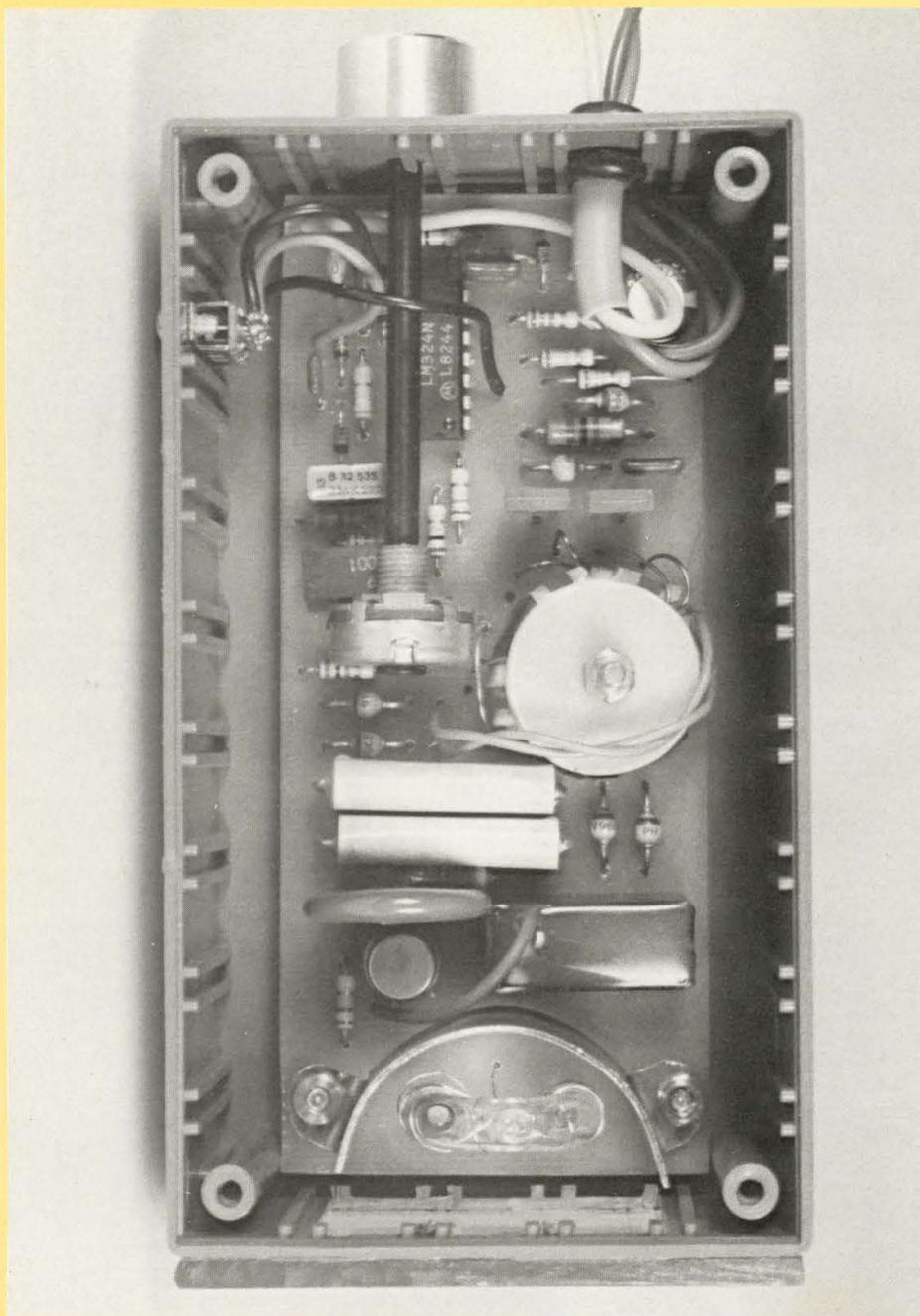
Nonobstant les nombreux schémas de réalisation de stroboscope déjà parus. L'instrument décrit ci-après présente l'intérêt d'être vraiment compact permettant de le loger dans une trousse à outils.
