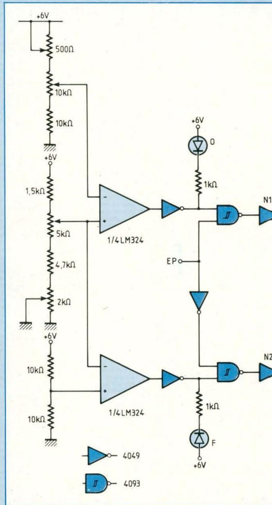
tension seront de type buffer. Enfin, il ressort déjà de ce montage que pour une tension d'alimentation de 6 V, la consommation en ouverture/fermeture est de 36 mA et de 8 mA à l'arrêt.
