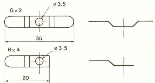
Fig. 9 : Façonnage des contacts de piles.
