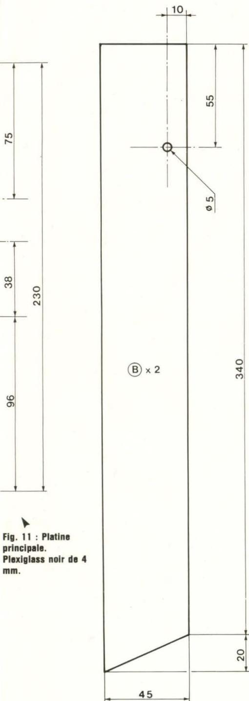
Fig. 11 : Platine principale. Plexiglass noir de 4 mm.
