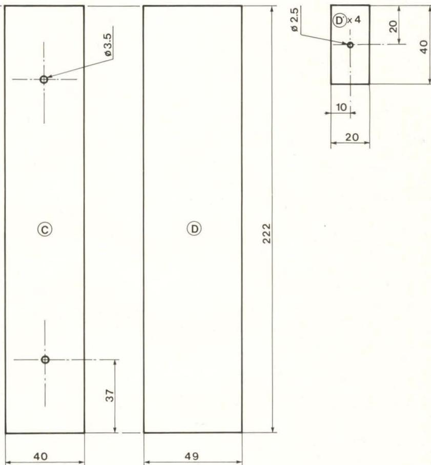
Fig. 12(a) : Eléments inférieurs du châssis. Plexiglass noir ép. 4 mm.
