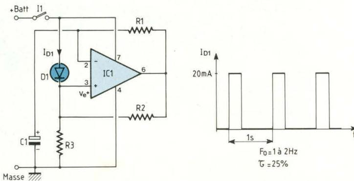
Fig. 2 : Astable à ampli opérationnel et chronogramme de fonctionnement.
