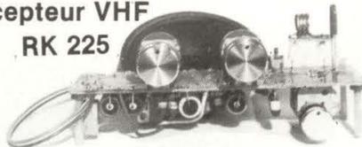
Couvre de 70 à 200 MHz par selfs interchangeables très faciles à réaliser, sensibilité élevée (1.µV). Stabilité parfaite, montage à 2 transistors et 1 circuit intégré, recherche des stations par varicap, circuit imprimé fourni, livret très détaillé.
