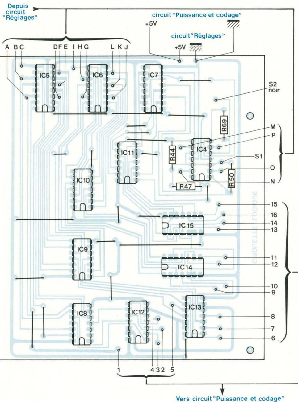
Fig. 14 : Circuit "logique". Implantation des composants.
