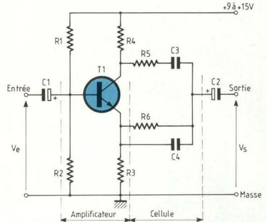
Fig. 2 : Schéma structurel du filtre réjecteur.
