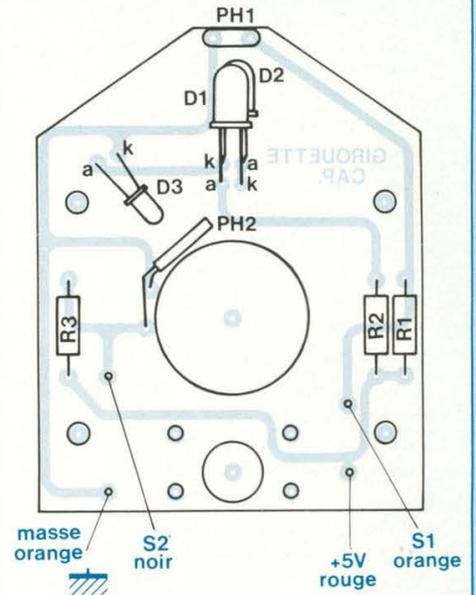
Fig. 11 : Circuit "capteurs". Implantation des composants.
