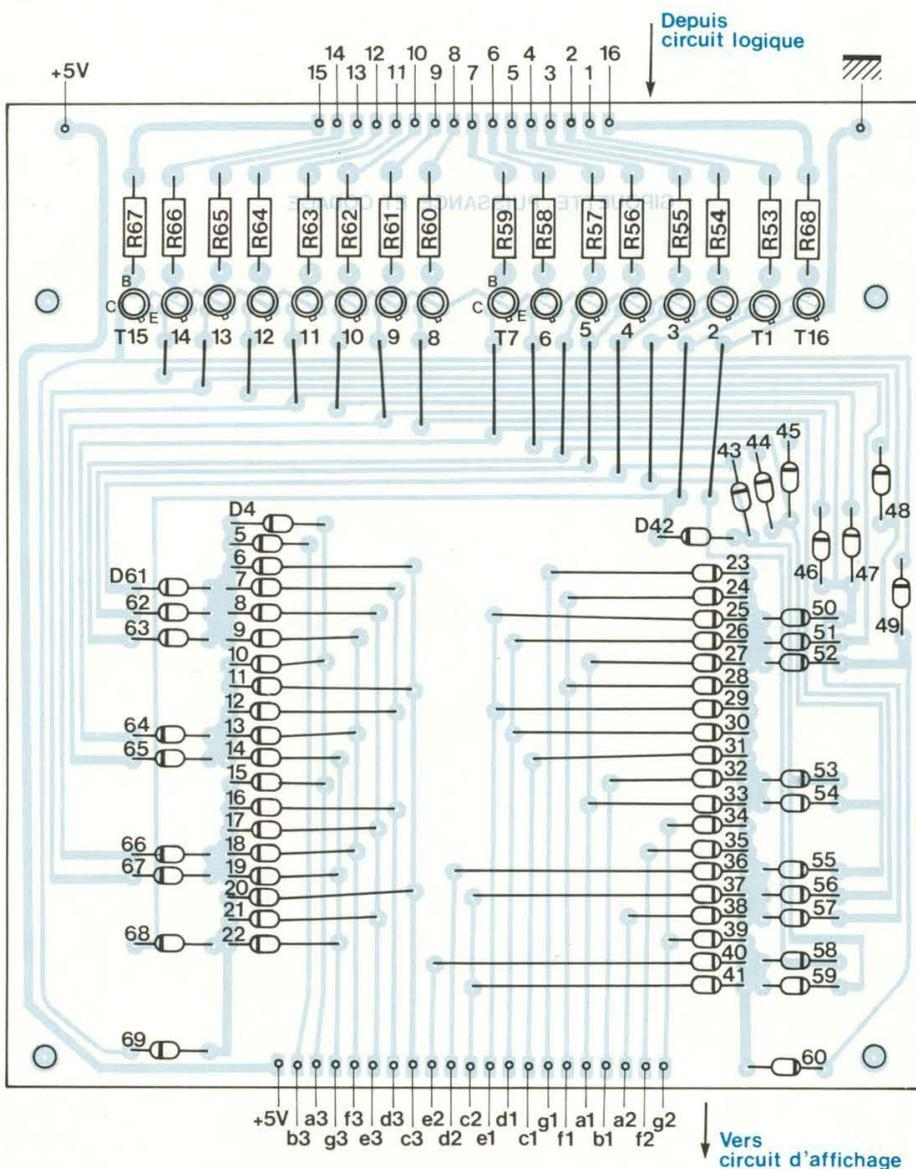
Fig. 13 : Circuit de puissance et de codage. Implantation des composants.
