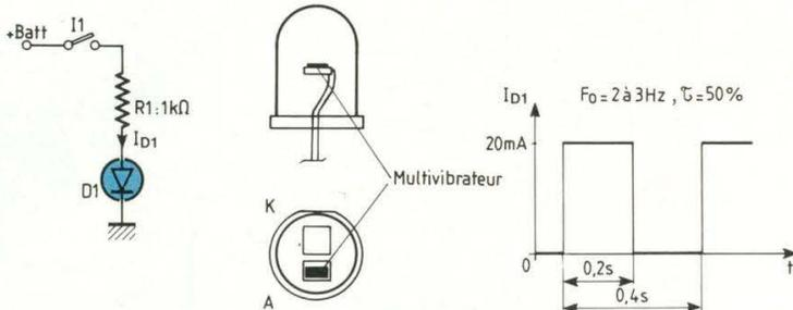
Fig. 1 : Utilisation d'une diode clignotante rouge.
