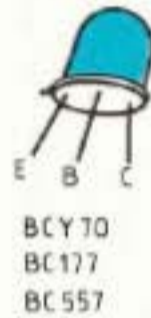
Fig. 11 : Branchement des différents composants entrant dans la fabrication de la clôture électronique.
