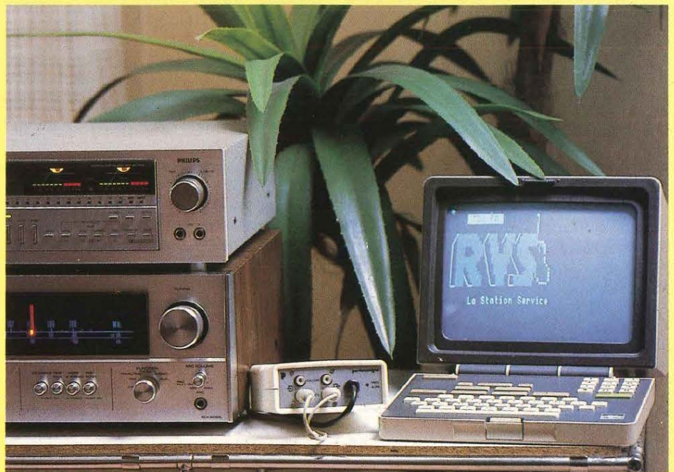
Fig. 1 : Le décodeur DBR, de Portenseigne — que l'on remarque en position centrale — permet de visualiser sur l'écran d'un Minitel (ou d'un moniteur couleur) les informations (graphiques et textes) émises par les stations radio FM équipées du système Radiovision.
