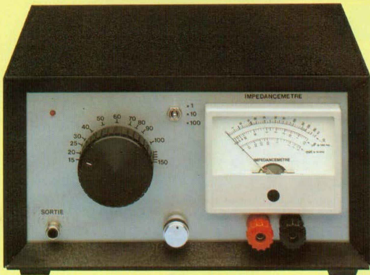
entre 10 mV et 3 V. La lecture s'effectuant en alternatif, entre 15 Hz et 15 kHz environ, il suffit de lire le signal de sortie à l'aide d'un voltmètre audio.
