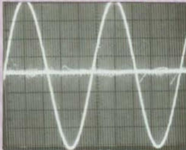
A. Distorsion inférieure à 0,03 % et noyée dans le bruit.
