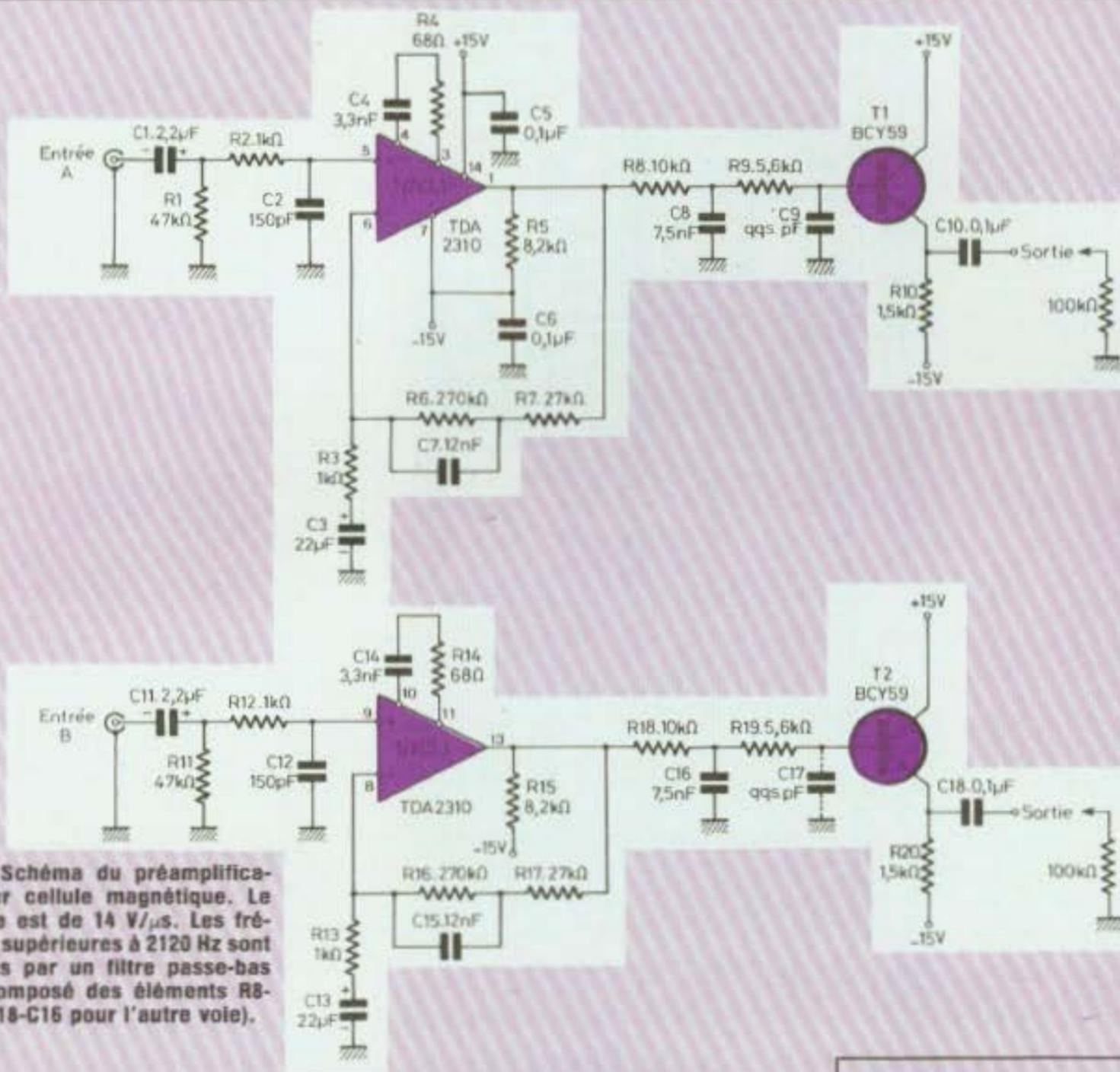
Fig. 6 : Schéma du préamplificateur pour cellule magnétique. Le slew-rate est de 14 V/µs. Les fréquences supérieures à 2120 Hz sont atténuées par un filtre passe-bas passif composé des éléments R8-C8 (ou R18-C16 pour l'autre voie).
