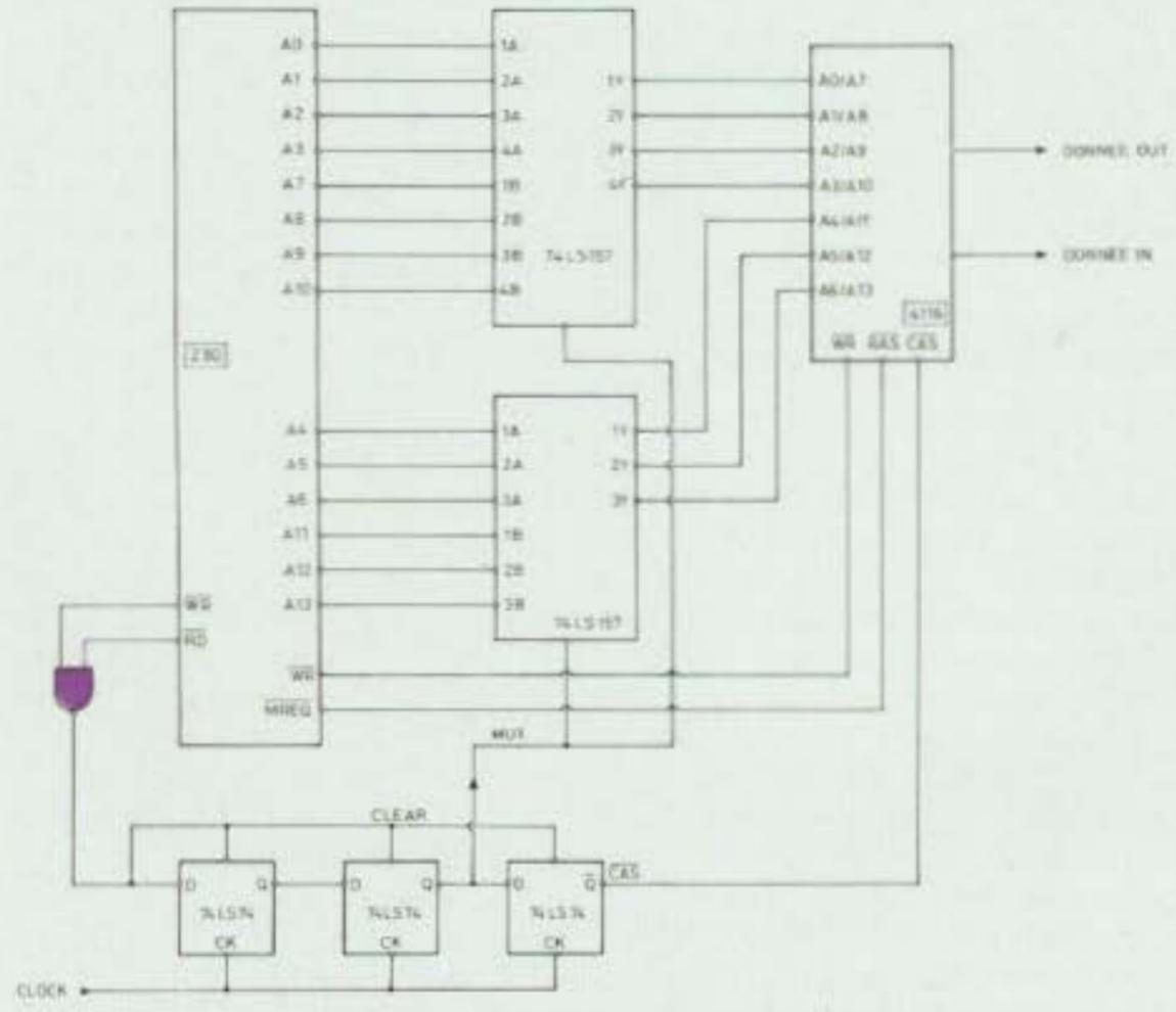
Fig. 4. Liaison Z80 mémoire dynamique schéma simplifié.
