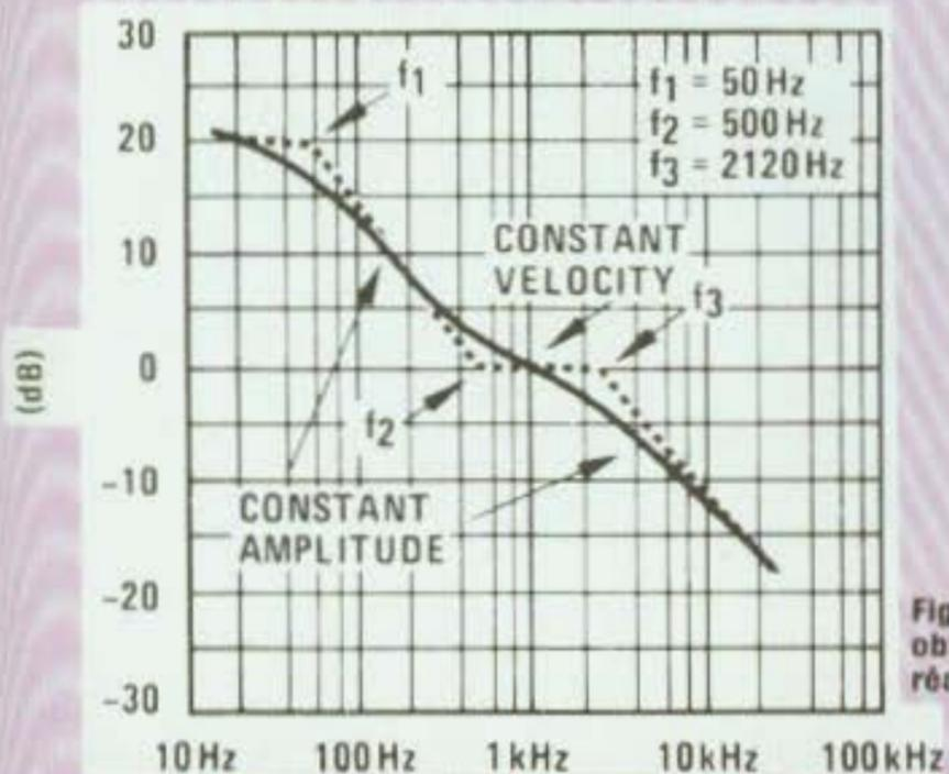
Fig. 7 : Courbe que l'on doit obtenir avec la contre-réaction RIAA.
