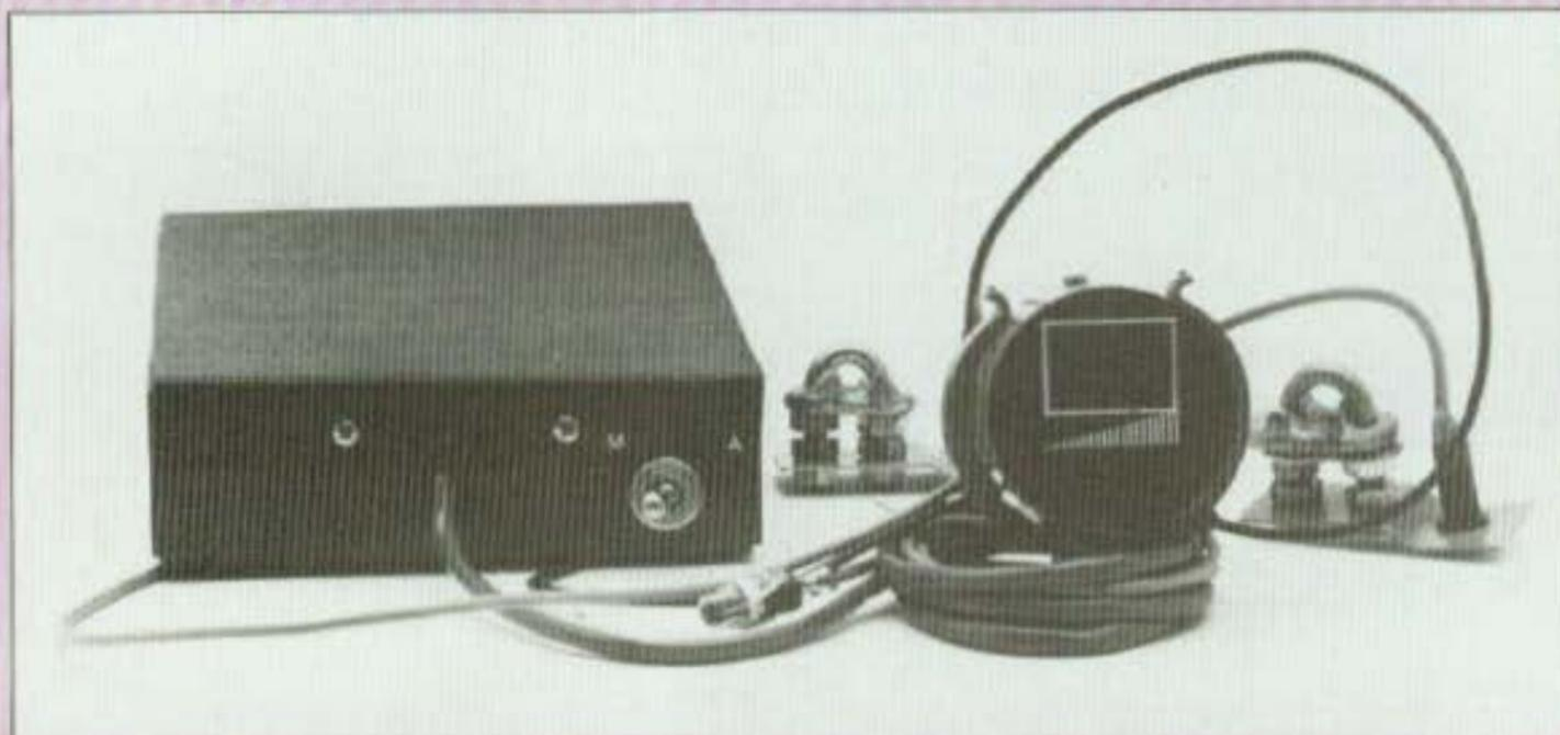
**L**e montage permet de lire sur 2 afficheurs 7 segments la vitesse en kilomètres/heure ou la distance parcourue en kilomètres pour bicyclette avec roues de 680 ou 610 mm.
