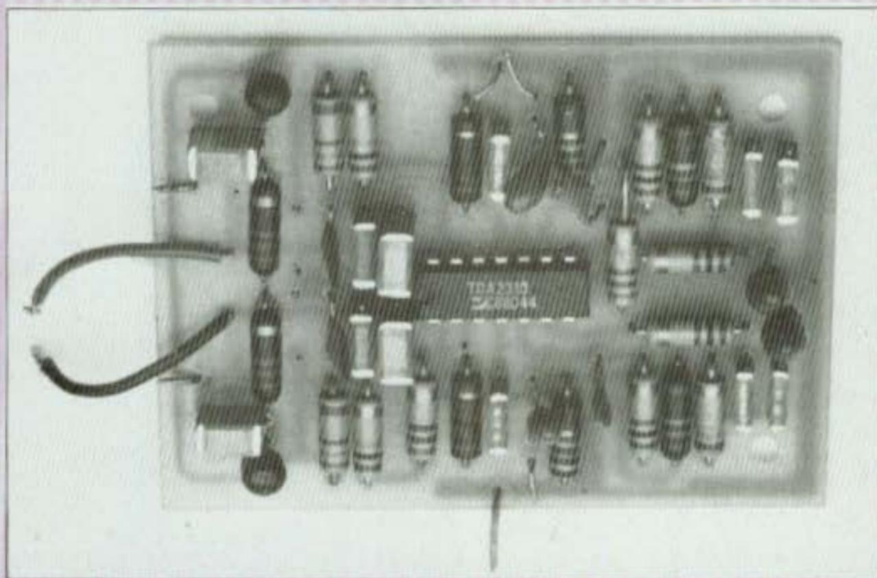
Le préamplificateur pour cellule magnétique peut être câblé avec des résistances 1/4 W ou 1/2 W. Il est recommandé d'utiliser des résistances à courbe métallique.
