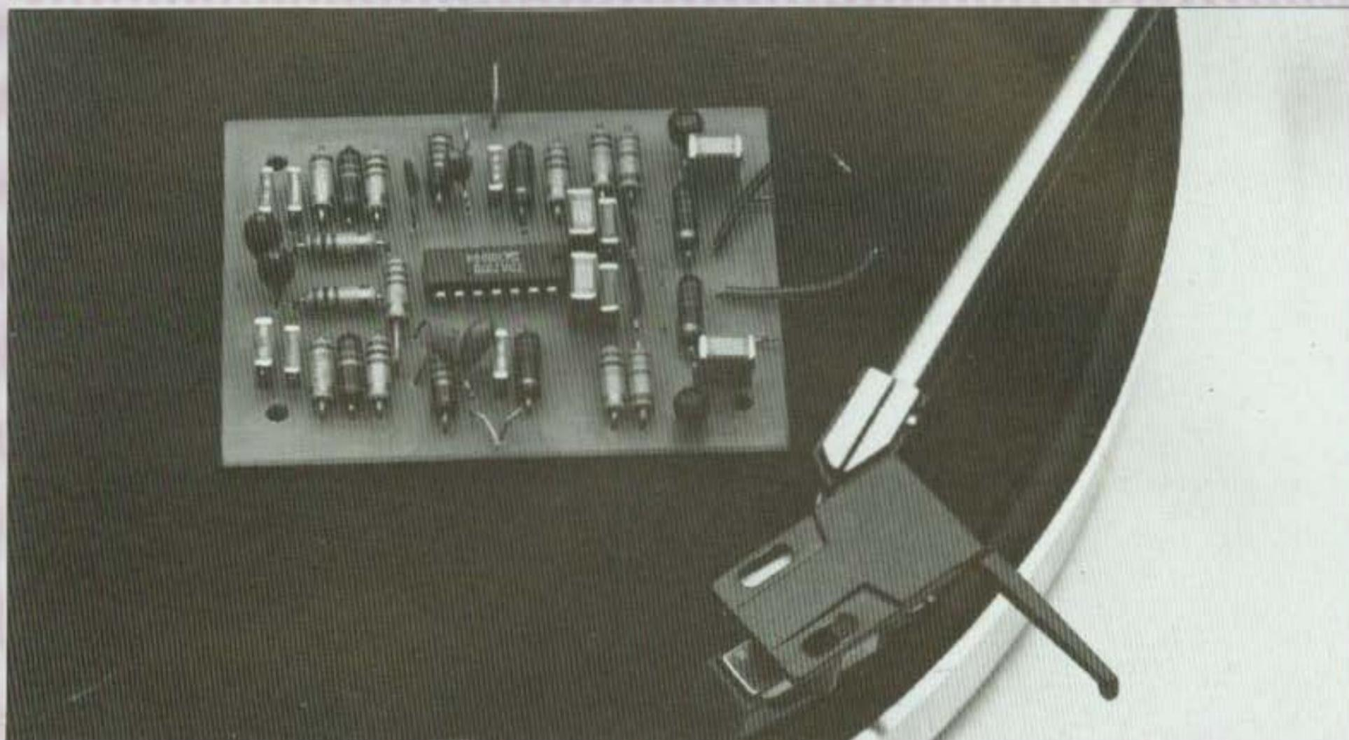
cellule magnétique sont appliqués à l'entrée non inverseuse (+) du TDA 2310, broche 5, par un électrochimique de  $2,2 \mu\text{F}$ . On trouve la classique résistance de charge de  $47 \text{ k}\Omega$  qui est la valeur recommandée par la plupart des fabricants de cellules. Le réseau R2-C2 forme un filtre passe-bas qui élimine les fréquences radio, toujours gênantes sur les amplificateurs hifi en position PU.
