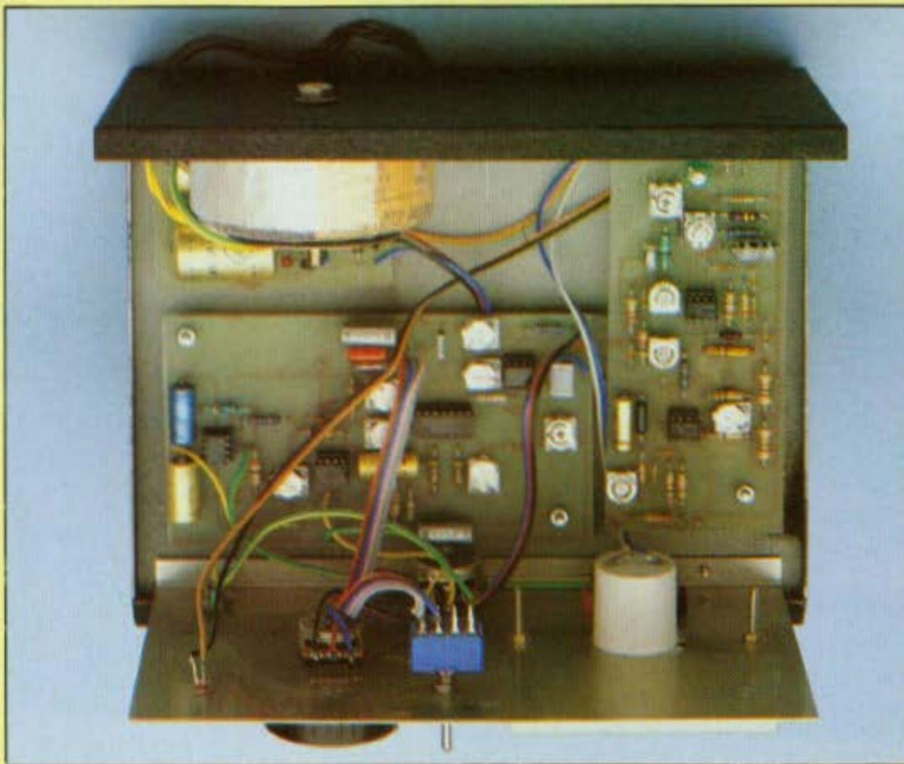
Le transformateur toroïdal est fixé verticalement à l'arrière du coffret pour minimiser tout risque de rayonnement. Les interconnexions entre les platines se font avec du fil de câblage ordinaire.
