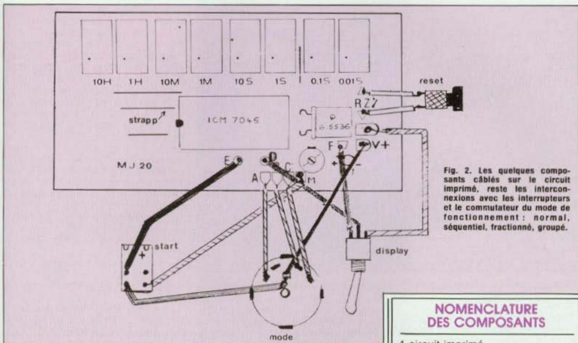
Fig. 2. Les quelques composants câblés sur le circuit imprimé, reste les interconnexions avec les interrupteurs et le commutateur du mode de fonctionnement : normal, séquentiel, fractionné, groupé.
