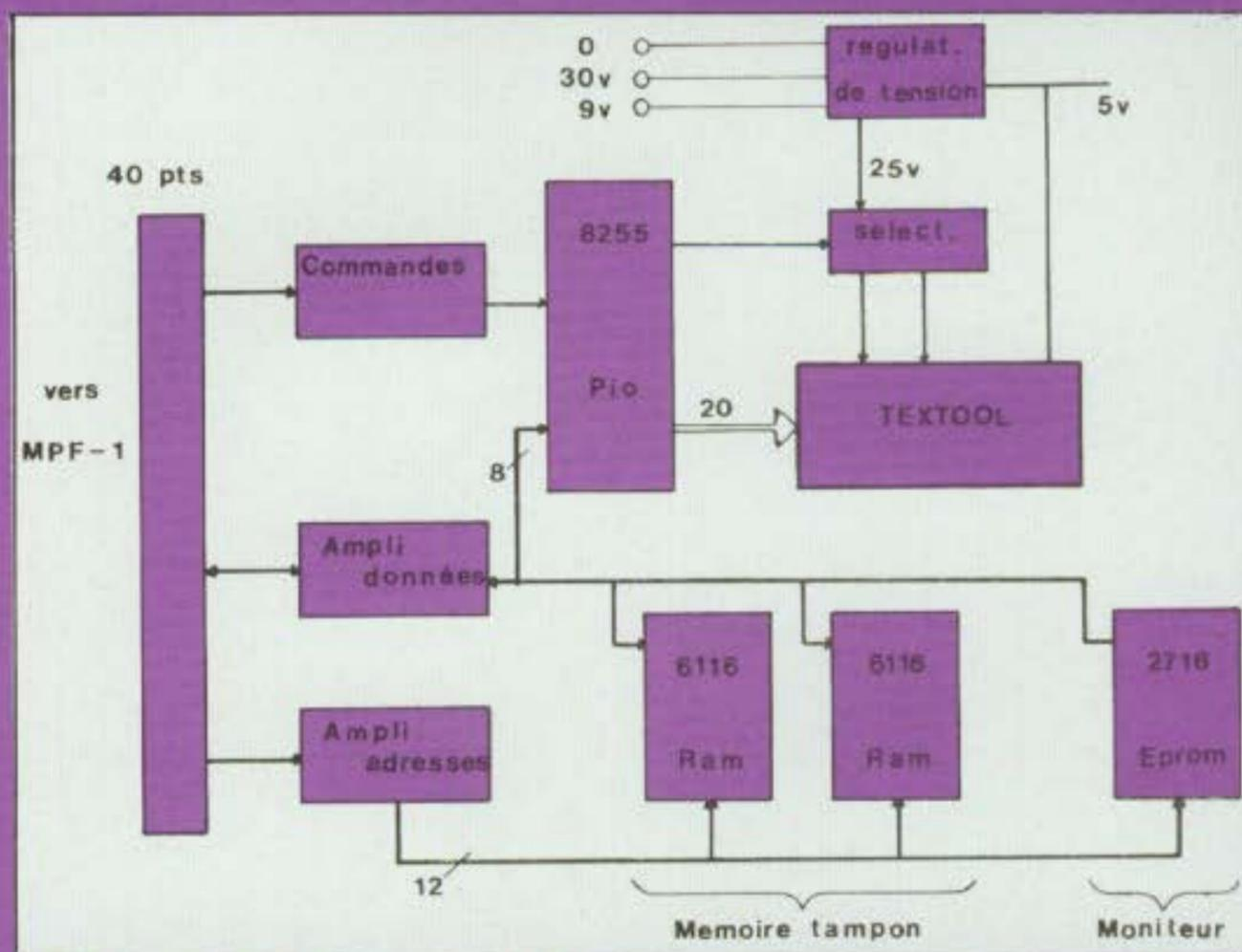
Fig. 5. Synoptique du programmeur EPB-MPF.
