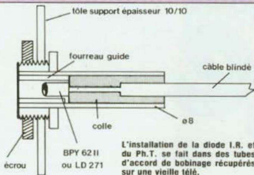
L'installation de la diode I.R. et du Ph.T. se fait dans des tubes d'accord de bobinage récupérés sur une vieille télé.
