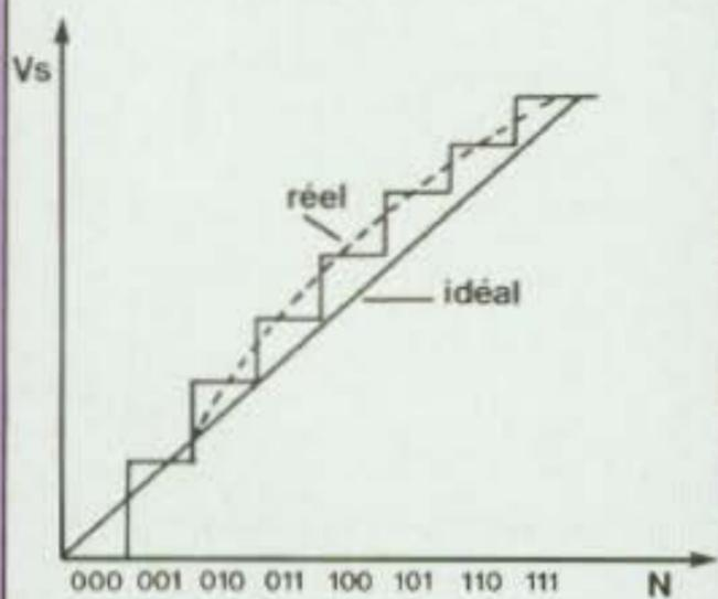
identiques. De ce fait, il est nécessaire d'utiliser une unique tension de référence appliquée aux résistances au moyen d'interrupteurs CMOS (CD 4066 ou autres...), car la tension de sortie des circuits TTL/LS souffre d'une trop grande dispersion pour cette application. D'un principe analogue, le convertisseur en échelle (fig. 6), rappelle par la configuration du réseau de résistance R-2R, le montage décrit en figure 1.
