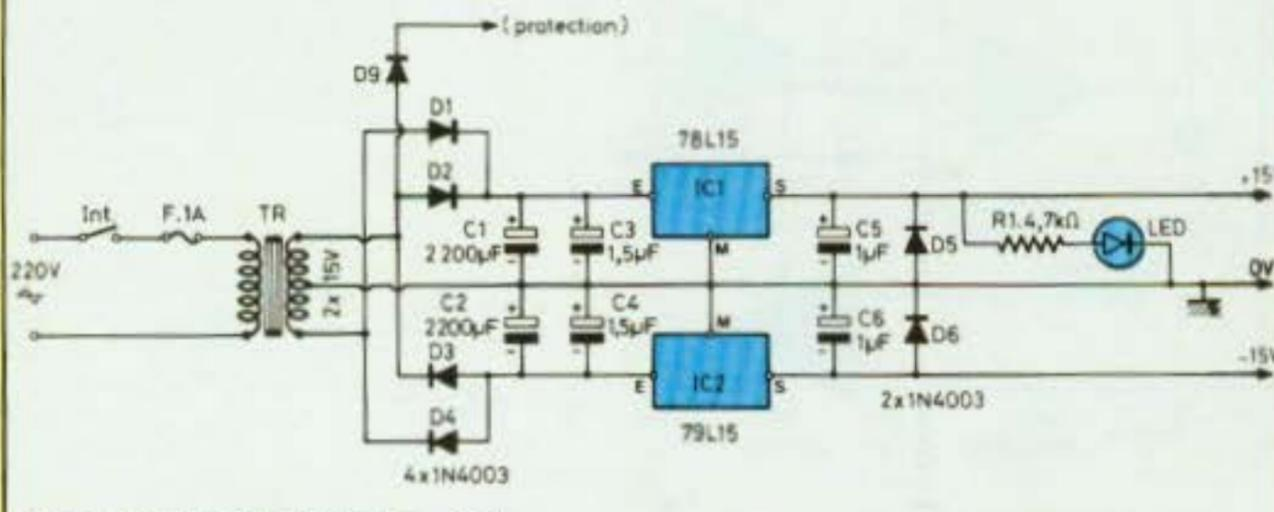
Fig. 9. Alimentation régulée  $\pm 15$  V.
