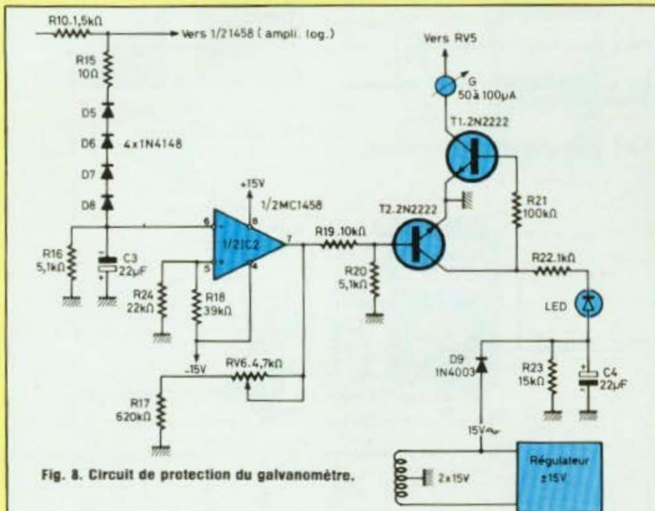
Fig. 8. Circuit de protection du galvanomètre.
