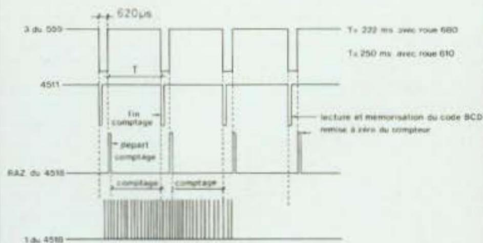
Oscillogramme du compteur de vitesse. La période T est de 222 ms avec une roue de 680 et de 250 ms avec une roue de 610.
