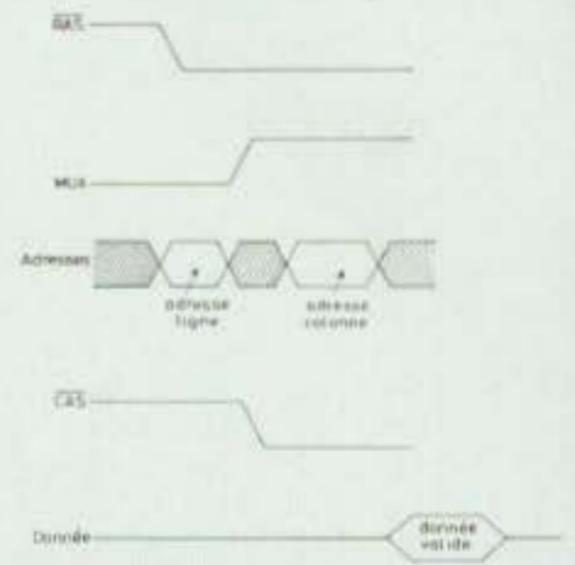
Fig. 3. Diagramme des temps d'une RAM 4116 en cycle lecture.
