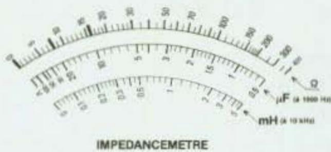
Fig. 10 : L'échelle en ohms, en microfarads et en millihenry est représentée à l'échelle 1. Cette figure peut être découpée et collée sur le galvanomètre, sachant que le modèle utilisé est un magnéto-électrique (classe 2,5) aux dimensions de 80 x 63 mm.
