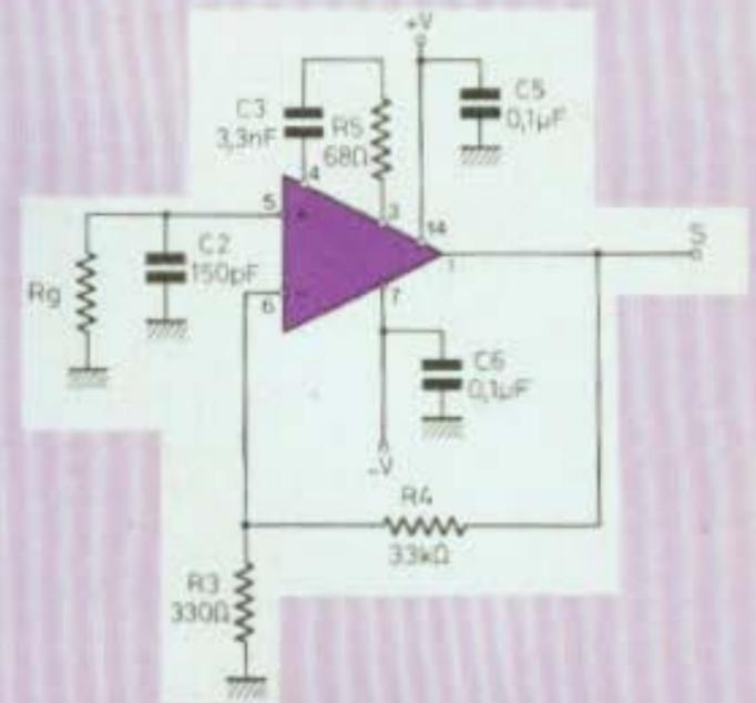
Fig. 2 : Circuit test pour la mesure du bruit.
