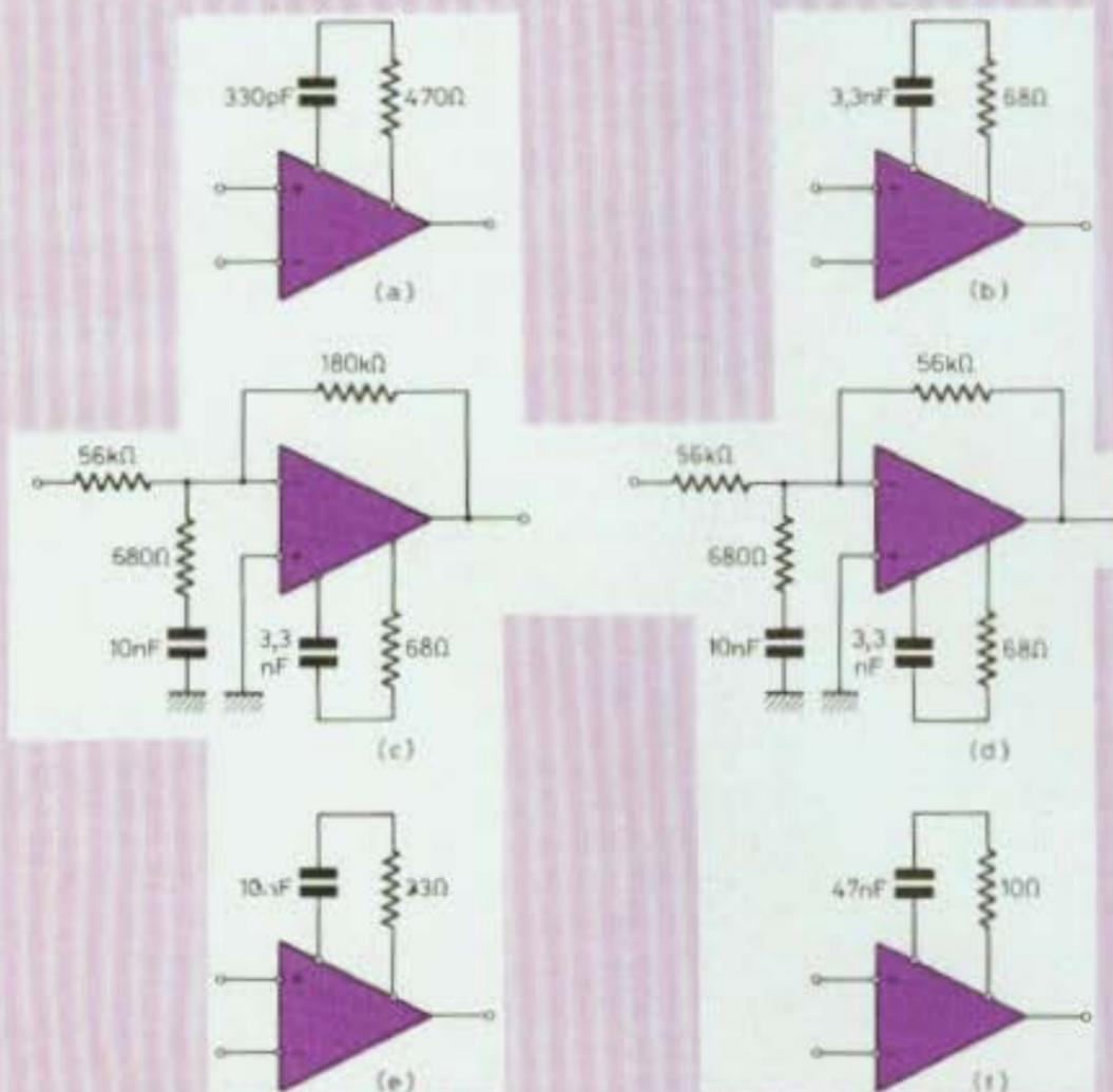
Fig. 5 : Le slew-rate dépend du réseau de compensation en fréquence, il peut être fixé entre  $2 \text{ V}/\mu\text{s}$  et  $70 \text{ V}/\mu\text{s}$ .
