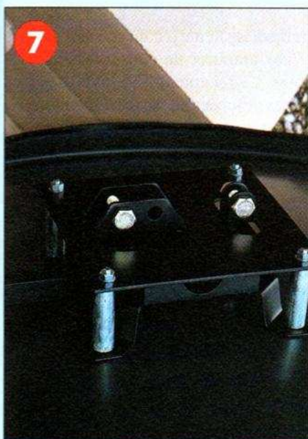
7 Une plaque a été ajoutée à la fixation normale de la parabole, elle est fixée sur quatre entretoises...
