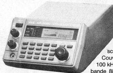
**AR-3000 – AOR** – Récepteur scanner AM/FM/SSB. Couvrant la gamme de 100 kHz à 2036 MHz (sauf bande 88 à 108 MHz). 4 fois 100 mémoires. Alim. 220 V ou 13 V. Dimensions : 138 x 80 x 200 mm.
