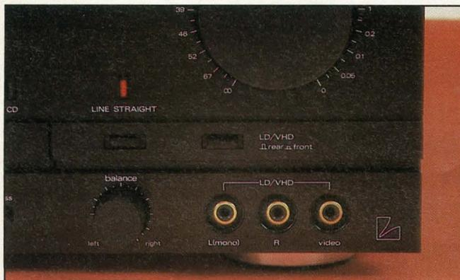
*Luxman : des prises en façade pour l'entrée d'un signal venu d'une source vidéo, par exemple un caméscope ou un lecteur de vidéodisques.*
