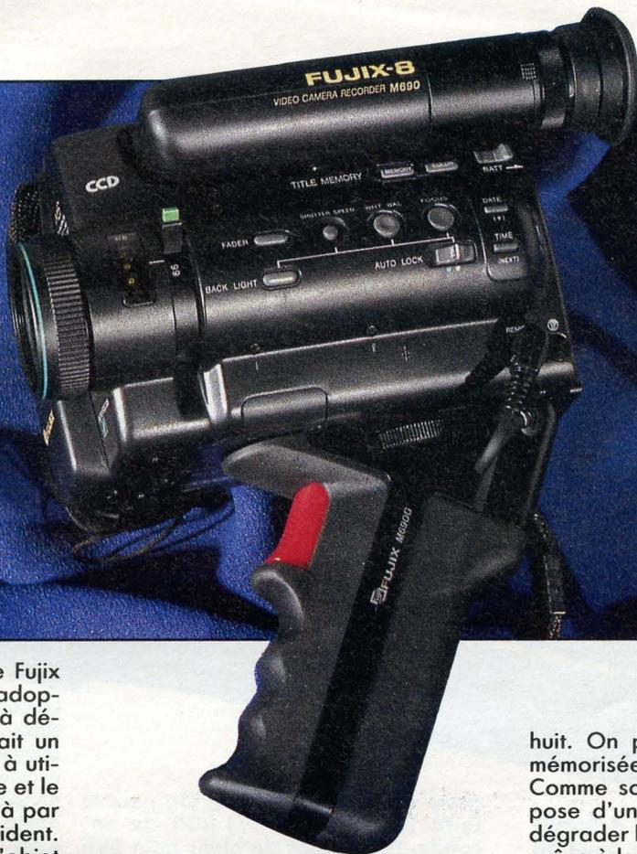
Inspiré d'une base connue, le Fujix M-690 s'en distingue par l'adoption en série d'une poignée à déclencheur intégré. Cela en fait un appareil extrêmement agréable à utiliser, quoique la version originale et le M-690 sans poignée brillent déjà par un agrément manipulateur évident. Côté transport, on est gâtés : l'objet affiche 790 grammes sur la balance (sans cassette ni batterie ; avec, compter un petit kilo) et moins de 18 cm de longueur.
