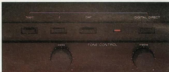
*Luxman : ici, on choisit directement l'entrée numérique, avec le choix de trois entrées dont une optique. C'est l'amplificateur qui s'adaptera automatiquement à la fréquence d'échantillonnage du signal.*
