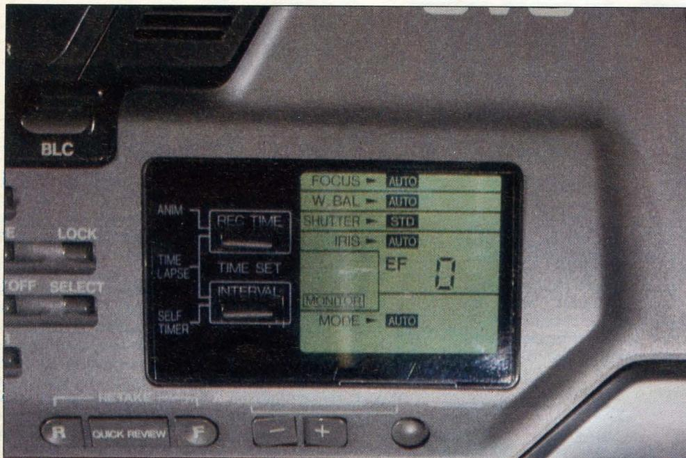
Côté droit d'un caméscope récent : l'afficheur à cristaux liquides précise les paramètres d'exposition en mode manuel (mise au point, balance des blancs, vitesse d'obturation).
