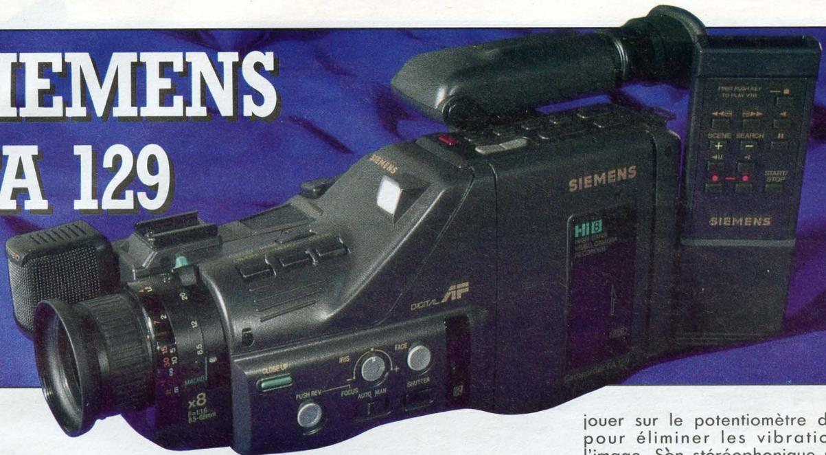
**S**iemens attaque le très haut de gamme avec son FA 129 au standard Vidéo Hi8 : le Hi-Band ! On retrouvera donc une image pratiquement aussi définie que celle que le capteur CCD de 390 000 pixels utiles est capable de lui envoyer. Compatible, il saura également travailler en 8 mm normal.
