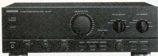
**KA 7010 Amplificateur intégré** 2 x 105 W. BP 5 Hz à 100 KHz DHT 0,005 %. 4 transistors de puissance. Circuits d'implantation à 2 niveaux. Commutateur Source direct. Alimentation surdimensionnée avec double transformateur et enroulements cuivre sans oxygène. Châssis anti-vibratoire.
