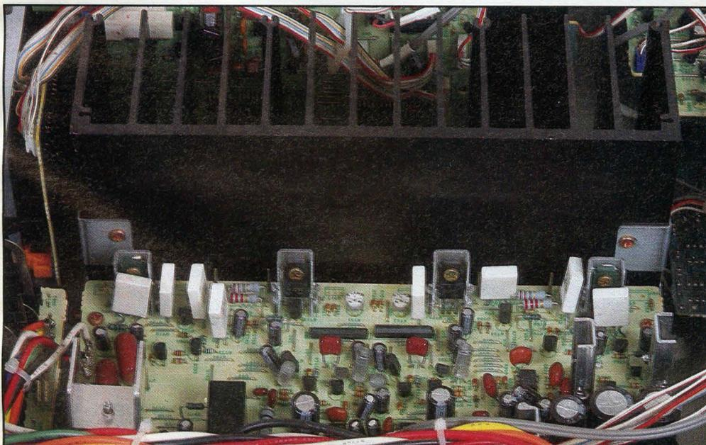
Marantz : l'amplificateur proprement dit, ses transistors sont vissés sur un radiateur anodisé en noir.
