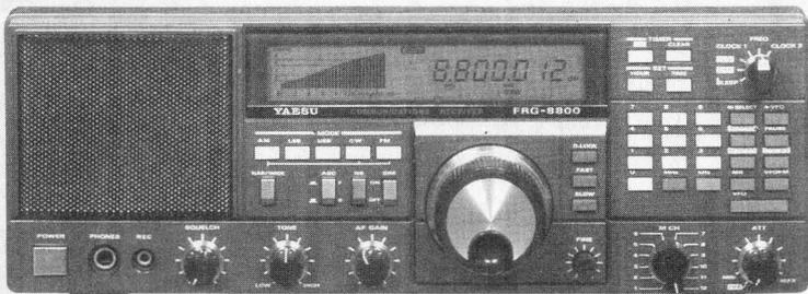
**FRG 8800 – YAESU** – Récepteur décimétrique 100 kHz à 30 MHz en 30 gammes. AM/SSB/CW/FM. Entièrement synthétisé. 12 mémoires. Programmation des fréquences. Alim. 220 V. Dimensions : 334 x 118 x 225 mm.
