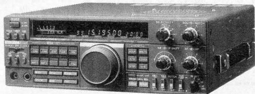
**R-5000 – KENWOOD** – Récepteur décimétrique de 100 kHz à 30 MHz en 30 bandes. Option de 108 à 174 MHz. Dynamique 102 dB. 2 VFO au pas de 10 Hz. SSB/CW/FM/AM. 100 mémoires. Scanning bandes et mémoires. Deux horloges et chronorupteur. Interface micro-ordinateur en option. Commutateur CAG. Atténuateur HF. Alim. 220 V/13,8 V en option. Dimensions : 270 x 96 x 270 mm.
