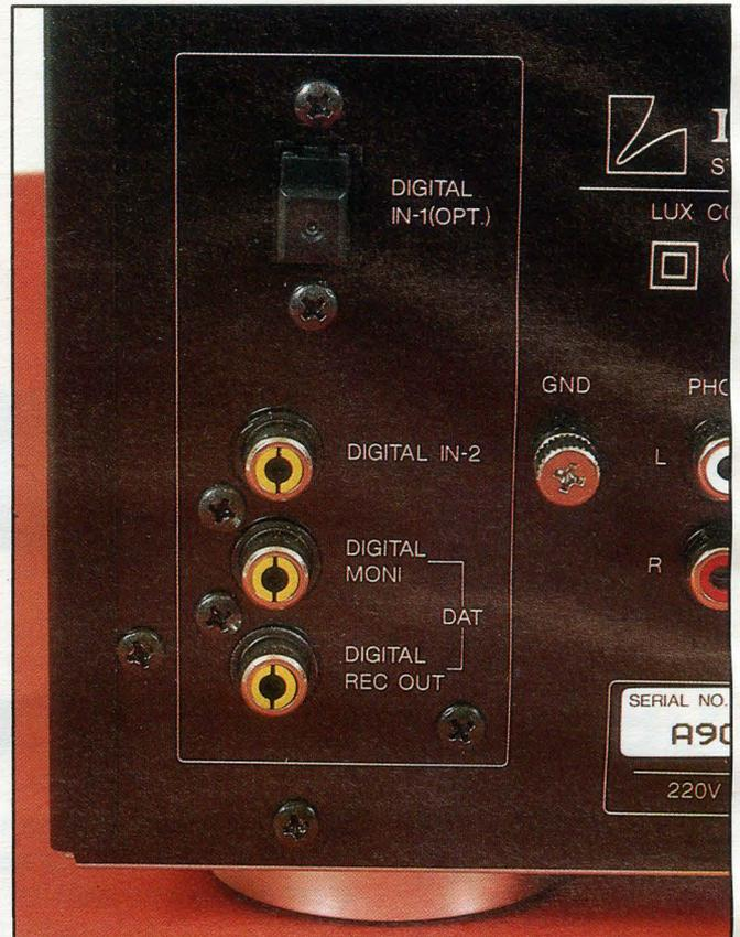
Luxman : la collection des prises d'entrée numérique, en haut, optique, en bas, coaxiale. On remarquera une prise de sortie pour le contrôle du signal du DAT.
