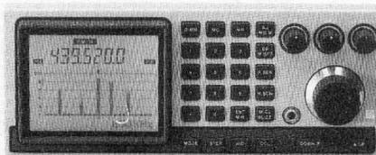
**AX-700 – STANDARD** – Récepteur scanner 60 à 905 MHz en continu. NBFM/AM/WFM. Panoramique 100/250/1000 kHz. 100 mémoires. Alim. 12 V.
