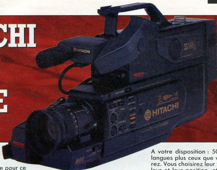
**S**-VHS et grande cassette pour ce camescope d'épaule que nous propose Hitachi, l'oreille droite vient se poser sur un mini-haut-parleur de contrôle, ce qui n'empêche pas la présence d'une sortie pour écouteur ou casque. Le viseur se déplace latéralement sur deux rails télescopiques, il s'oriente sur 135° afin de satisfaire la majorité des besoins. Une poignée surmonte le tout et facilite le transport : l'appareil est assez lourd : 2,8 kg.
