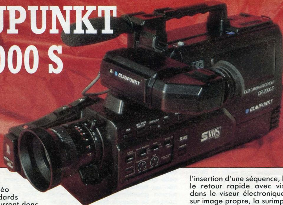
**L**e camescope Blaupunkt CR 2000 S utilise des cassettes vidéo de dimensions standards au format S-VHS ; elles pourront donc être lues directement sur un magnétoscope de salon, à condition que ce dernier soit lui aussi au format S-VHS et qu'il accepte les cassettes vidéo PAL, la quasi-totalité des camescopes S-VHS actuellement commercialisés dans notre pays répondent à cette norme.
