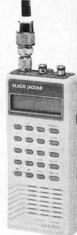
**MVT-5000 – YUPITERU** – Récepteur scanner portable. Fréquences : 25-550 MHz FM/AM au pas de 5, 10, 12,5 kHz, 800-1300 MHz FM au pas de 25, 30 kHz. Sensibilité : FM : 0,5/0,8 µV pour 12 dB SINAD, AM : 1,5 µV pour 10 dB S/N. 100 mémoires canaux, 10 mémoires bandes. Alim. Cad-Ni 4,8 V/12 V ext. Dimensions : 67 x 175 x 40 mm.
