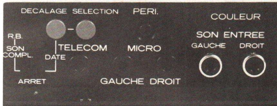
Un petit coin du tableau de branchement avec une prise péri pour déclenchement du passage direct de la vidéo. Les deux boutons circulaires modifient la date.
