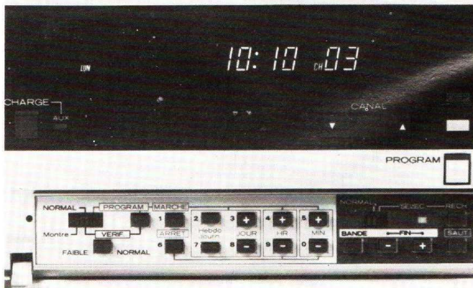
L'afficheur jour, heure et canal reçu allumé.
