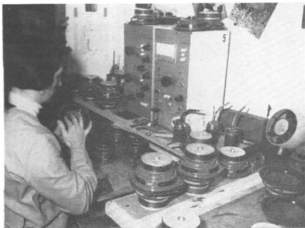
Photo 12. - Une des cabines de contrôle en fin de chaîne. Un générateur spécial adapté à la production.
