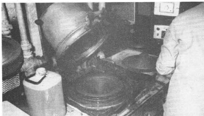
Photo 3. - Le creuset à membrane. L'eau vient d'être évacuée, la pâte est déposée sur une forme poreuse. A droite la presse de séchage.
