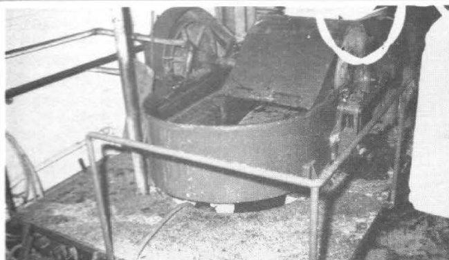
Photo 1. - La première phase de la fabrication de la pâte. Un broyage des constituants additionnés d'une certaine quantité d'eau.
