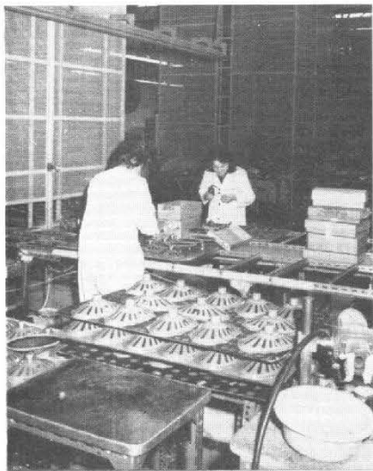
Photo 9. - Le séchage des haut-parleurs se fait sur ces colonnes, un plateau arrive en bas, monte étape par étape, passe sur la colonne suivante pour redescendre, stockage temporaire sur une surface réduite.
