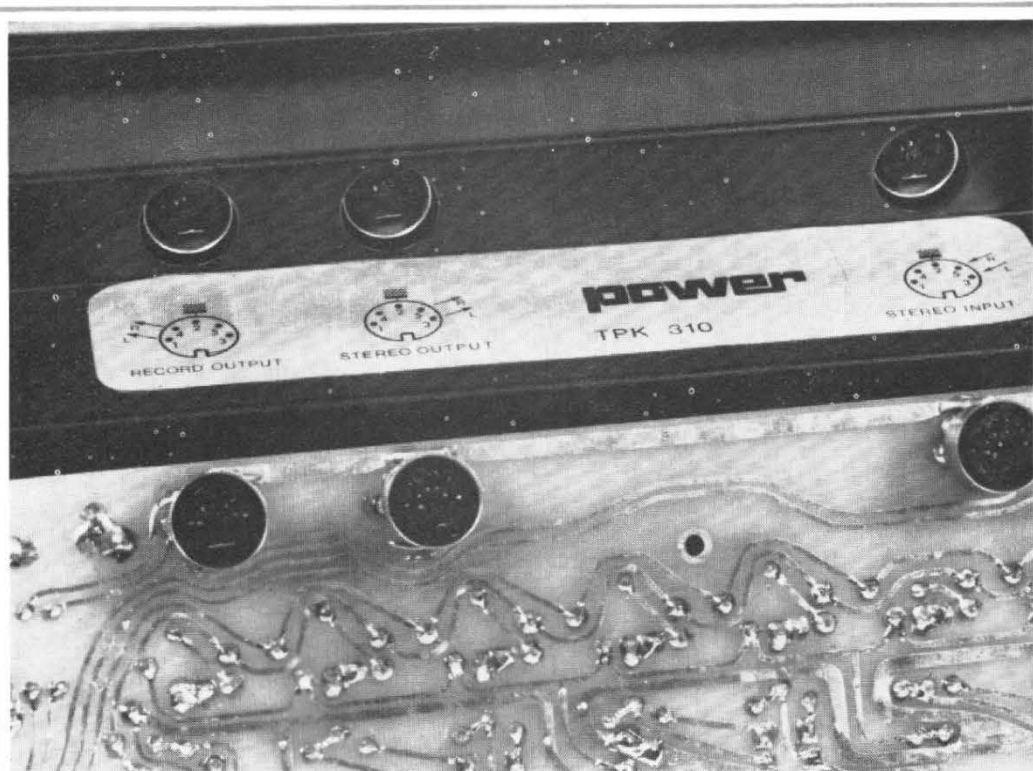
Photo B. - Prises de sortie et leur montage sur le circuit imprimé. Côté cuivre. Une étiquette donne les branchements des correcteurs.
