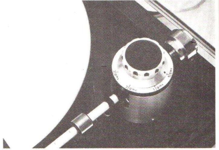
Photo 5. - L'articulation du bras de la BD 3, avec réglage de l'anti-skating de la force d'appui.
