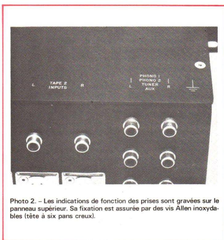
Photo 2. - Les indications de fonction des prises sont gravées sur le panneau supérieur. Sa fixation est assurée par des vis Allen inoxydables (tête à six pans creux).
