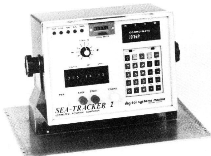
Photo 10. – Le Sea-Tracker est un calculateur de position commercialisé en mai 1976 (document Digital Systems Marine).
