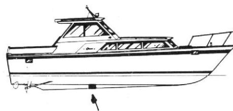
Fig. 3 (a). – Sur voilier, le capteur du loch speedomètre doit être placé le plus en avant possible, mais il ne doit pas se trouver en un endroit où le bateau déjauge : il faut tenir compte de la gîte éventuelle. Les filets d'eau doivent arriver sur le capteur sans tourbillons et sans avoir été freinés par un long trajet au contact de la coque.
