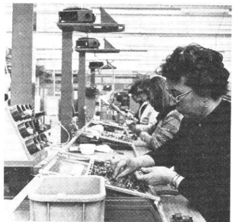
Fig. 2. - Le montage du circuit imprimé : on voit le carrousel de diapositives alimentant le projecteur. L'image est renvoyée sur le plan du circuit imprimé par l'intermédiaire d'un miroir et permet à l'opératrice de connaître à la fois valeur et nombre des composants à placer en des endroits déterminés du circuit imprimé.
