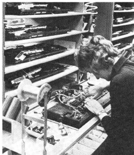
Fig. 4. — L'assemblage du 1900 (circuits sur châssis).
