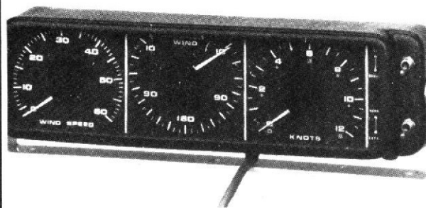
Photo 4. – Au dernier salon de la navigation de plaisance, Navigair présentait son ensemble intégré MT3 loch-speedomètre-girouette et anémomètre. Il comporte des accumulateurs au cadmium-nickel rechargés directement par la rotation permanente de l'anémomètre de tête de mât.
