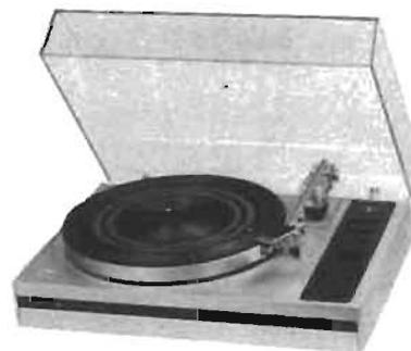
**La platine PHILIPS GA 209S.** Caractéristiques : tourne disques GC 009. Plateau 290 mm (acier). Vitesses 33 1/3 et 45 tours/mn. Réglage des vitesses  $\pm$  3 %. Dérive  $\leq$  0,2 %. Pleurage et scintillement  $\leq$  0,08 %. Rumble DIN A :
