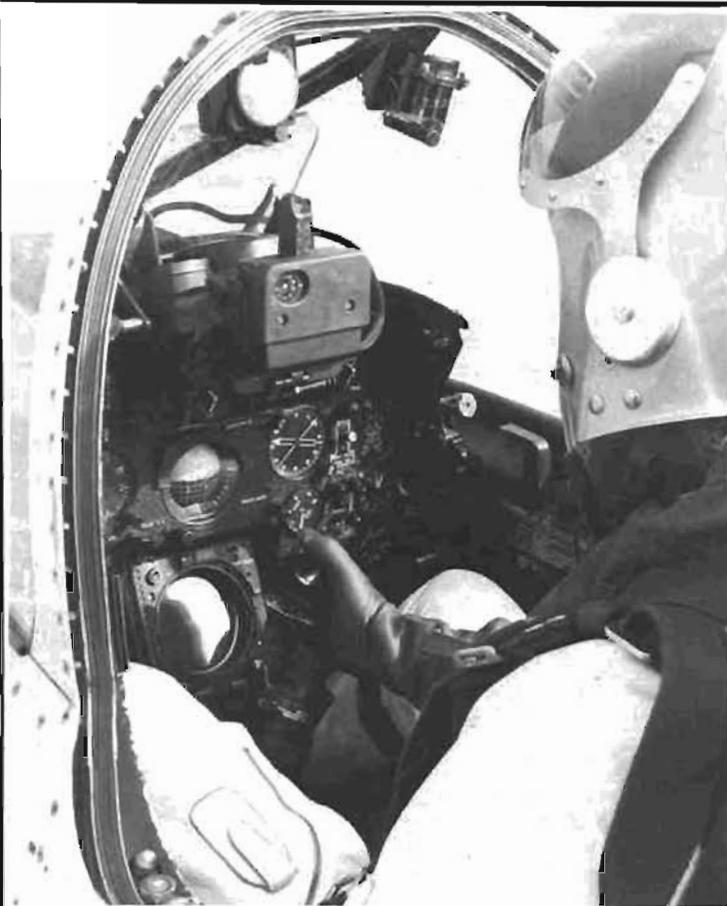
Photo 1. — Dans le cockpit de ce mirage on aperçoit en bas à gauche l'écran du radar « CYRANO » Thomson CSF.
