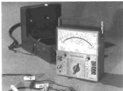
100 M $\Omega$  et un premier calibre de 1,5 mV. Cette sensibilité et la possibilité de décaler le zéro permettent d'utiliser l'appareil en détecteur de zéro avec sensibilité 20  $\mu$ V ou 1nA par division.
