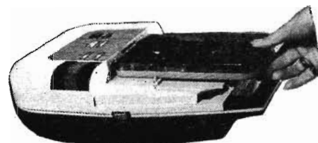
Fig. 8. — Projecteur sonore original à cassette et à bobines (Tadié)
