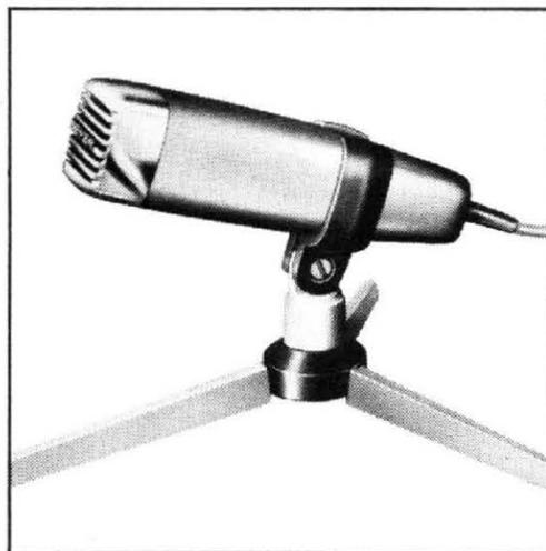
**M 55 HN** - microphone amateur électrodynamique à bobine mobile omnidirectionnel. Boîtier entièrement métallique. Livré avec trépied de table, 2 mètres de câble et transformateur incorporé. Haute et basse impédance : 200, 80 000 ohms - courbe de réponse : 70, 16 000 Hz.
