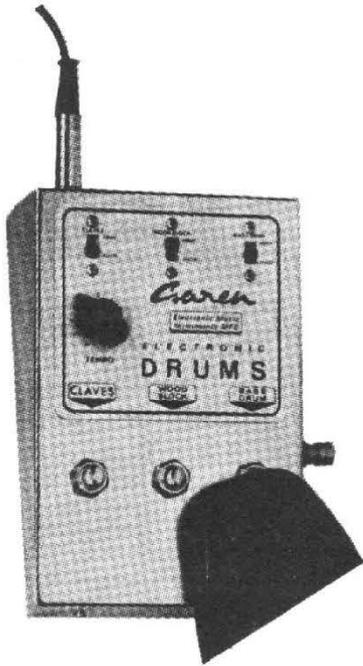
La réalisation Garen. Présentée sous forme de pédale, on aperçoit les 3 boutons de commande au pied de chacun des instruments, les interrupteurs permettent le déclenchement des instruments électroniques par un multivibrateur très basse fréquence dont la fréquence est réglable par le potentiomètre Tempo. À gauche, l'interrupteur de mise en service. L'appareil fonctionne sur piles, la consommation totale ne dépasse pas 10 mA.
