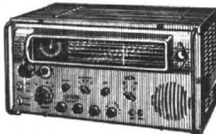
Version moderne des anciens RU 93 et 95 - Gammes 1 : 1,6 à 3,8 Mcs - 2 : 3,5 à 7,5 Mcs - 3 : 7 à 16,6 Mcs - 4 : 16 à 25,5 Mcs - H.F. : R219 - Mélange : 6E8 - Oscillatrice 6J5 - 2MF : 6E8, 6H8 - Détection et BF : 6H8 - Finale : 6M6 - BFO : 6E8 - Valve : 5Y3 - Indicateur : EM34 - Stabilisateur HT : 2 x 4687 - Limiteur : 6H6.
