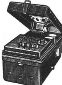
4 fréquences préreglées de 2 à 6 Mcs TUBES UTILISES 1N5 - 155 - 3 x 1T4 - 2 x 354 ALIMENTATION batterie 12 V Livré avec tube, mais sans batterie ..... 38,00
