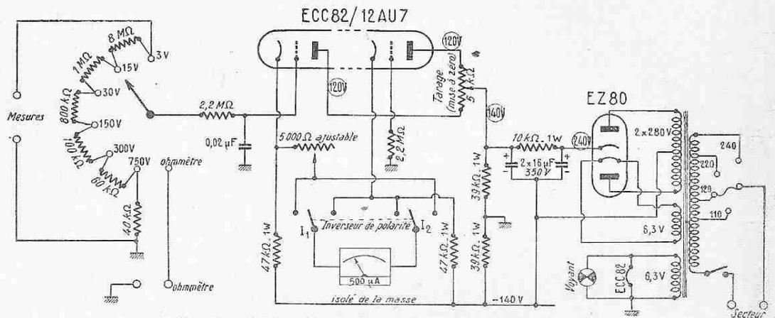
FIG. 1. — Schéma de principe du voltmètre électronique VE.6.
