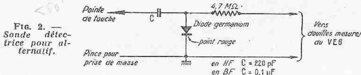
FIG. 2. — Sonde détectrice pour alternatif.
