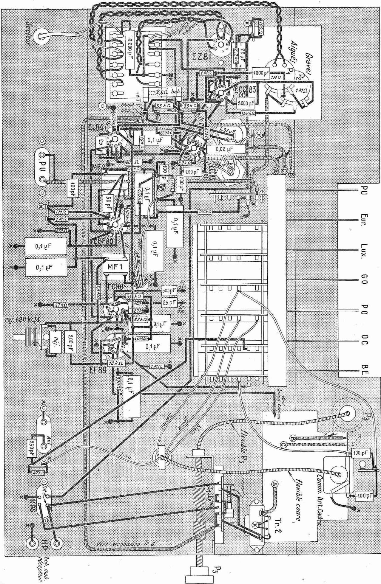
cepteur est relié à la bobine mobile du haut-parleur principal du récepteur et à celle du haut-parleur supplémentaire disposé dans une autre pièce de l'appartement. Il est possible d'effectuer une liaison de plus de 50 mètres. Un support de bouchon à 4 broches, disposé à l'arrière du récepteur permet cette liaison. Le fil à utiliser peut être du fil torsadé lumière 9/10°.
