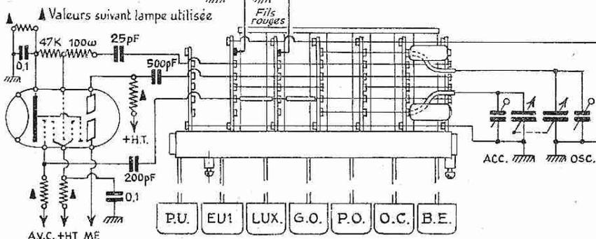
Lorsque l'on appuie sur ce bouton, le secondaire du transformateur de sortie est relié à la résistance de 100 Ω non découplée, du circuit cathodique commun des trois parties triodes ECC83. Le sens de branchement est tel qu'il y a réaction et non contre-réaction. Il en résulte un accrochage audible, ce qui offre la
