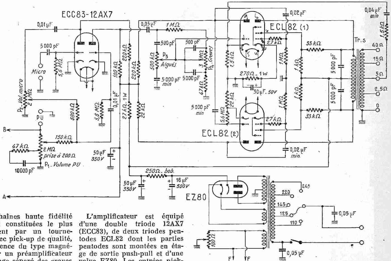
Fig. 1. — Schéma de l'amplificateur sans son préamplificateur.
