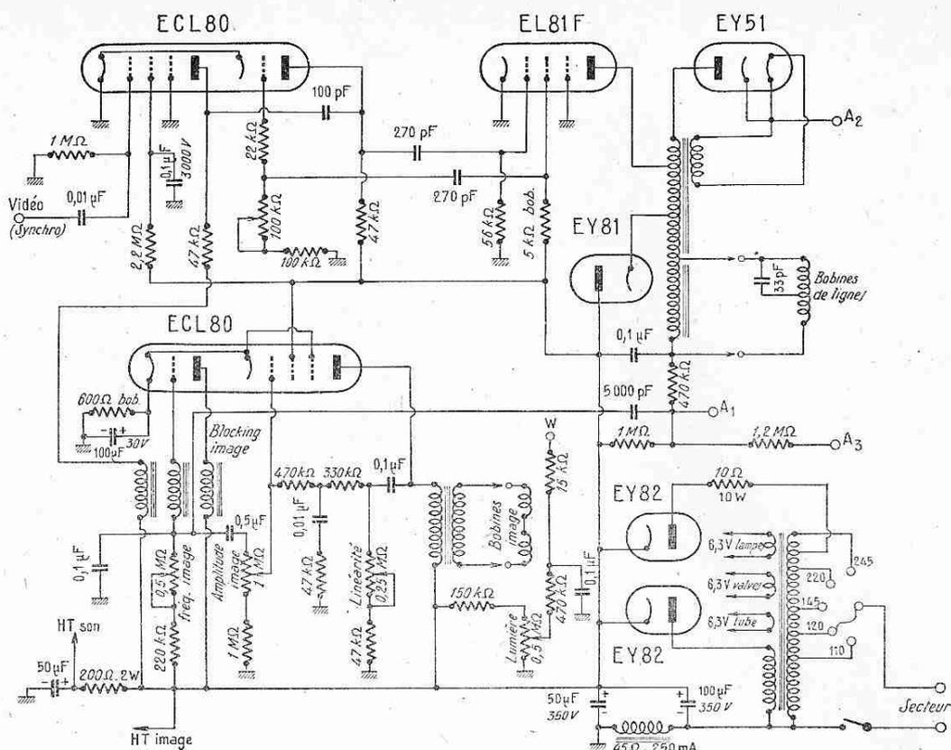
Fig. 2. — Schéma des parties à câbler (bases de temps et alimentations).
