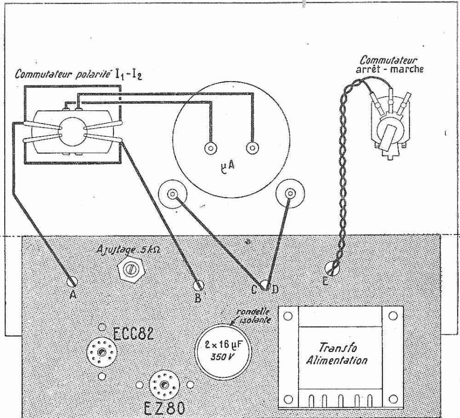
FIG. 3. — Châssis du VE6 vu de dessus.
