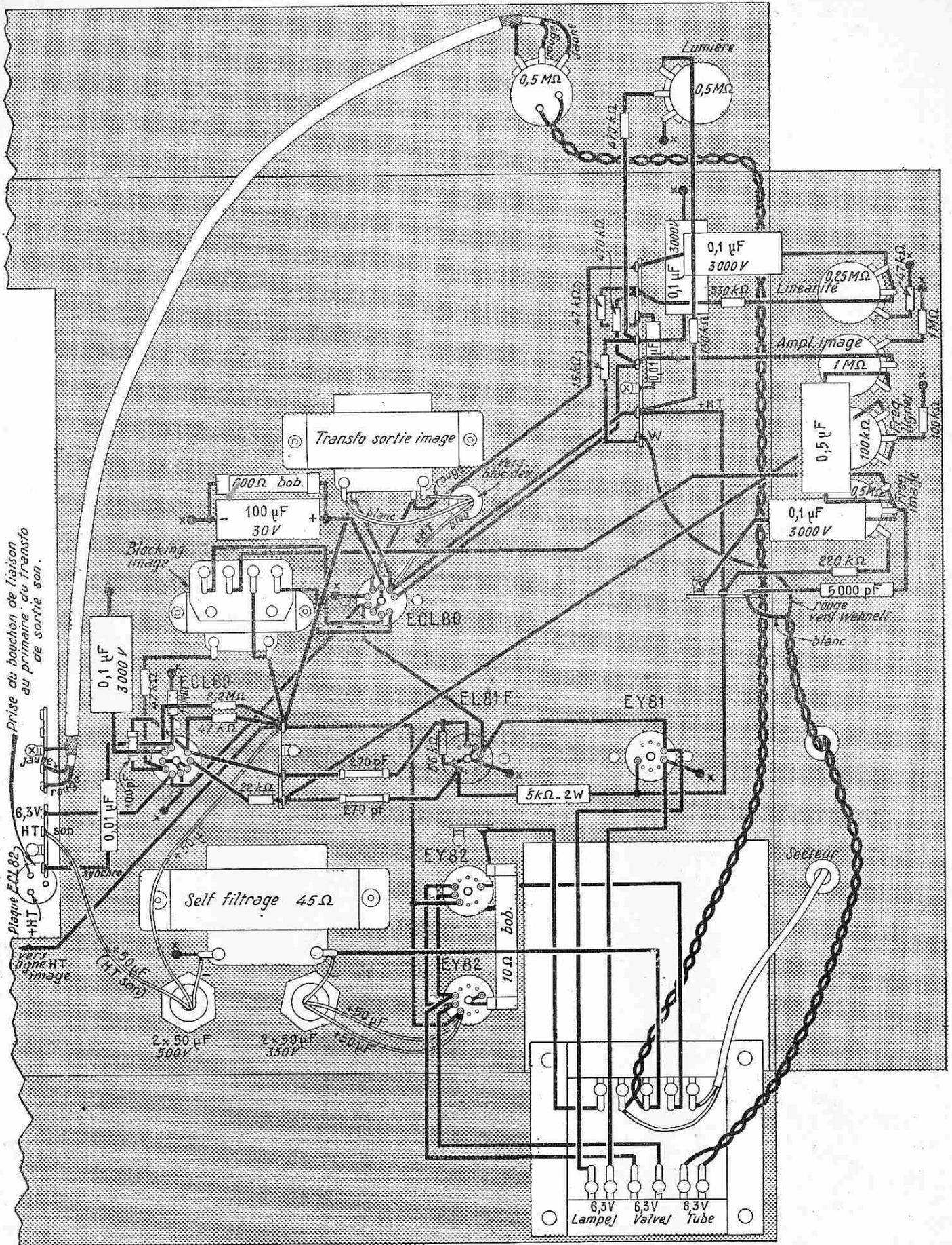
FIG. 3. — Plan de câblage de la partie inférieure du châssis. La platine précâblée disposée à gauche n'est pas représentée.
