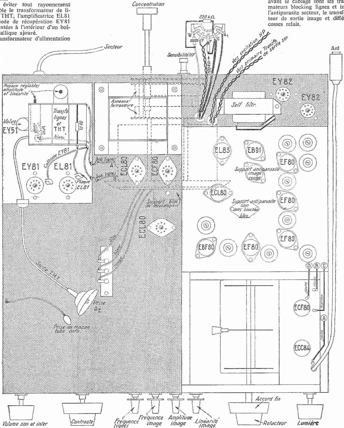
**Liaisons entre le rotacteur et la platine :** Nous avons déjà détaillé en examinant le schéma de principe les liaisons A, B, C, D entre le rotacteur et la platine ou d'autres éléments du montage. Les liaisons sont réalisées sur la partie supérieure de la plaquette à circuits imprimés du rotacteur. Les sorties s'effectuent sur de petites cosses facilement repérables, car la partie supérieure de la plaquette comporte les résistances et condensateurs du schéma de principe de la figure 2.
