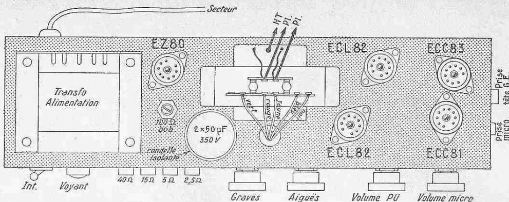
Fig. 4. - Vue de dessus du châssis
