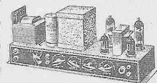
**AMPLI HI-FI 8 Watts.** (Description et réalisation dans le n° du 15 octobre). Correction BACKSEN-DALL de plus ou moins 15 DB dans les graves et aigus. Mixage pick et micro par potentiomètre séparé. Adaptation d'impédance de sortie (2,5 - 5 et 15 ohms) par contacteur. Transfo de sortie haute fidélité CEA. Présentation soignée et coffret tôle givrée.
