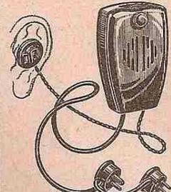
Ensemble très robuste, fonctionne avec une pile 1,5 V et une pile de 30 ou 35 V standard, fabrication Wonder, Leclanché, Mazda. Dim. : 95x60 mm, épaisseur 20 mm. Prix incroyable ..... **6.000**
