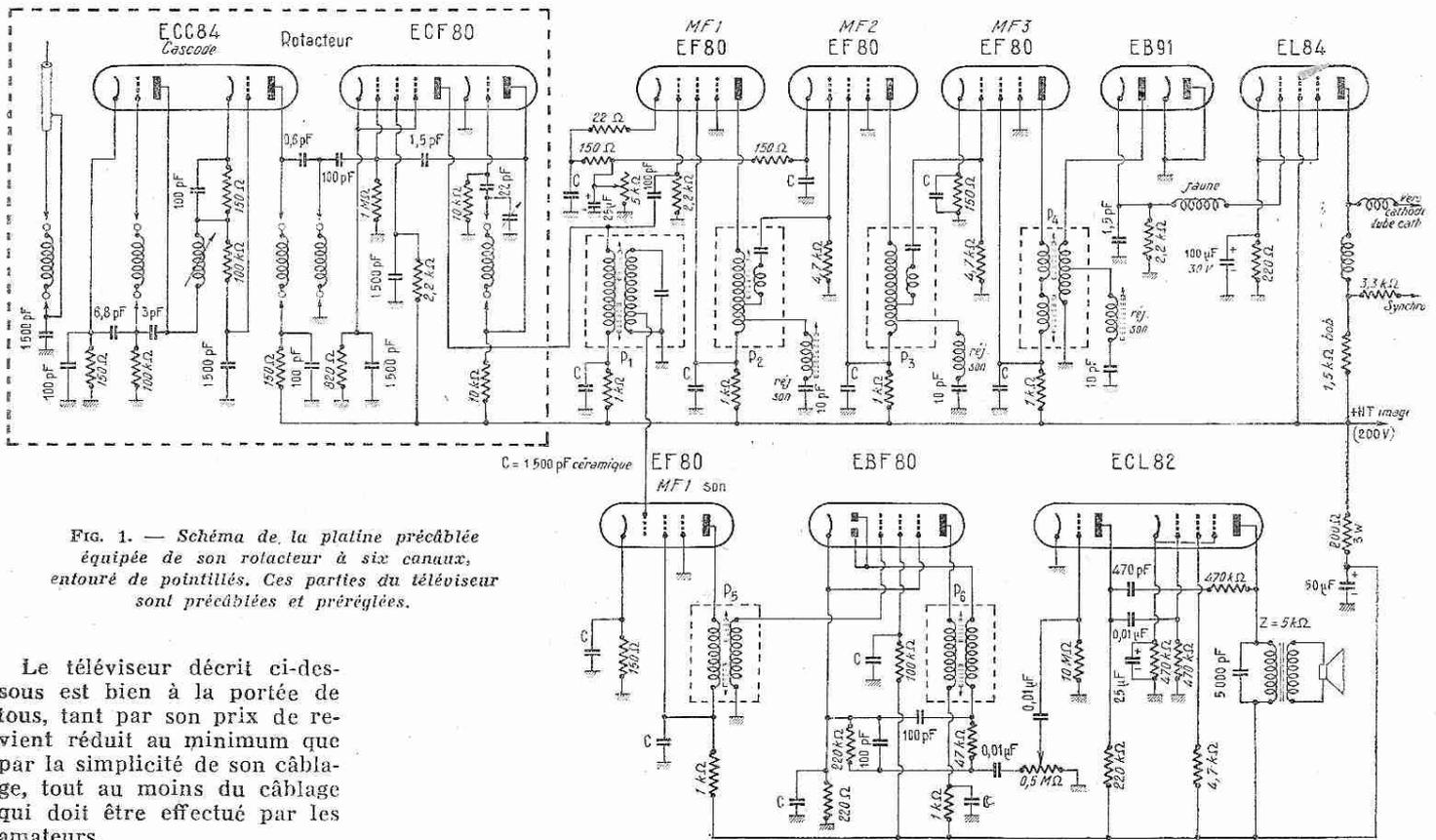
FIG. 1. — Schéma de la platine précâblée équipée de son rotacteur à six canaux, entouré de pointillés. Ces parties du téléviseur sont précâblées et prérégées.
