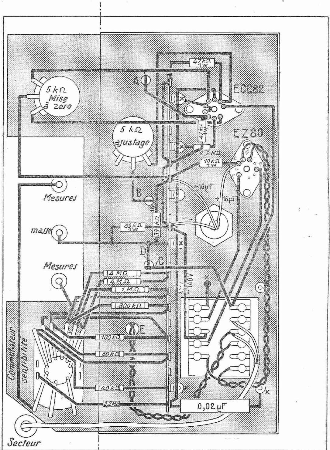
FIG. 4. — Plan de câblage de la partie supérieure du châssis.
