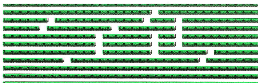
Plaquette perforée au pas de 2,54 mm
