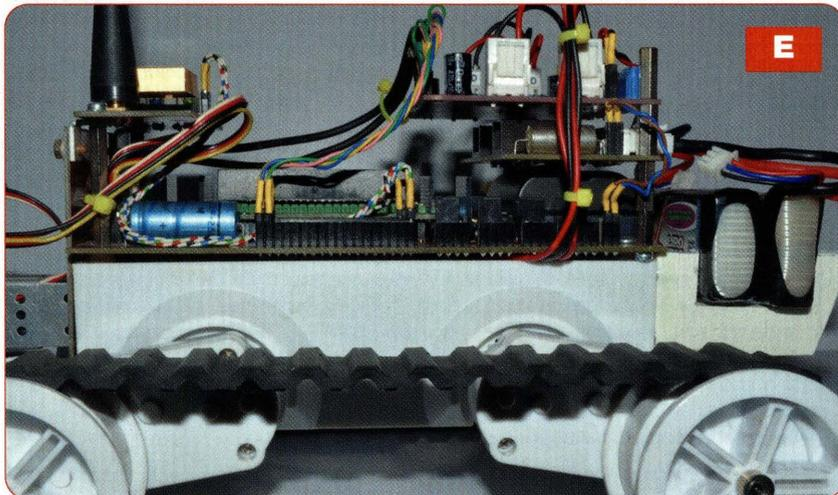
Ensuite, fixer la platine à  $\mu\text{C}$  sur le châssis en utilisant le filetage de deux entretoises (3 mm) du côté connecteurs des servomoteurs et deux vis de 3 mm de diamètre du côté «batterie». Les trous prévus dans le châssis ne sont
