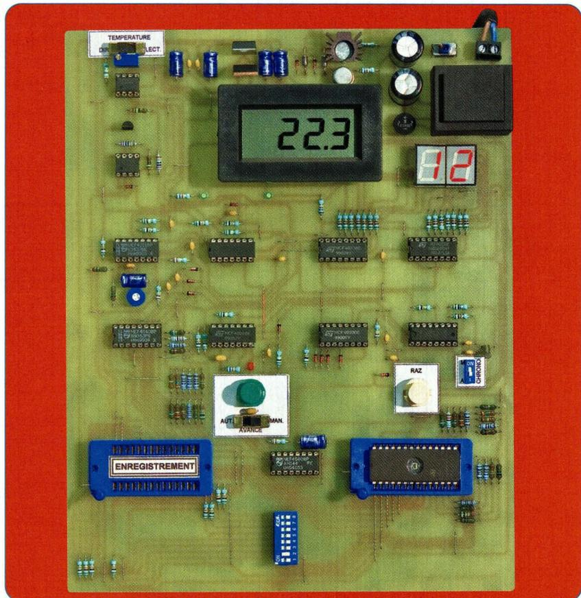
EPROM 27C64 qui requiert respectivement une tension de +5 V et une tension de +13 V (figure 1).
