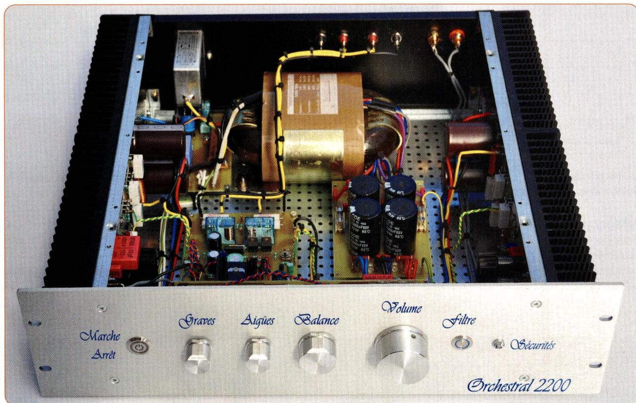
Après vous avoir proposé un amplificateur monophonique pour audiophile de plus de 500 W RMS, nous vous donnons la possibilité de réaliser, selon la même technologie, un amplificateur stéréophonique de forte puissance et de très haute fidélité (2 x 175 W RMS avec une charge de 4  $\Omega$  ou 2 x 103 W RMS avec une charge de 8  $\Omega$ ).
