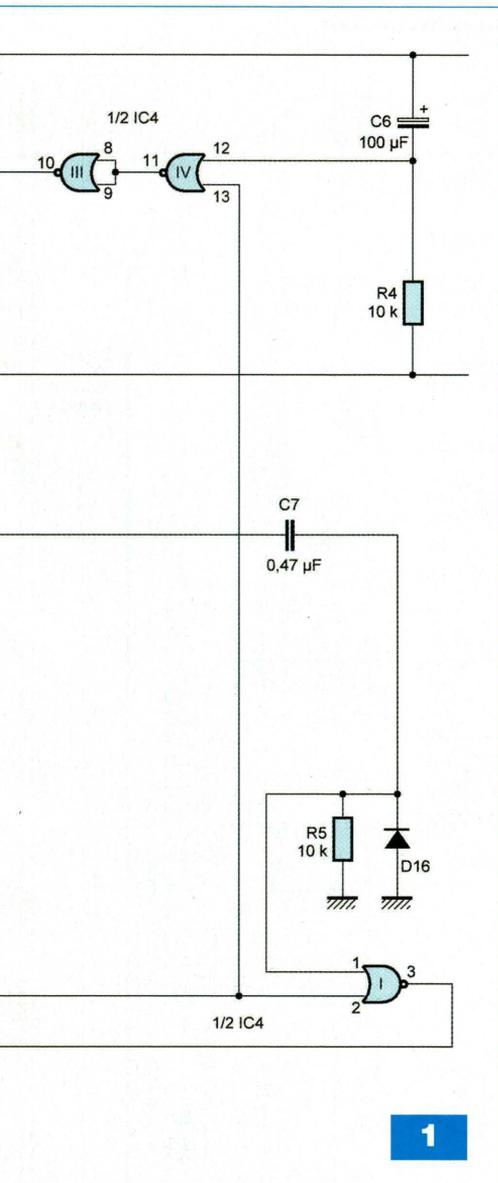
tandis que celle de la porte NOR (III) est à l'état «bas». Cette dernière est en liaison avec l'entrée R (Reset) de IC1, qui est un compteur comportant quatorze étages binaires montés en cascade et précédés d'un oscillateur interne.
