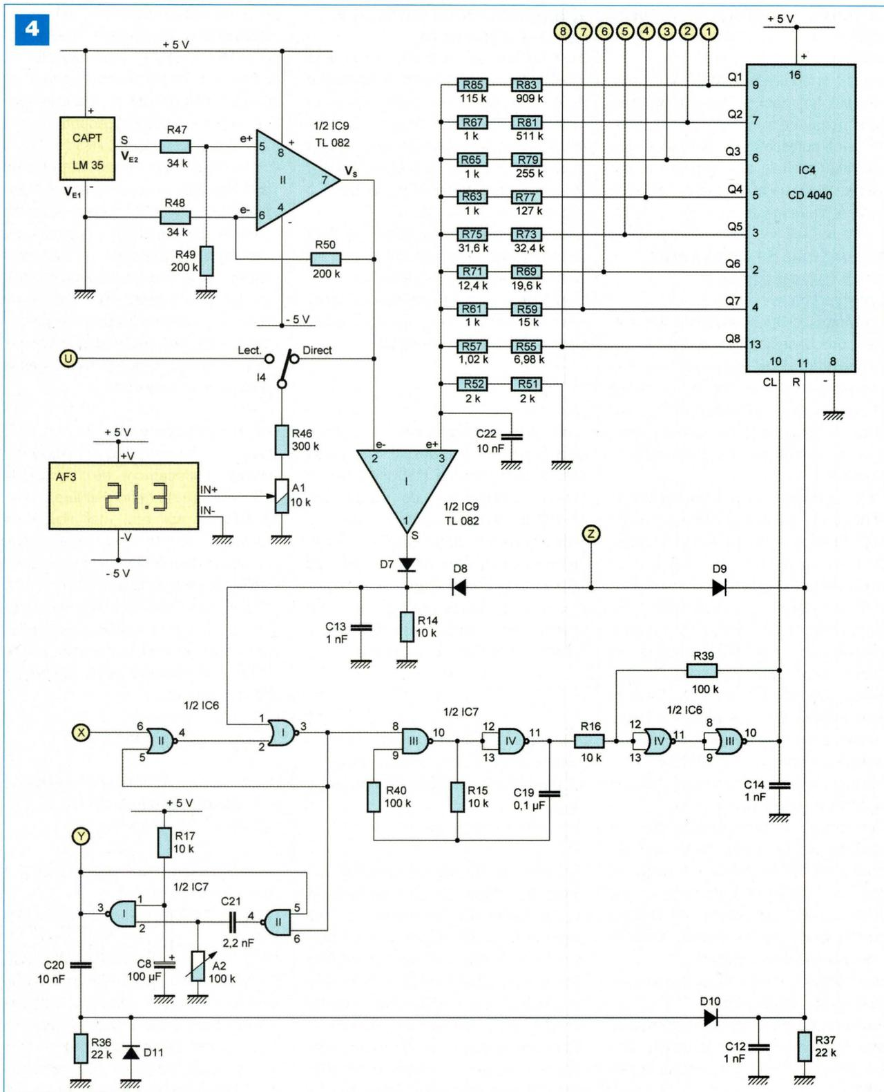
A condition que l'inverseur I4 soit placé sur la position «Direct», cette tension est disponible aux bornes du pont résistif constitué par R46 et l'ajustable A1. Ce dernier permet de prélever une fraction de ce potentiel. Toujours dans le cas de l'exemple évoqué, il sera nécessaire de régler l'ajus-
