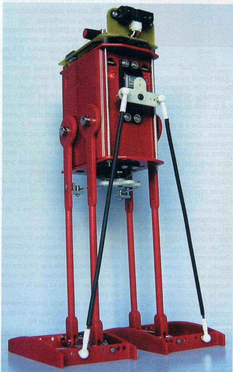
**D**e plus, ce robot est équipé d'un capteur capable de détecter les obstacles à plus de vingt centimètres et de les éviter. Afin de pouvoir expérimenter, effectuer des tests, donner des ordres de comportement et tout simplement pouvoir communiquer avec lui, nous l'avons muni de deux potentiomètres et trois touches.
