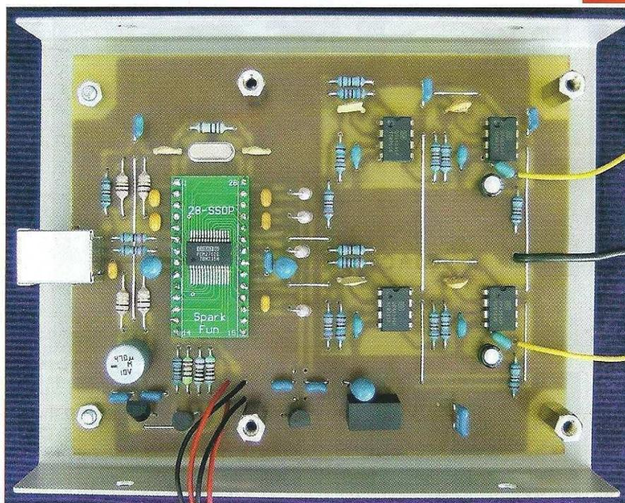
PCM2702 est monté sur une petite carte « interface DIP » à vingt-huit contacts (**photo B**). Cet artefact nous épargne l'opération (oh combien hasardeuse !) du soudage du circuit SSOP dont les pattes de 0,30 mm de large sont espacées de 0,65 mm !
