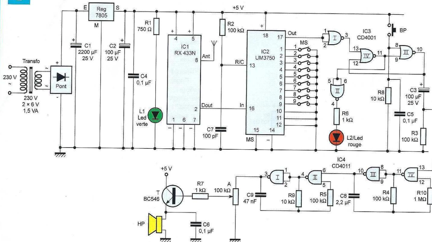
condensateur. Au bout d'une durée de l'ordre de 2 s, elle atteint la valeur de la demi-tension d'alimentation. Le trigger constitué des portes NAND (I) et (II) de IC2, dont la sortie était jusqu'alors à l'état « haut », bascule : sa sortie passe à l'état « bas ».
