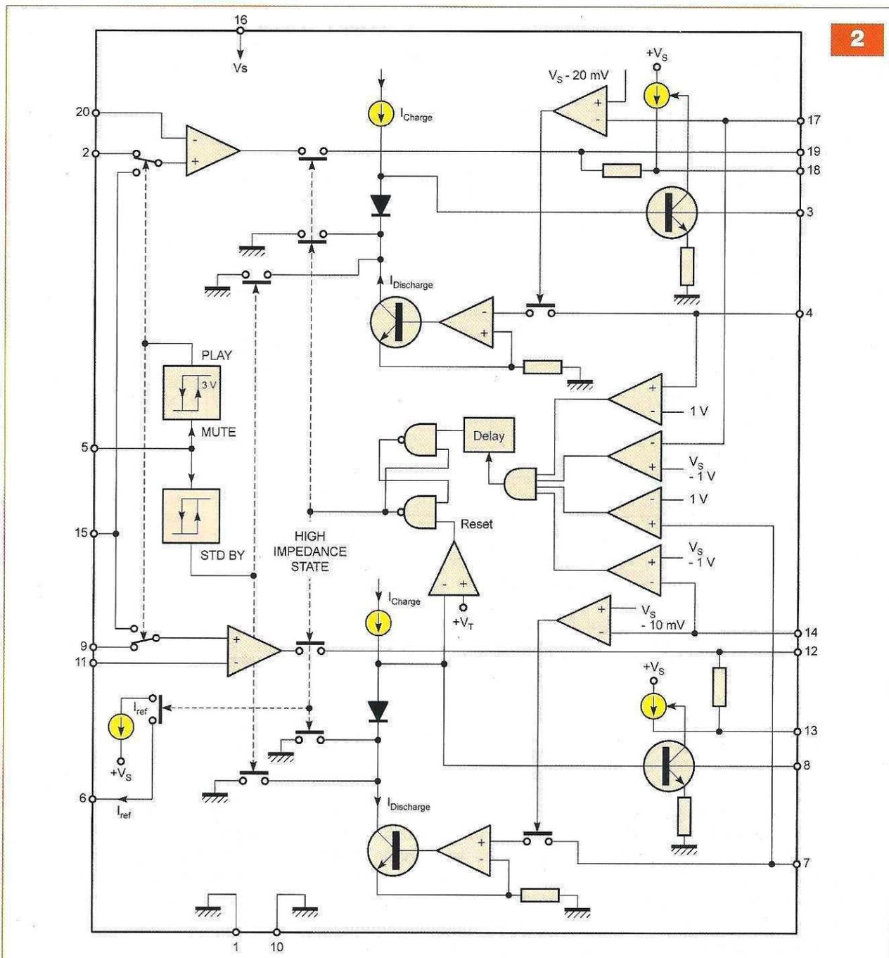
MJ11015 et MJ11016. Il intègre toutes les protections nécessaires ainsi que la mise sous tension en douceur. À nos lecteurs désireux d'entrer dans les détails du fonctionnement, nous proposons le schéma interne du TDA1524A en **figure 1** et celui du TDA7250 en **figure 2**.
