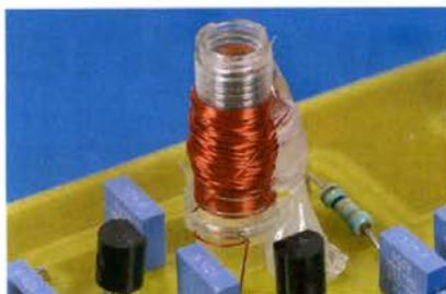
**La bobine L1 est réalisée sur un mandrin de 6,5 mm**
