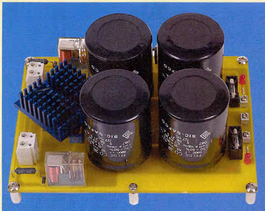
Un module alimentation pour « servir » les deux amplificateurs
