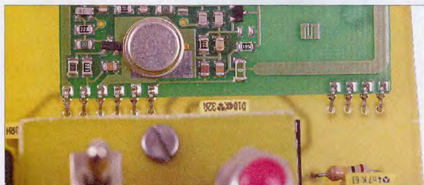
Utilisation d'un module émetteur AM 433 MHz avec antenne intégrée
