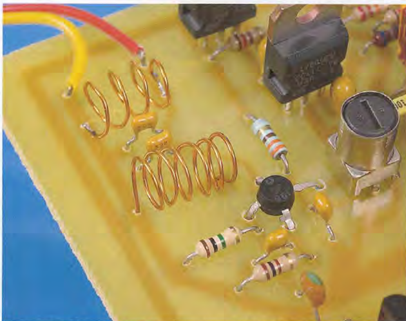
Les bobines L4 et L5 en fil émaillé et le transistor à effet de champ
