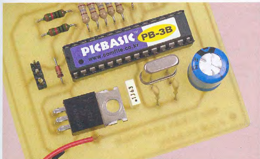
Le montage s'articule autour du PICBASIC PB-3B
