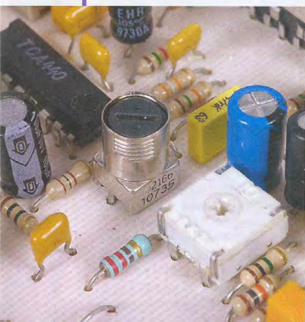
Aspect d'un transformateur FI
