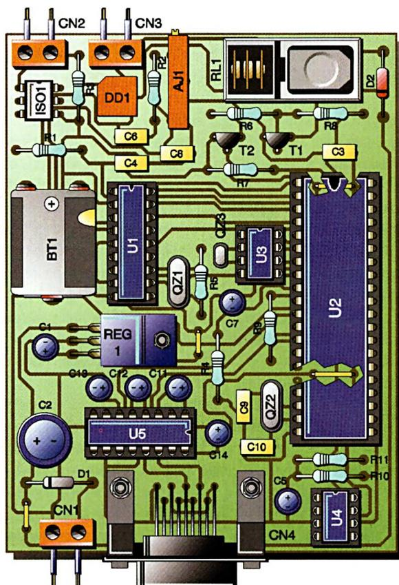
**4** Tracé du circuit imprimé
