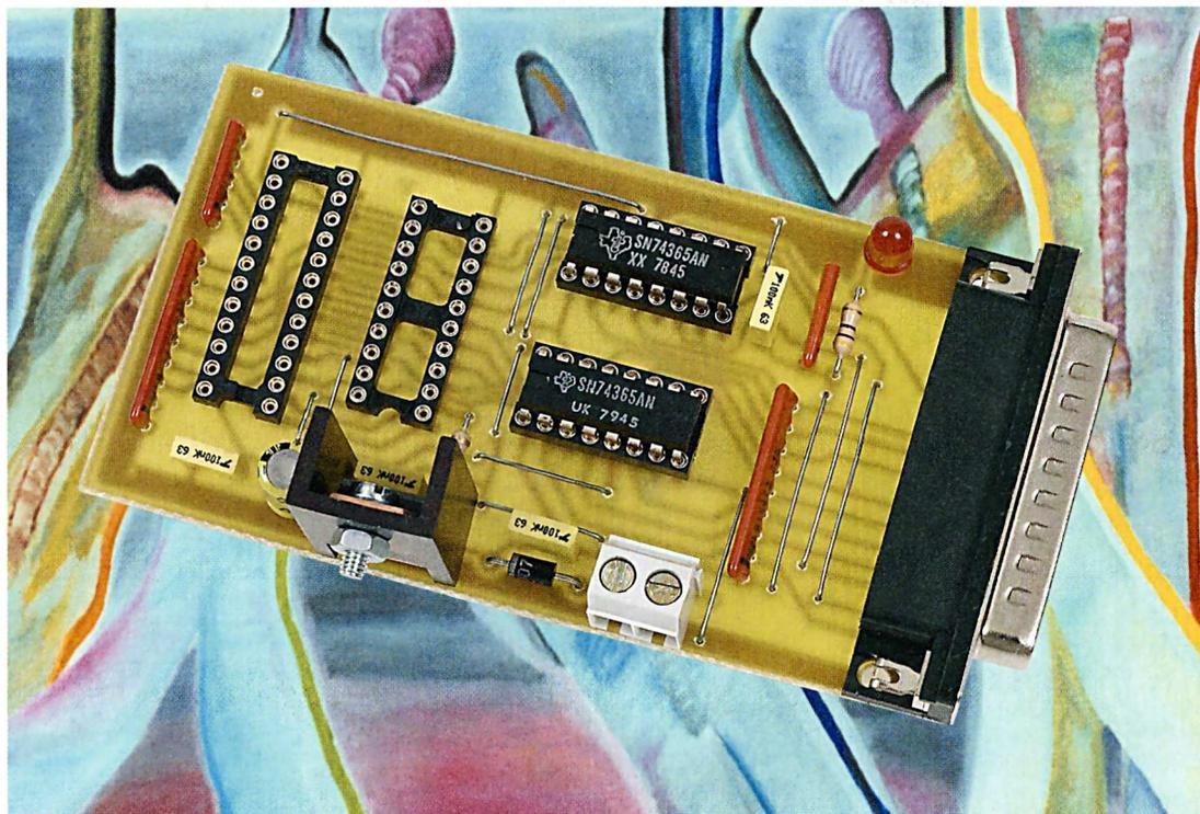
**Les GAL 22V10 et 16V8 en boîtier DIP sont souvent utilisés lorsque l'on a besoin de réaliser un traitement logique relativement simple ne nécessitant pas l'emploi d'un CPLD. Le montage que nous vous proposons ici vous sera d'une grande utilité pour télécharger un fichier de type jedec dans un GAL 22V10 ou 16V8 de chez LATTICE.**
