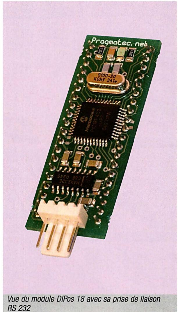
Vue du module DIPos 18 avec sa prise de liaison RS 232
