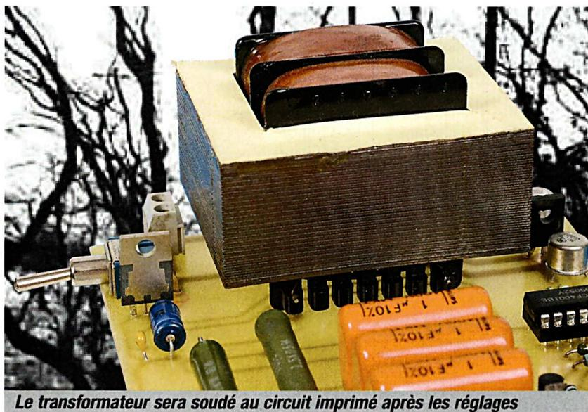
Le transformateur sera soudé au circuit imprimé après les réglages
