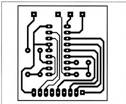
**5** Le circuit imprimé de la version DIP.
