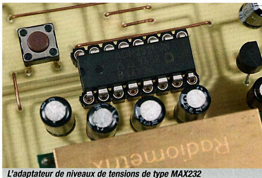
L'adaptateur de niveaux de tensions de type MAX232
