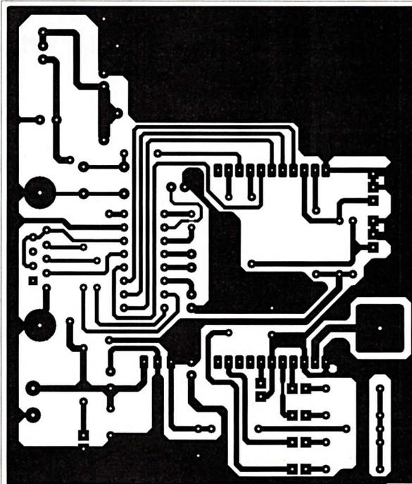
**7** Tracé du circuit imprimé
