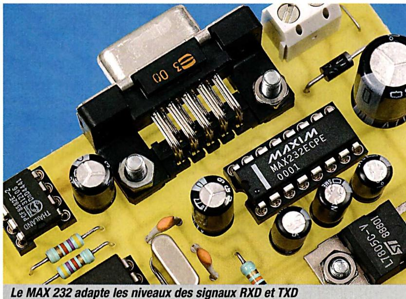
Le MAX 232 adapte les niveaux des signaux RXD et TXD
