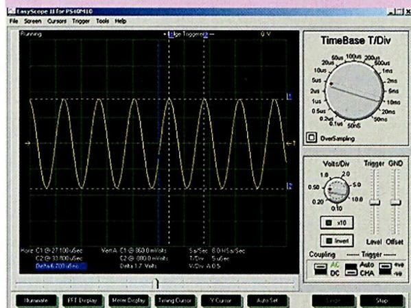
Visualisation sur un écran PC de l'oscilloscope "virtuel" réalisé à partir des logiciels fournis avec l'appareil de mesures DS1M12. L'accès aux différents réglages s'effectue à partir de la souris de l'ordinateur
