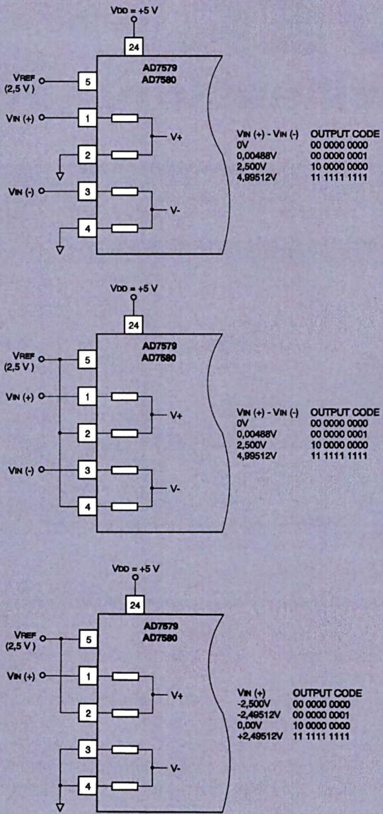
Une particularité doit être signalée : le circuit AD7579 ne disposant que d'un bus de données de huit bits alors qu'il donne un résultat sur dix bits, une fonction supplémentaire lui a été adjointe.
