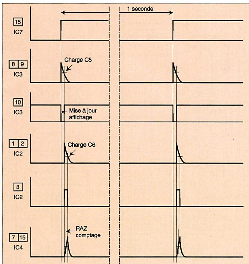
**2** Oscillogrammes caractéristiques (affichage de la fréquence)
