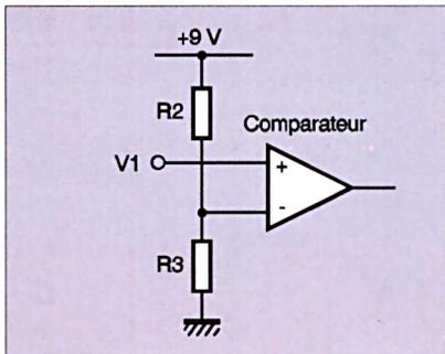
**4a** Un schéma simple avec un pont diviseur
