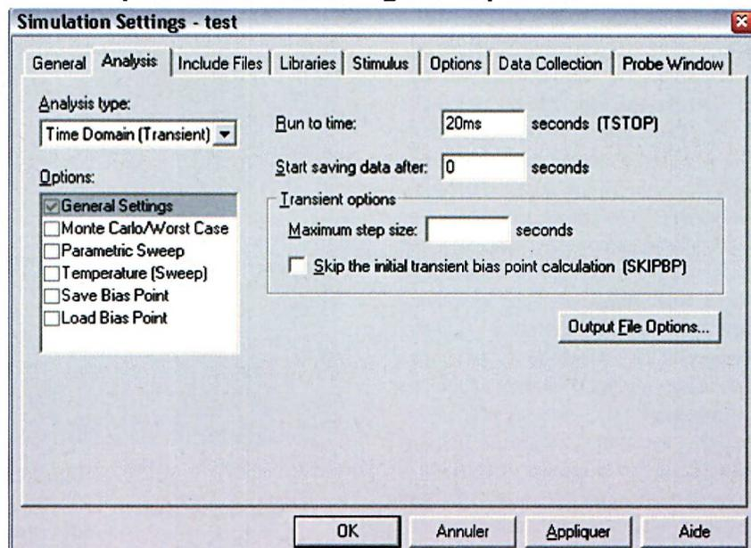
Le profil de simulation sera modifié pour lancer une analyse temporelle comme l'indique la **figure 8** ('Analysis type' = 'Time Domain (Transient)')
