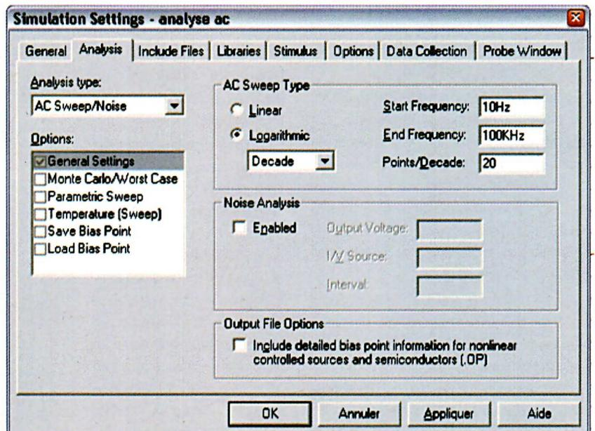
au simulateur d'analyser la réponse fréquentielle de notre montage. Pour se faire choisissez le type de simulation 'AC Sweep/noise' dans la liste déroulante portant le libellé 'Analysis Type'. Le contenu de la boîte de dialogue s'adapte automatiquement pour afficher les paramètres associés au type de l'analyse sélectionnée. Programmez les paramètres comme cela est indiqué sur la figure 4 et cliquez sur le bouton OK.
