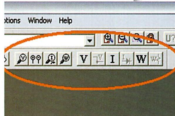
**5** La barre d'outil qui permet de placer des sondes sur le schéma
