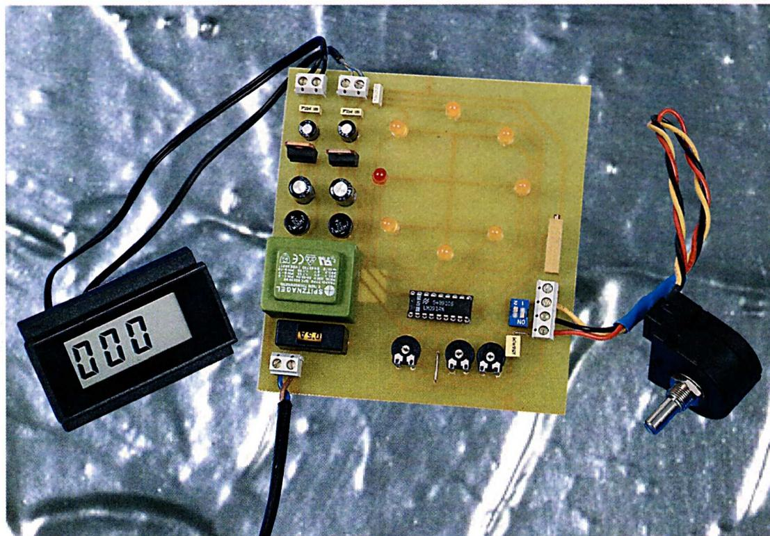
Pour déterminer la position d'un mobile en rotation, on fait souvent appel à un codeur de type incrémental ou mieux encore à un codeur absolu, fiable, mais coûteux. Une autre solution existe, qui exploite le principe du potentiomètre rotatif, bien connu, mais qui souffre malheureusement du grave défaut de ne pas effectuer une course mécanique de 360 degrés, construction oblige. En effet, l'angle de rotation entre deux butées, n'est souvent que de 270 ou 300°.
