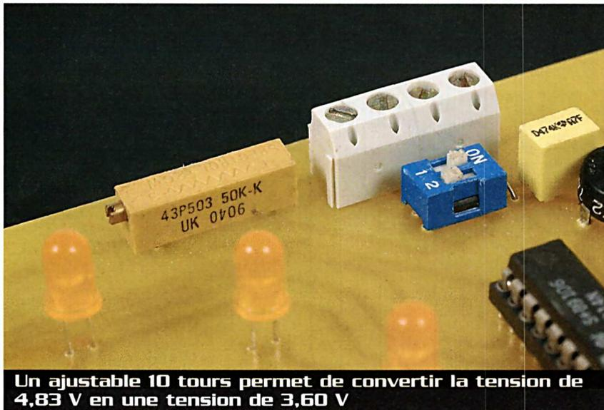
Un ajustable 10 tours permet de convertir la tension de 4,83 V en une tension de 3,60 V
