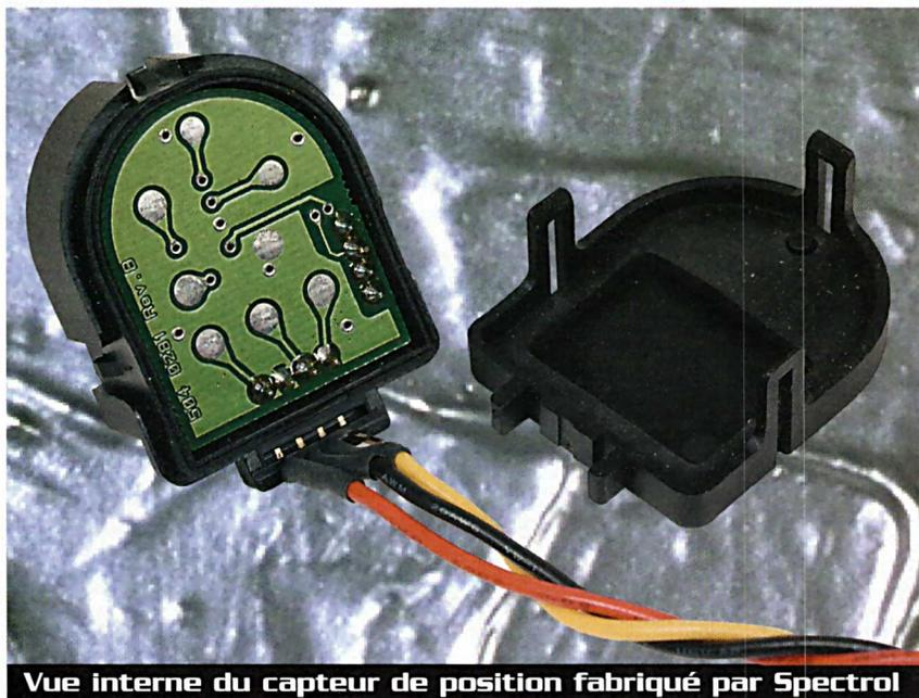
Vue interne du capteur de position fabriqué par Spectrol
