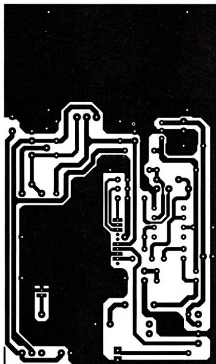
**5** Tracé du circuit imprimé de l'émetteur
