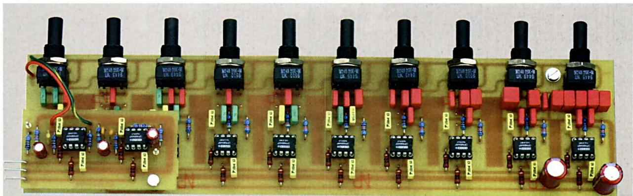
Un correcteur de fréquences de 10 canaux : 32 Hz à 16 kHz
