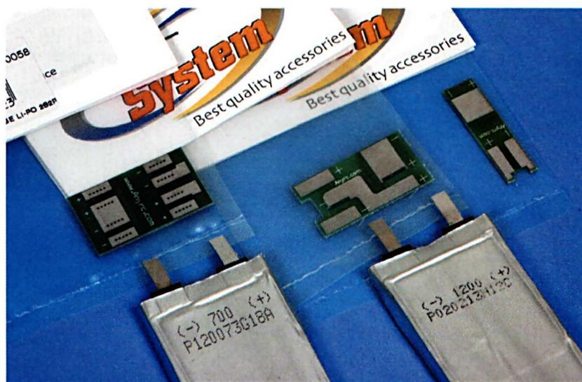
**Si vous achetez des éléments séparés, vous pourrez aussi vous procurer des plaquettes de connexions, circuits imprimés permettant les liaisons séries ou parallèles de plusieurs éléments. Le pas ne change pas avec la capacité de l'accu.**
