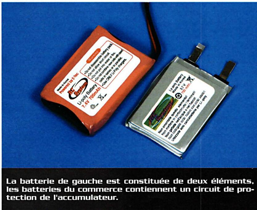
**La batterie de gauche est constituée de deux éléments, les batteries du commerce contiennent un circuit de protection de l'accumulateur.**
