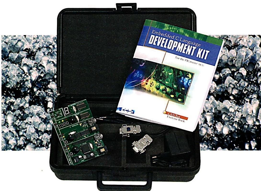
Le kit que nous vous présentons dans ces pages, sous la dénomination 'PIC MCU CAN bus development Kit', associe les microcontrôleurs de Microchip qui possèdent un gestionnaire de protocole CAN intégré avec une carte de démonstration et une interface ICD-S.
