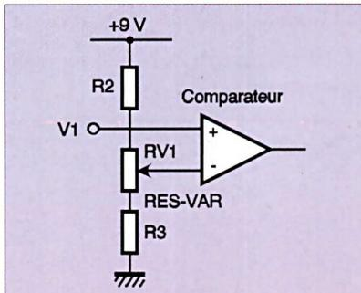
**4b** Ajustage de la tension de basculement avec RV1
